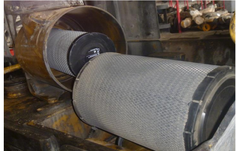
Figura 26: Limpieza de filtro de alta presión
