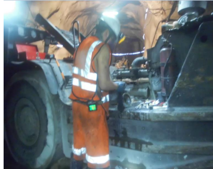
Figura 21: Limpieza del sistema de escape
