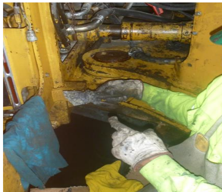
Figura 23: Lubricación de articulación central
