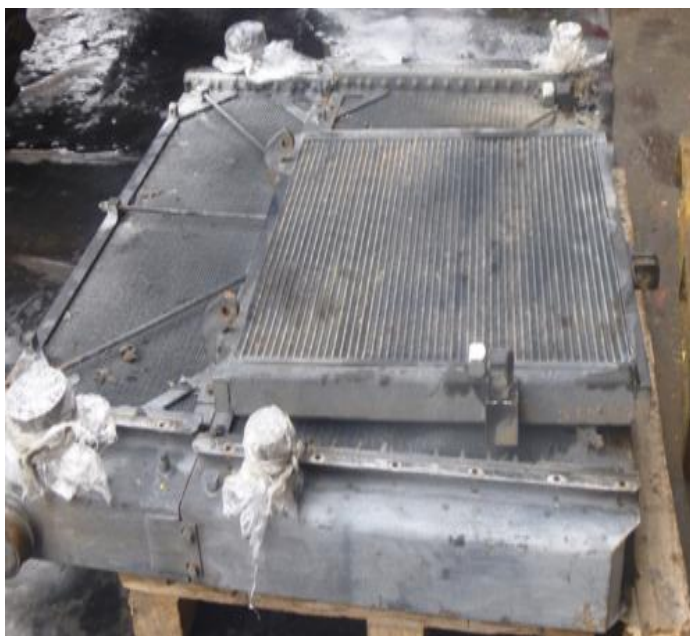
Figura 22: Cambio del radiador
