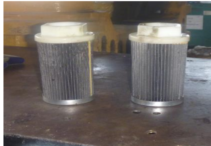
Figura 26: Limpieza de filtro de alta presión
