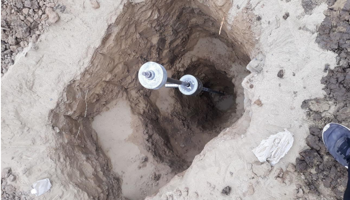
Figura 39: Ensayo de penetración dinámica ligera (DPL).
