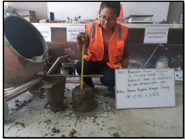
Fotografía N°04.- Vista en fotografía se aprecia las probetas cilíndricas 4"x8" y tomando la medida del slmp.
