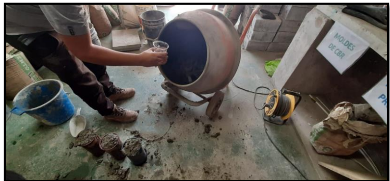
Fotografía N°06.- Vista en fotografía se aprecia la adición de nanosilice a la mezcla de concreto pesado.
