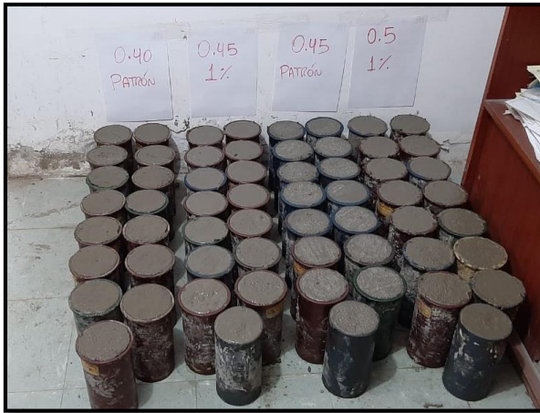
Fotografía N°04.- Vista en fotografía se aprecia las probetas cilíndricas 4"x8" y tomando la medida del slmp.
