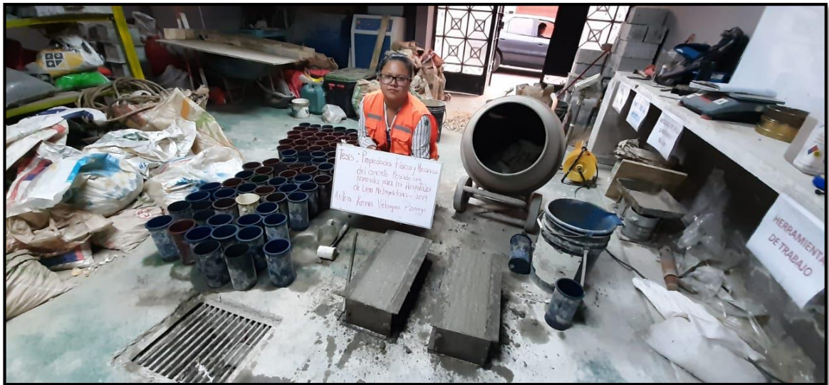
Fotografía N°05.- Vista en fotografía se aprecia las vigas de 0.15x0.15x0.50 m.
