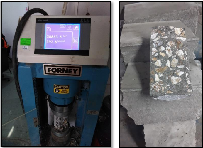
Fotografía N°08.- Vista en fotografía se aprecia la rotura de las probetas cilíndricas 4"x8", ensayo a la compresión y la Rotura a tracción por compresión diametral.
