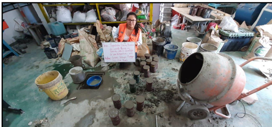
Fotografía N°03.- Vista en fotografía se aprecia la elaboración de las probetas cilíndricas 4”x8”.
