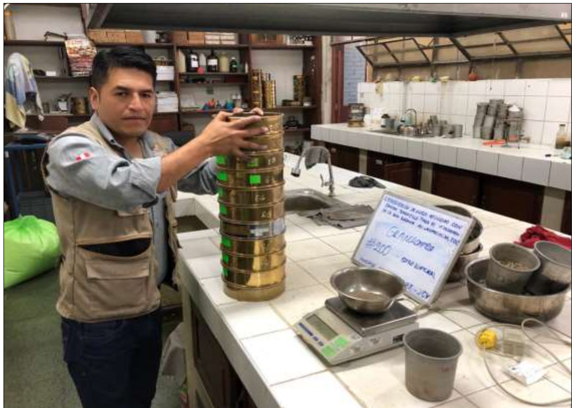
Imagen 22: Tamizado de la muestra CS-02 – análisis granulométrico.
