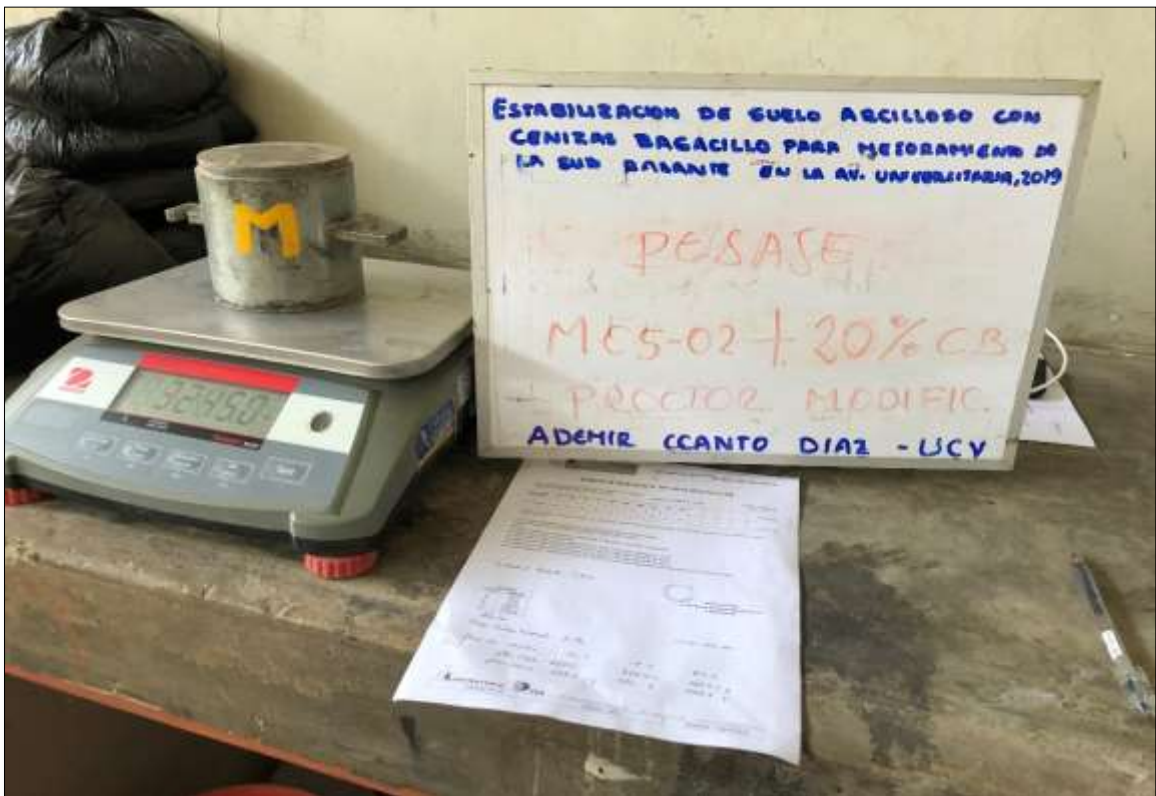
Imagen 46: Probeta compactada Compactación con energía modificada a la muestra de suelo CS-02 + 2% CB.
