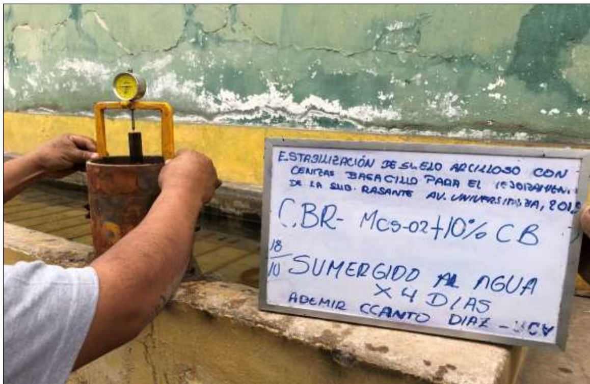
Imagen 56: Probeta compactada del ensayo de CBR de muestra CS-02 + 10 % de CB, sumergida en agua por 4 días.
