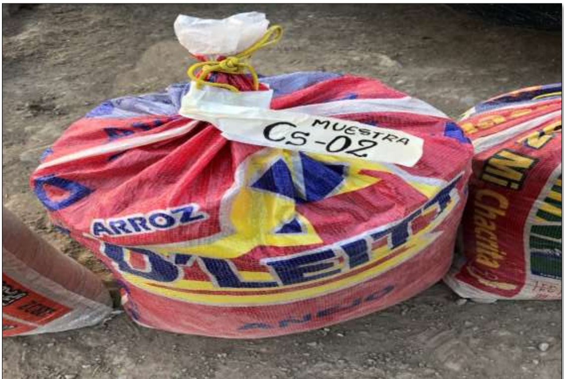
Imagen 12: Recojo de muestra de calicata CS-02 en la progresiva 25 + 000 a 1.50 m. de profundidad.
