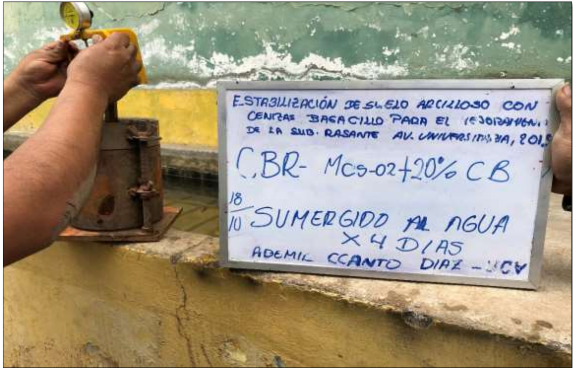
Imagen 65: Probeta compactada del ensayo de CBR de muestra CS-02 + 20 % de CB, sumergida en agua por 4 días.
