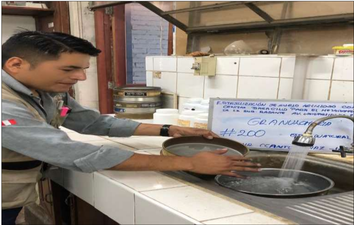
Imagen 23: Lavado de la muestra CS-02 – análisis granulométrico.
