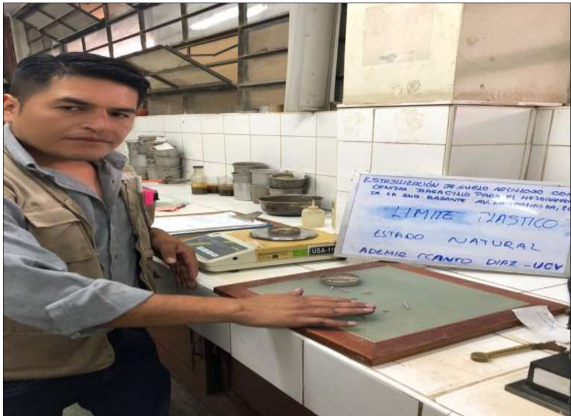
Imagen 28: Ensayo de límites de Atterberg a la muestra de suelo arcilloso CS-02.
