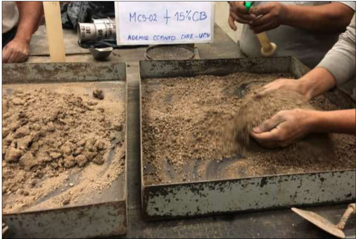
Imagen 57: Ensayo de CBR de la muestra de suelo CS-02 + 15 % Cb.
