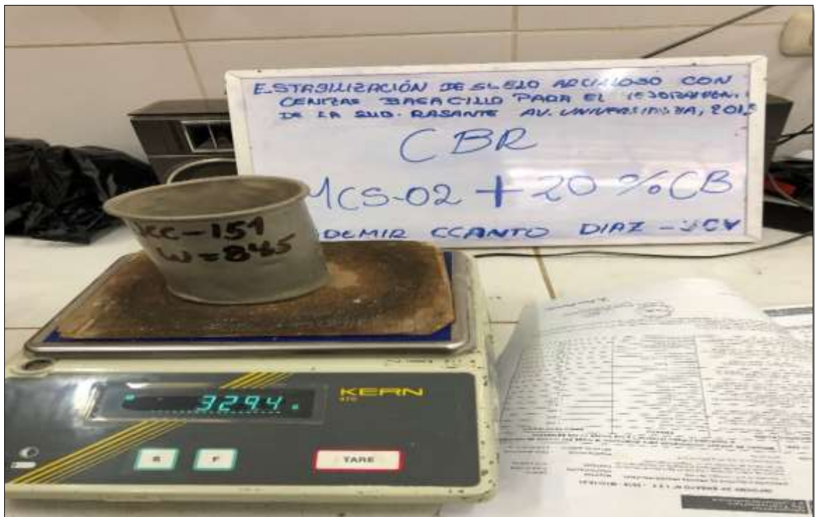
Imagen 62: Muestreo de la probeta para ser llevada al del ensayo de CBR a la muestra de suelo CS-02 + 20 % de CB.
