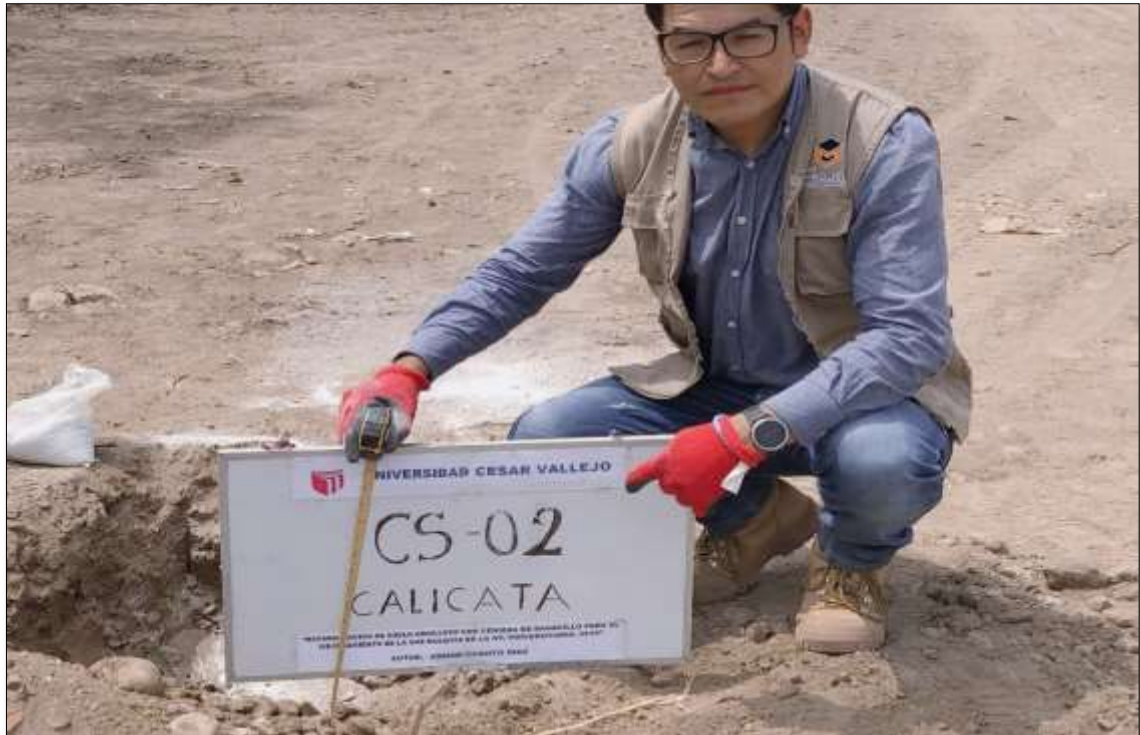
Imagen 11: Ubicación de las calicatas CS-02 en la progresiva 25 + 000 para la toma de muestra de suelo.
