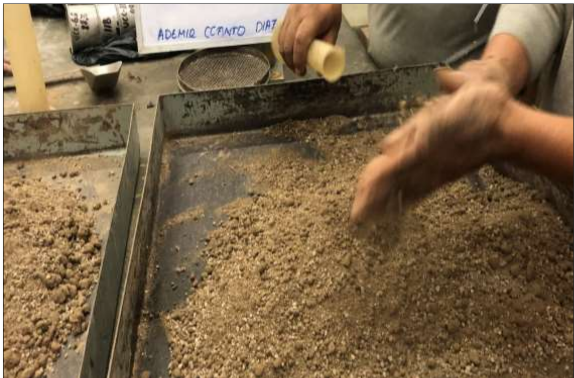
Imagen 30: Preparación de la muestra de suelo CS-02 en estado natural.
