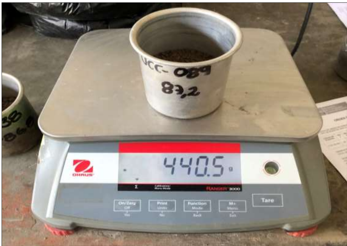
Imagen 50: Muestreo de la probeta para ser llevada al del ensayo de CBR a la muestra de suelo CS-02 en estado natural.
