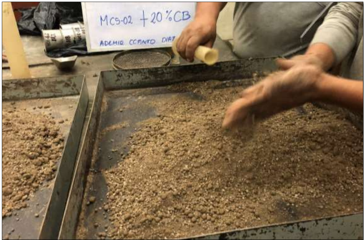
Imagen 61: Ensayo de CBR de la muestra de suelo CS-02 + 20 % Cb.
