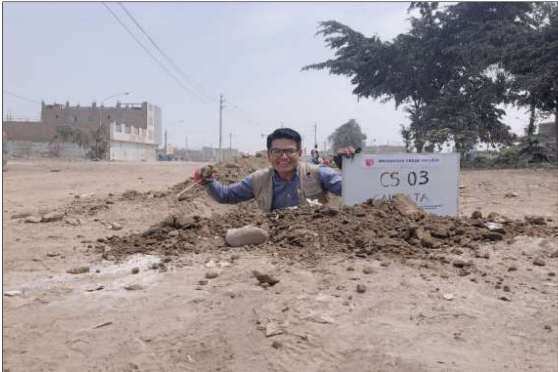
Imagen 15: Ubicación de las calicatas CS-03 en la progresiva 25 + 500 para la toma de muestra de suelo a una profundidad de 1.50 m.
