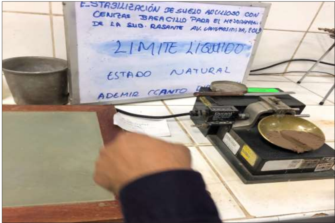
Imagen 27: Ensayo de límites de Atterberg a la muestra de suelo arcilloso CS-02.
