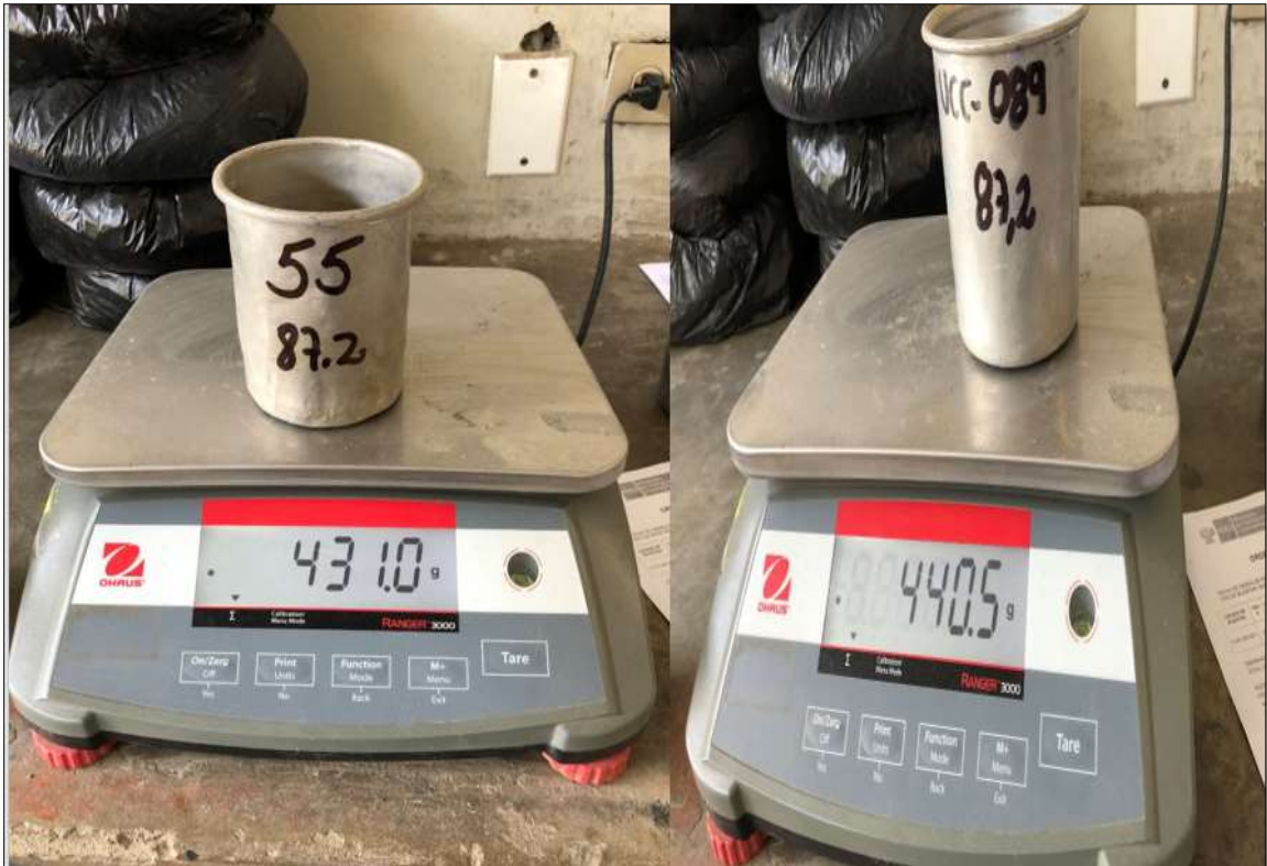
Imagen 33: Muestreo de la probeta para ser llevada al horno sometida a energía modificada a la muestra de suelo CS-02 en estado natural.
