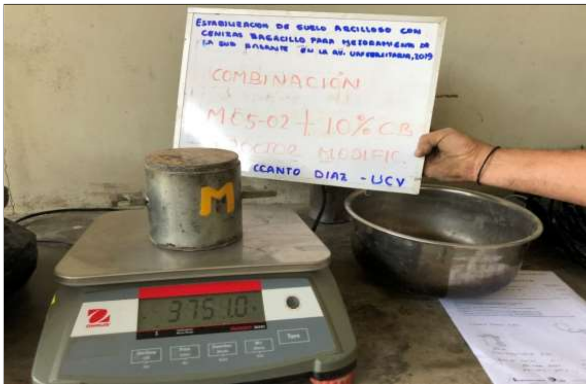
Imagen 36: Probeta compactada Compactación con energía modificada a la muestra de suelo CS-02 + 10% CB.
