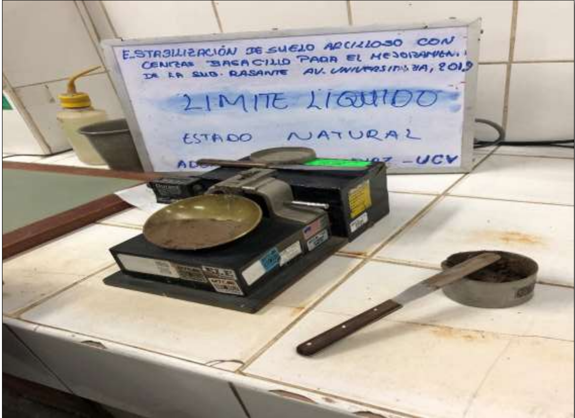
Imagen 26: Ensayo de límites de Atterberg a la muestra de suelo arcilloso CS-02.
