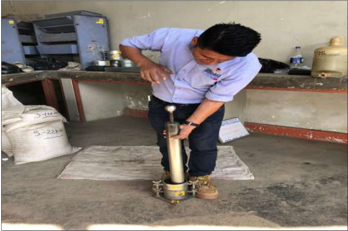
Imagen 31: Compactación con energía modificada a la muestra de suelo CS-02 en estado natural.
