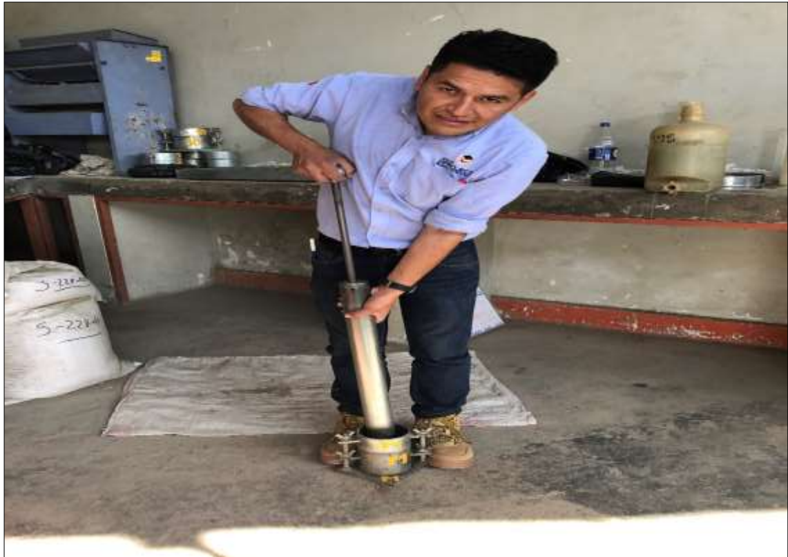
Imagen 35: Compactación con energía modificada a la muestra de suelo CS-02 + 10% CB
