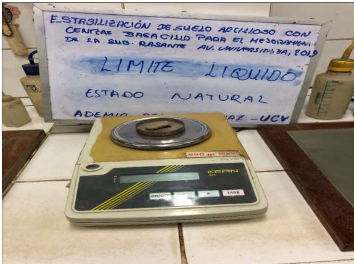
Imagen 24: Ensayo de límites de Atterberg a la muestra de suelo arcilloso CS-02.
