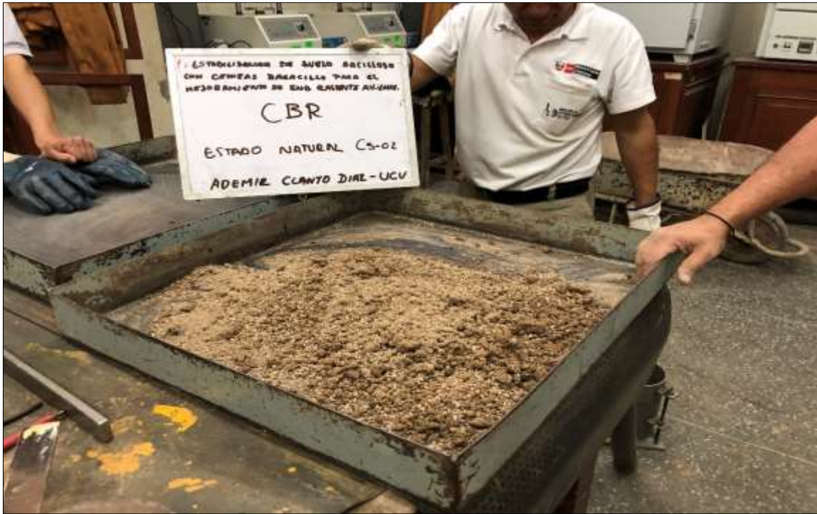
Imagen 49: Ensayo de CBR de la muestra de suelo CS-02 a la muestra en estado natural.
