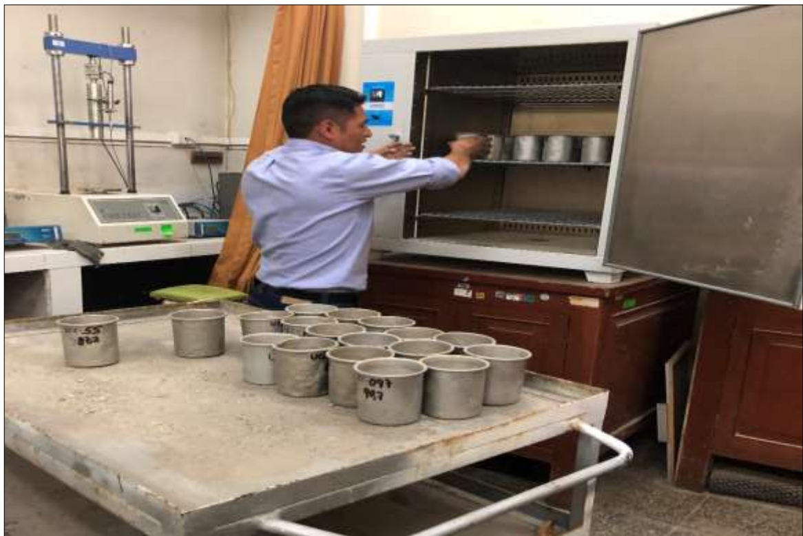
Imagen 48: Muestras de las probetas compactadas son llevadas al horno.
