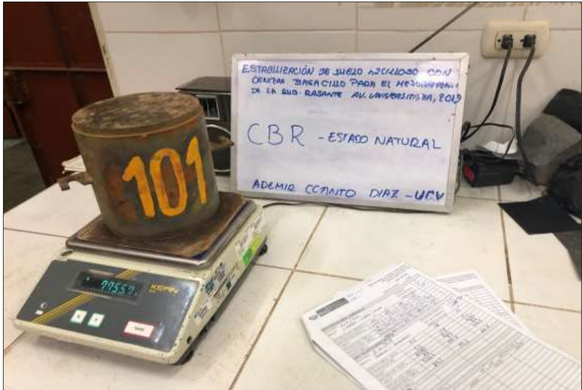
.Imagen 51: Probeta compactada del ensayo de CBR de la muestra CS-02 en estado natural.
