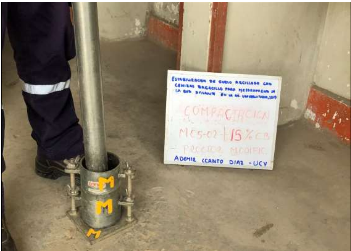
Imagen 40: Compactación con energía modificada a la muestra de suelo CS-02 + 15% CB.
