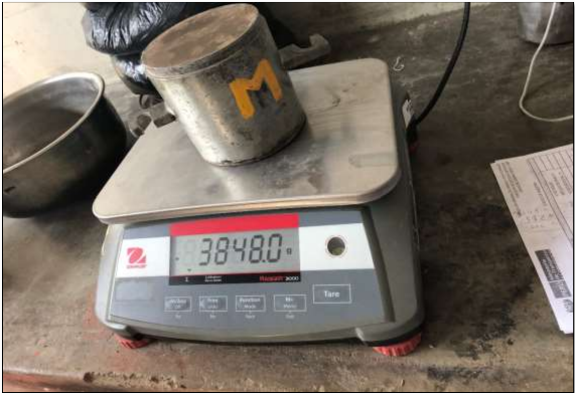
Imagen 41: Probeta compactada Compactación con energía modificada a la muestra de suelo CS-02 + 15% CB.
