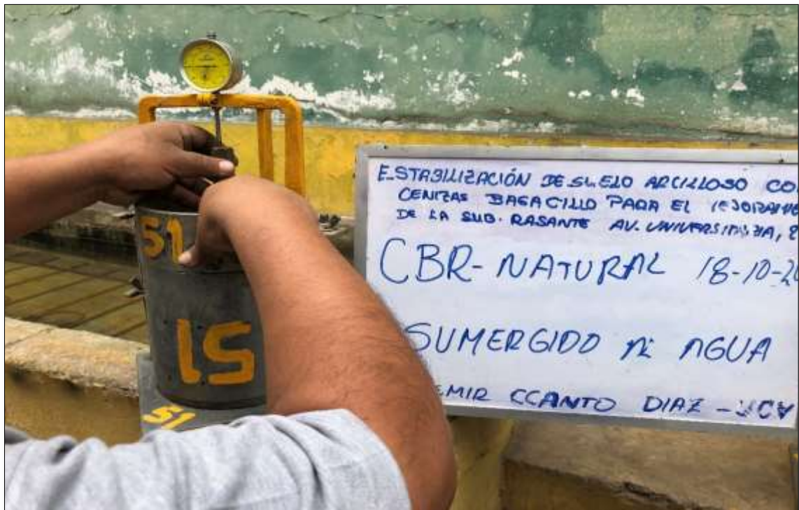
Imagen 52: Probeta compactada del ensayo de CBR en estado natural, sumergida en agua por 4 días.
