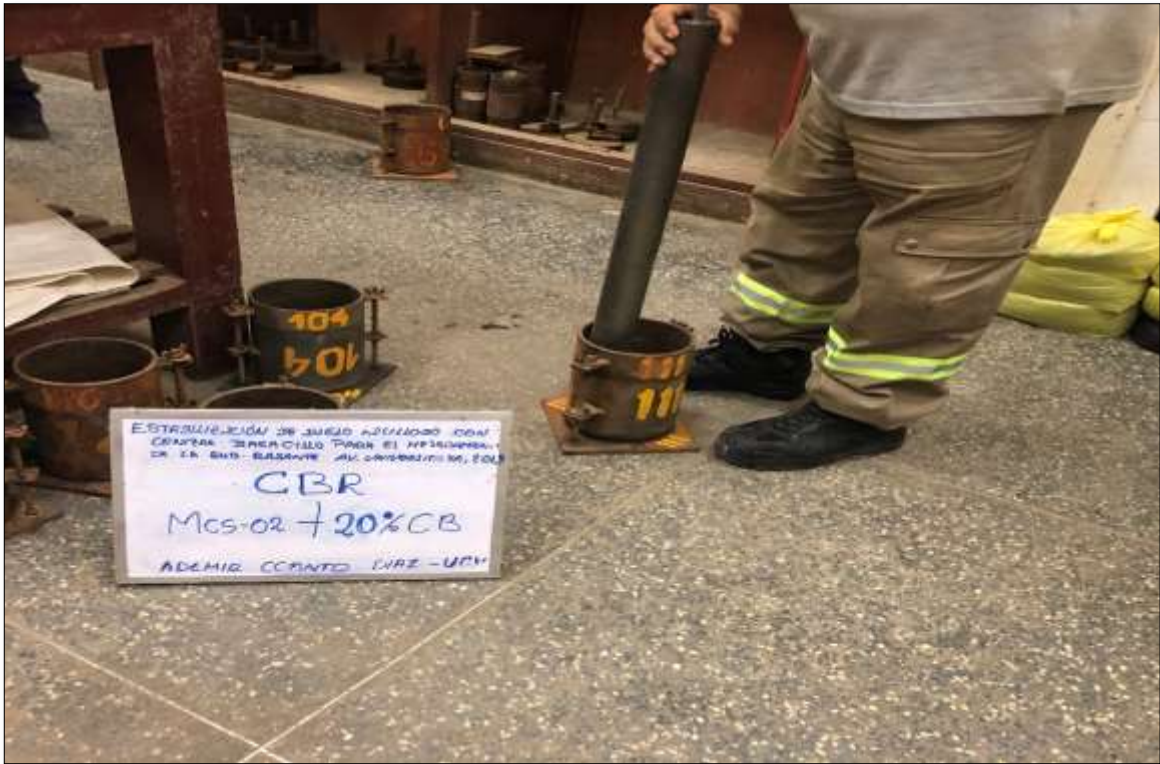
Imagen 63: Probeta compactada del ensayo de CBR de la muestra CS-02 + 20% de CB.
