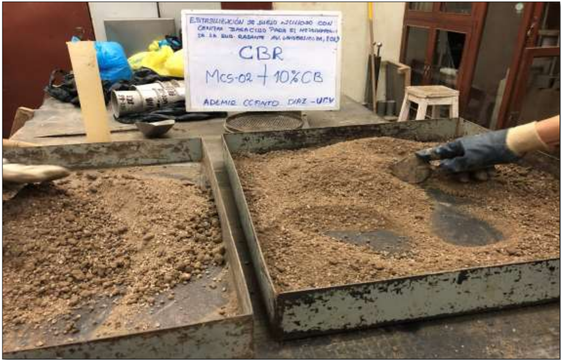
Imagen 53: Ensayo de CBR de la muestra de suelo CS-02 + 10 % Cb.
