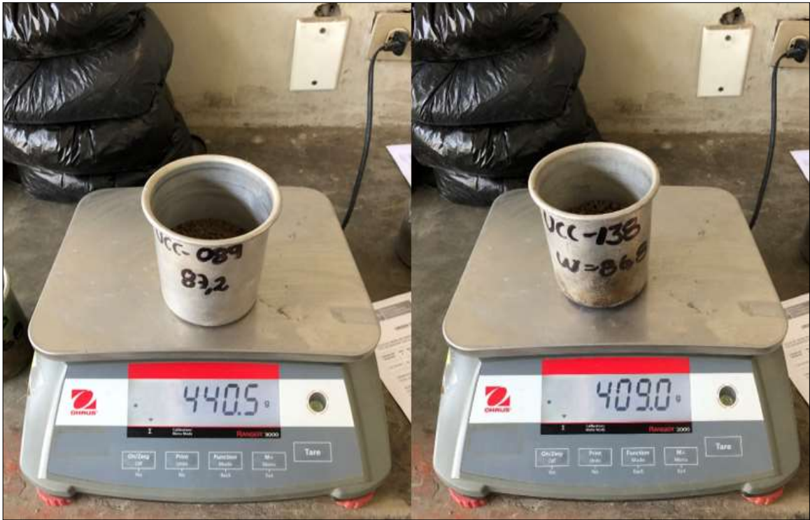
Imagen 47: Muestreo de la probeta para ser llevada al horno sometida a energía modificada a la muestra de suelo CS-02 + 20% de CB.
