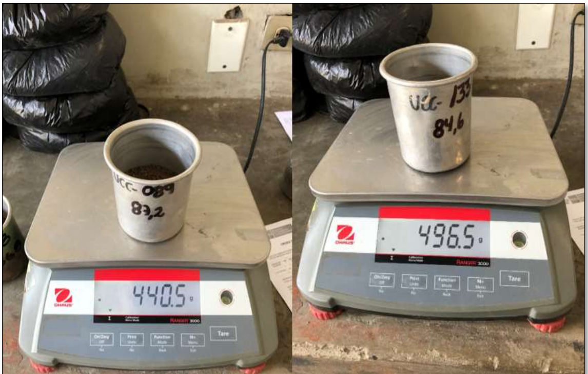
Imagen 42: Muestreo de la probeta para ser llevada al horno sometida a energía modificada a la muestra de suelo CS-02 + 15% de CB.
