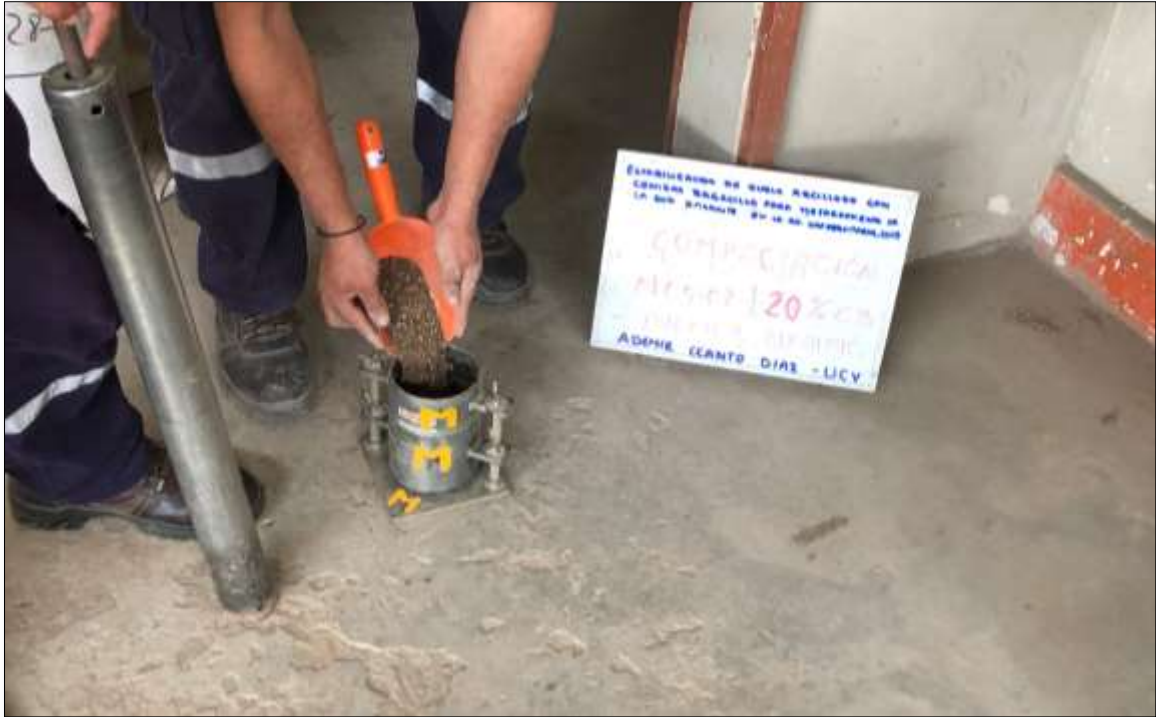
Imagen 45: Compactación con energía modificada a la muestra de suelo CS-02 + 15% CB.
