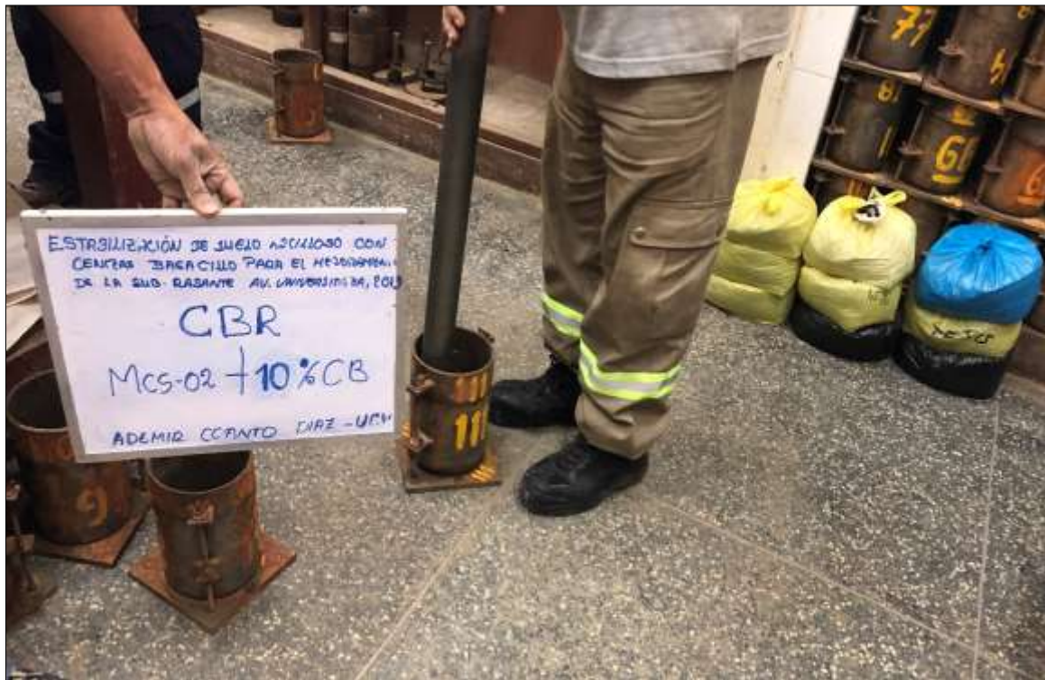
Imagen 55: Probeta compactada del ensayo de CBR de la muestra CS-02 + 10% de CB.
