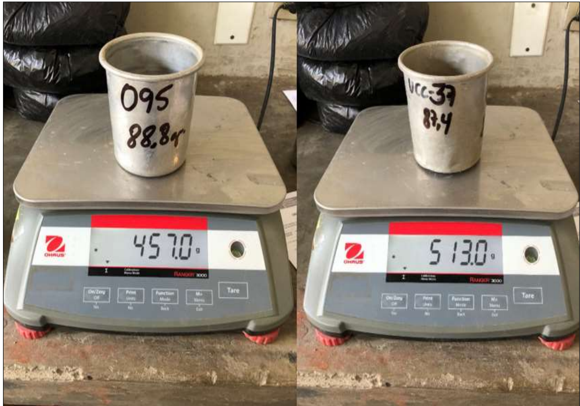
Imagen 37: Muestreo de la probeta para ser llevada al horno sometida a energía modificada a la muestra de suelo CS-02 + 10% de CB.
