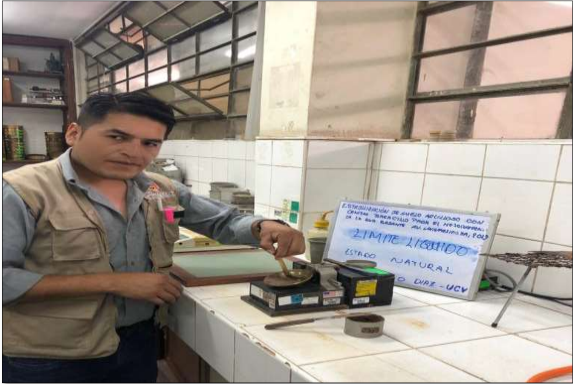
Imagen 25: Ensayo de límites de Atterberg a la muestra de suelo arcilloso CS-02.
