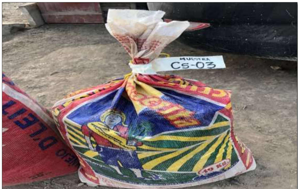
Imagen 16: Recojo de muestra de calicata CS-03 en la progresiva 25 + 500 a 1.50 m. de profundidad.
