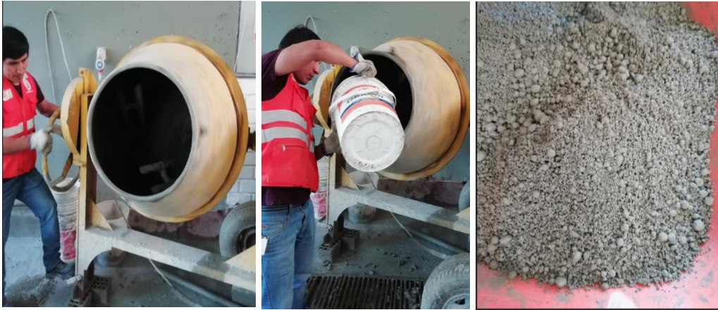
Figura 15: proceso de mezclado para la bloqueta patrón
