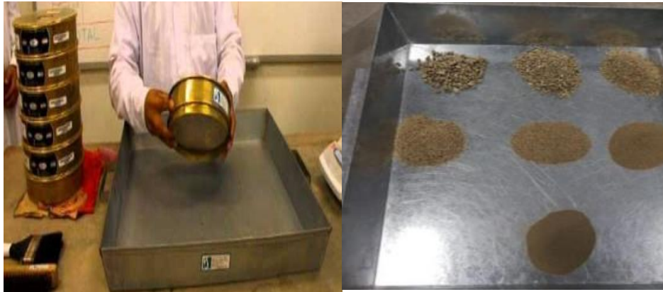
Figura 8: Tamizado de muestra
