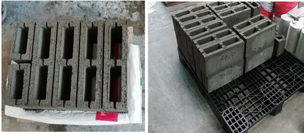
Figura 32: proceso de producción de bloquetas patrón
