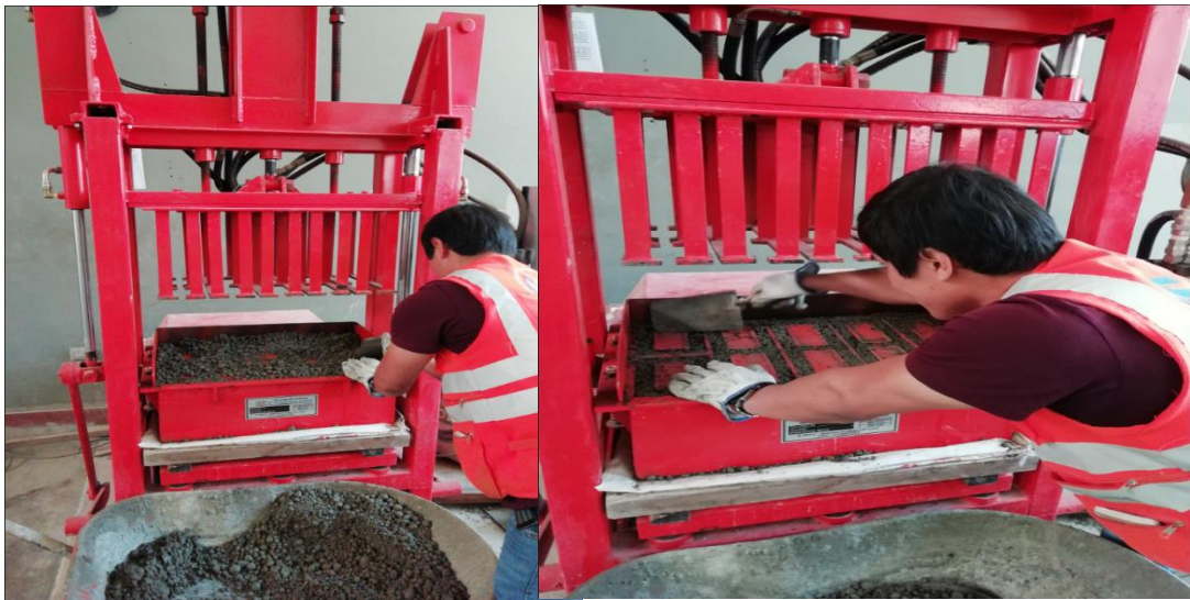
Figura 21: proceso de moldeado en la bloquera Famaco.
