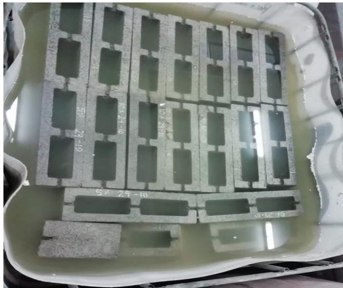
Figura 18: proceso de curado de las bloquetas patrón.
