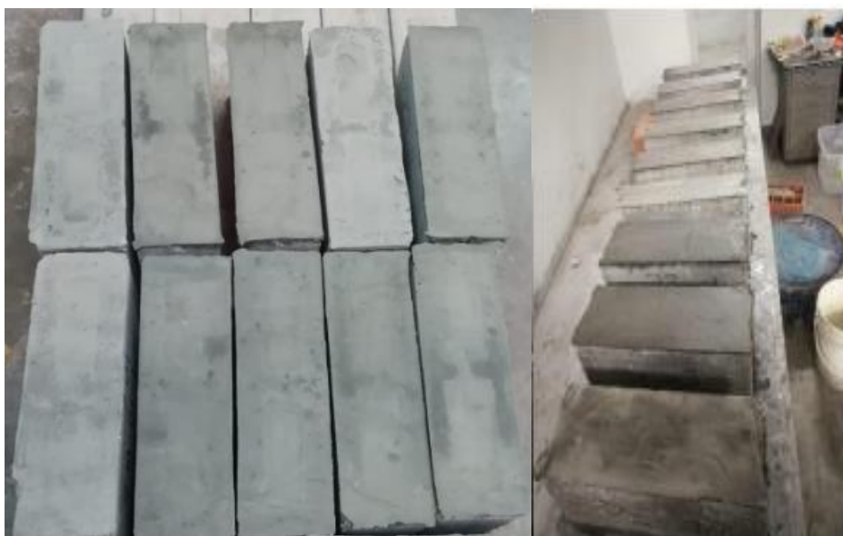
Figura 34: capeado de bloquetas
