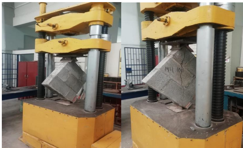
Figura 45: ensayo de compresión diagonal en muretes
