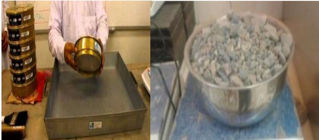
Figura 11: Tamizado de muestra
