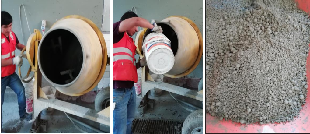
Figura 30: proceso de mezclado para la bloqueta patrón
