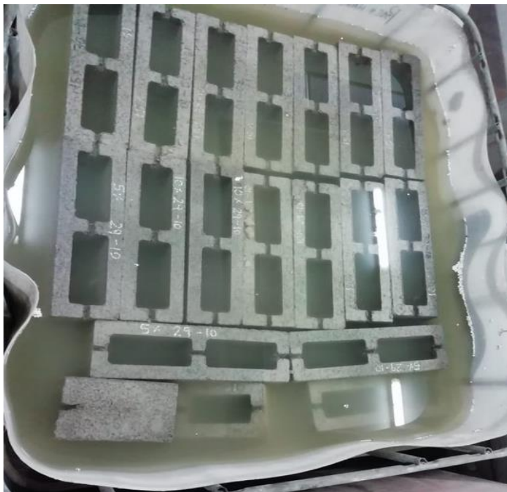
Figura 23: proceso de curado de las bloquetas patrón.
