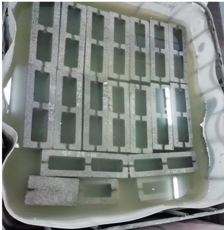
Figura 33: proceso de curado de las bloquetas patrón.
