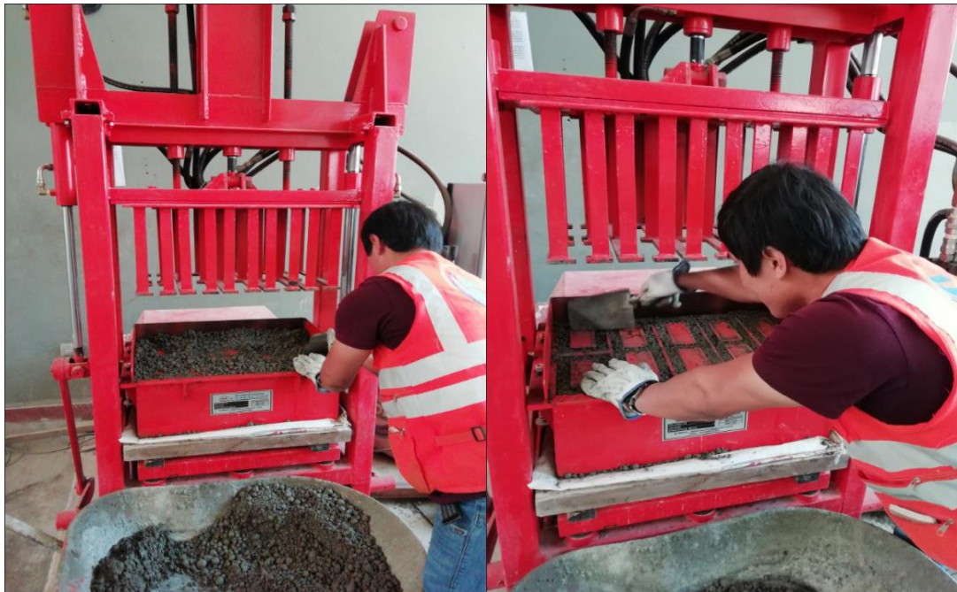
Figura 16: proceso de moldeado en la bloquetera Famaco.
