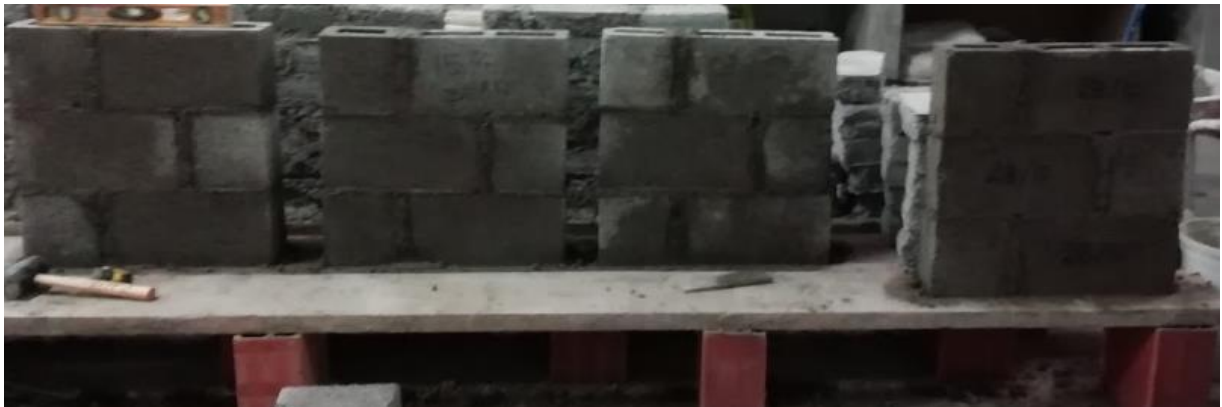
Figura 44: elaboración de muretes para cada combinación
