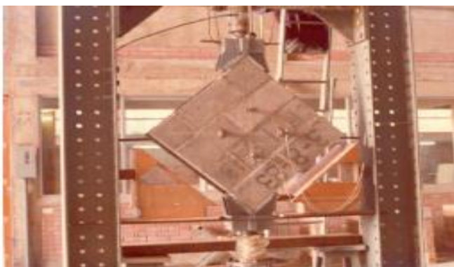
Figura 5: equipo de ensayo de compresión diagonal de muretes
