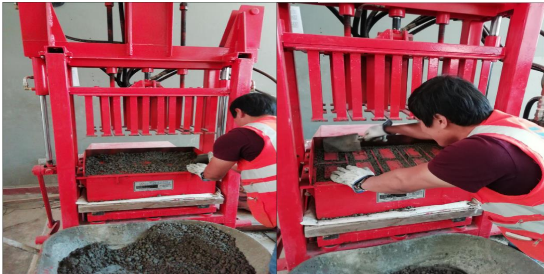
Figura 26: proceso de moldeado en la bloquera Famaco.
