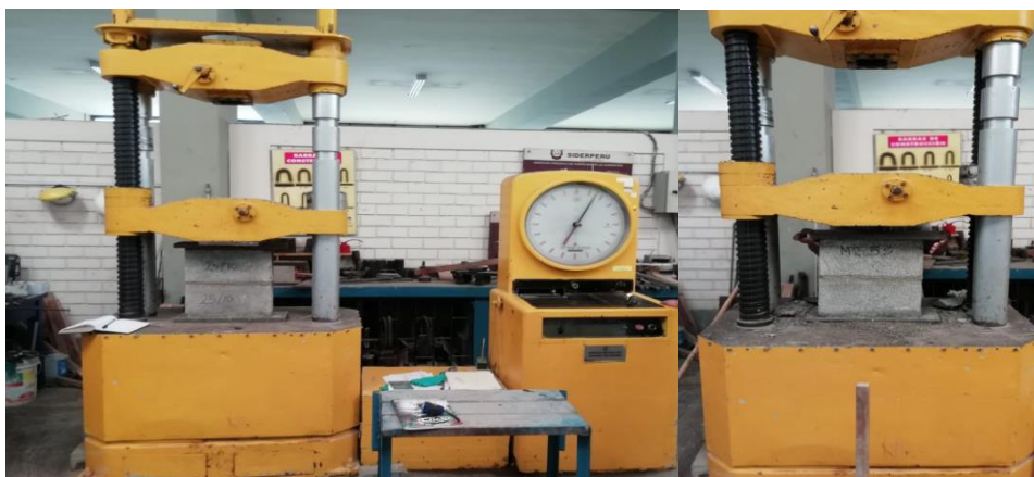
Figura 43: ensayo de compresión en pila
