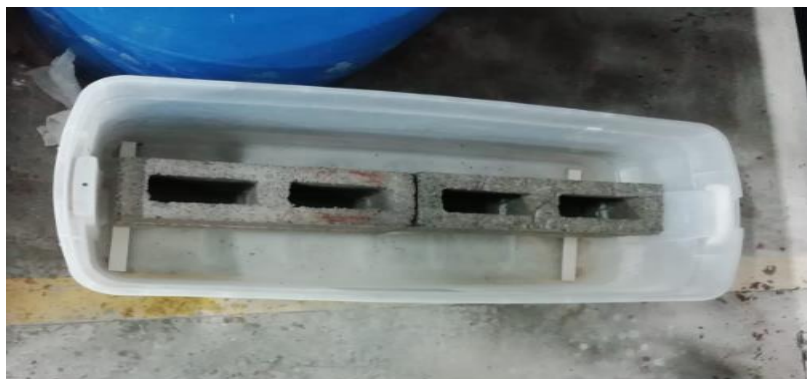
Figura 40: saturación de bloquetas
