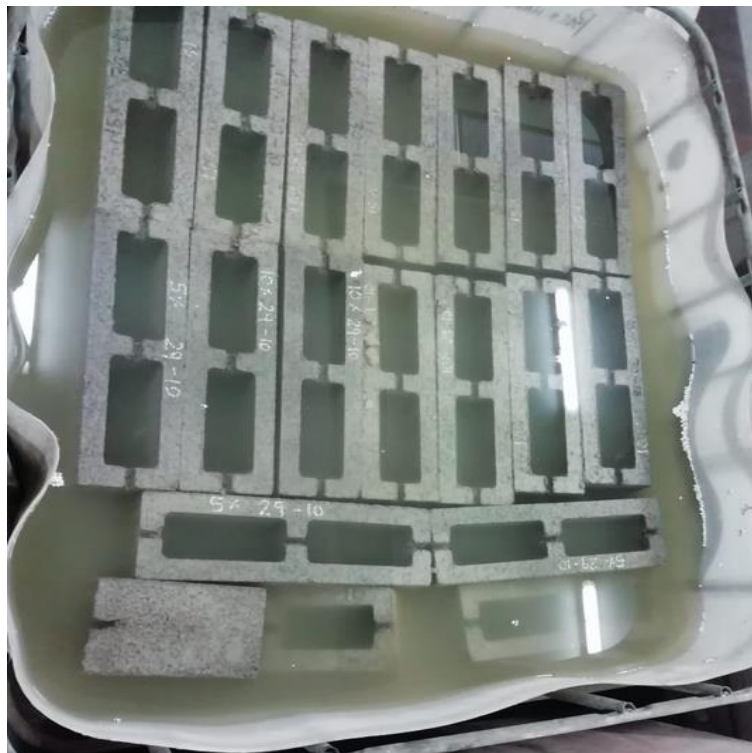
Figura 28: proceso de curado de las bloquetas patrón.
