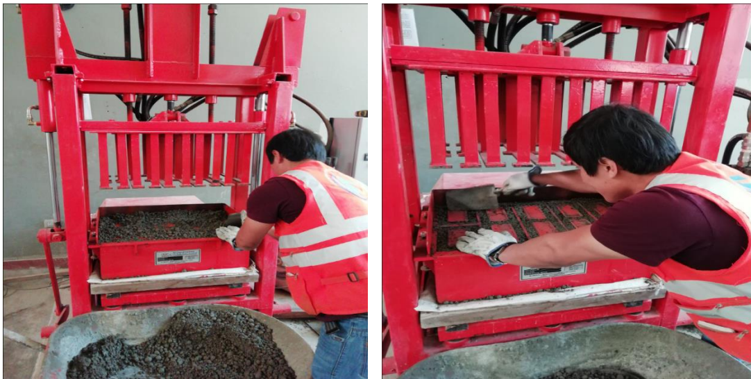
Figura 31: proceso de moldeado en la bloquera Famaco.
