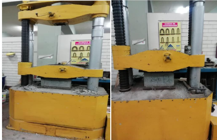
Figura 35: ensayo de resistencia a la compresión en unidades Fuente: LEM- (UNI)
