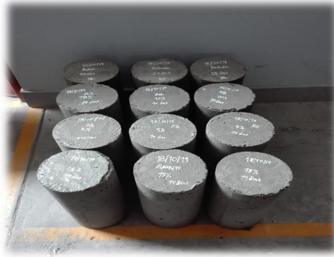
Desencofrado de probetas.
