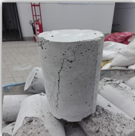
Ruptura de probetas con 10% de adición de caucho reciclado.
