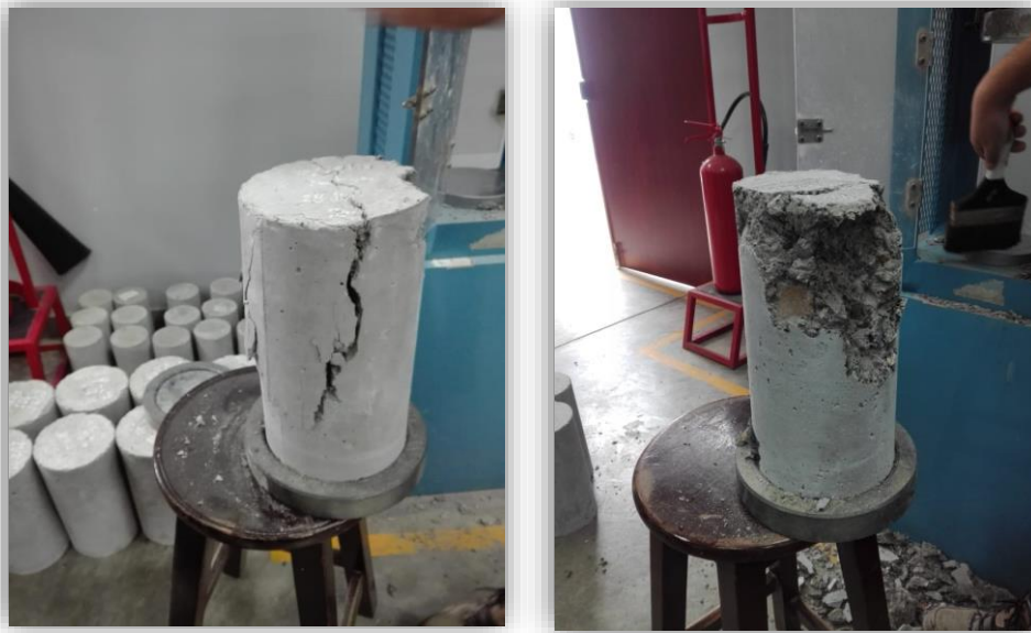
Ruptura de probetas sin caucho reciclado.
