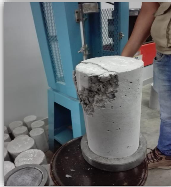
Ruptura de probetas con 5% de adición de caucho reciclado.
