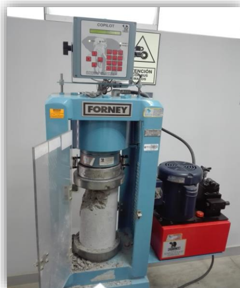
Ruptura de probetas con adición de caucho reciclado.
