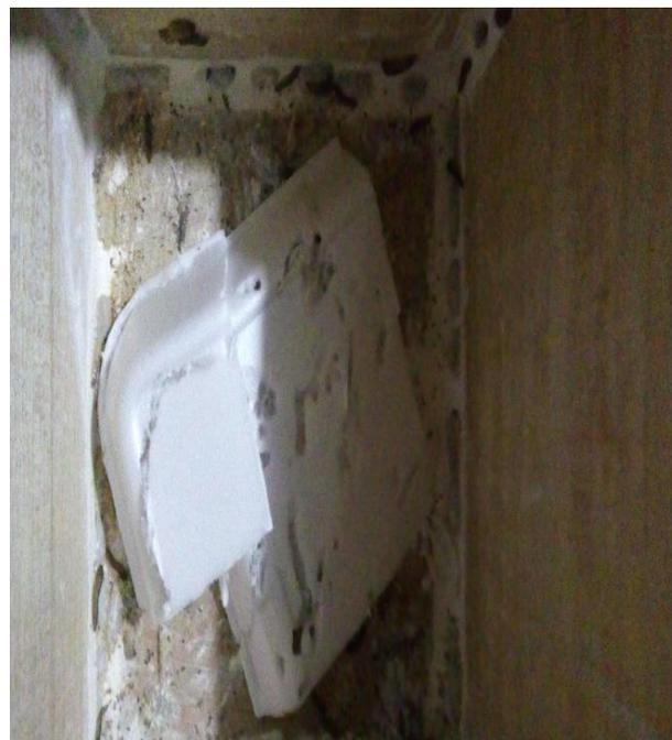
**Figura N° 28:** *Tecnopor biodegradado listo para el pesado en el laboratorio de la Universidad Cesar Vallejo – Moyobamba.*
