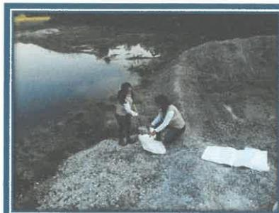
En estas imágenes se muestran los ensayos realizados para la determinación del % de humedad natural
