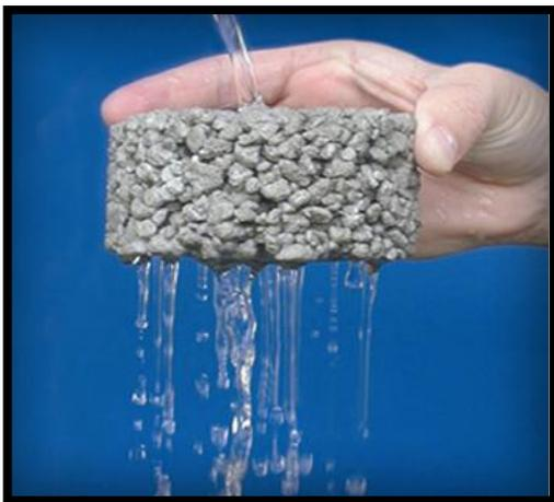
**Figura 1.** *Prototipo de Concreto Permeable*
