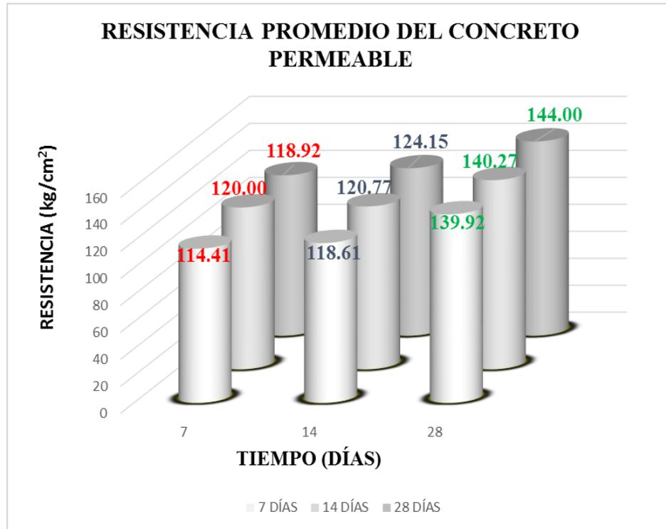
**Figura 3.** Resistencia promedio del concreto permeable  $f'c=140\text{kg/cm}^2$  aplicando el mineral no metálico romerillo.
