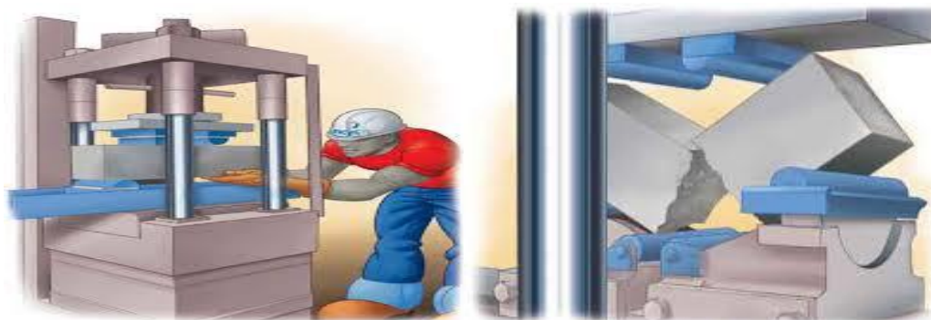
Figura 2. Ensayo de resistencia a flexión del concreto.
