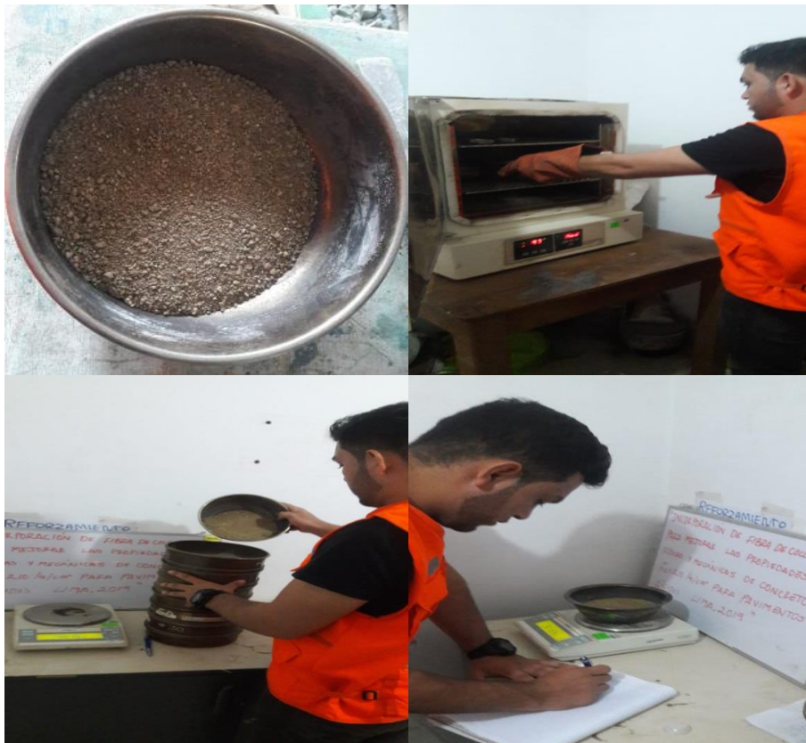
Figura 9: Procedimientos de ensayogranulométrico del agregado fino
