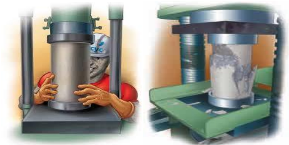
Figura 1. Ensayo de resistencia a compresión del concreto.
