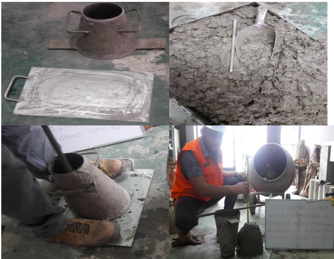
Figura 24. Procedimiento de ensayo de asentamiento
