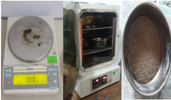
Figura 13: Ensayo de contenido de humedad de los agregados
