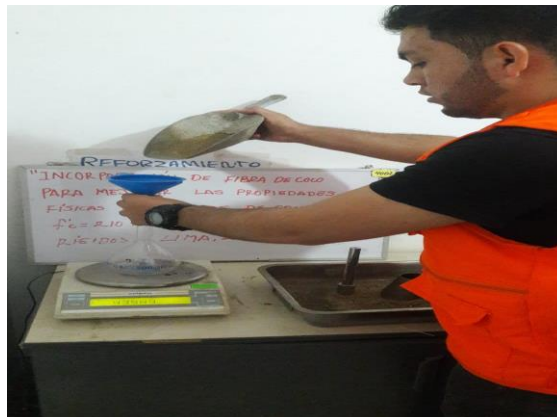
Llenado de material en la fiola
