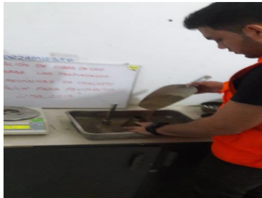
Llenado de cono metálico truncado
