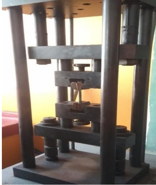
Figura 35. Montaje de las probetas de ensayo en la maquina universal de tracción.
