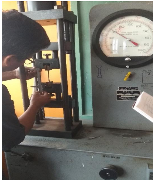
Figura 36. Toma de medidas y resultados en la maquina universal de tracción
