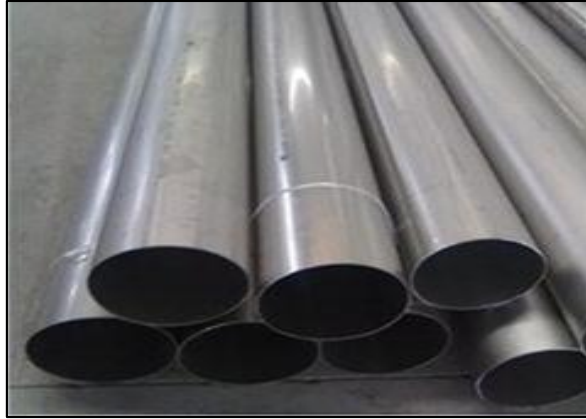
Figura 20. Tubería de acero inoxidable austenítico AISI 304
