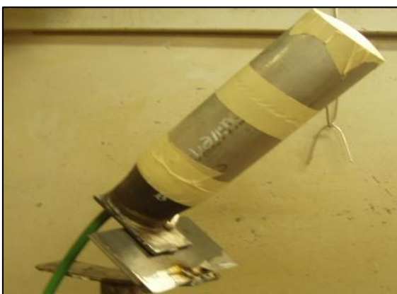
Figura 33. Ejecución gas del respaldo
