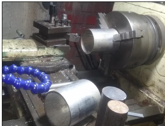
Figura 23. Cilindrado y refrentado de tubería AISI 304
