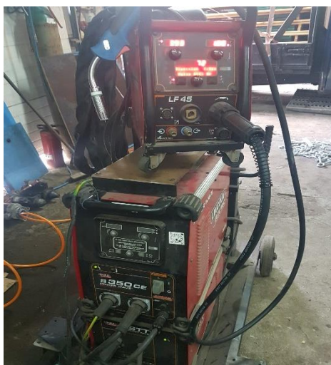
Figura 17. Máquina de soldeo proceso POWER WAVE S350
