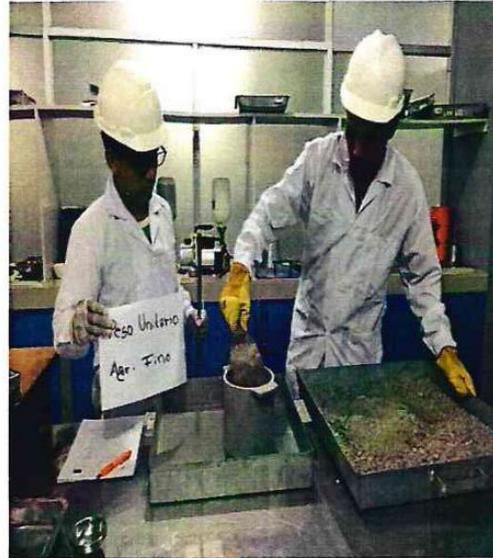
✓ PESO DEL MOLDE EN ESTADO SUELTO (MOLDE + ARENA)
