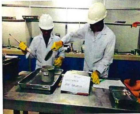
✓ PROCESO DE ENRASE DEL AGREGADO GRUESO Y EL PESO, EN ESTADO SUELTO (MOLDE + ARENA)
