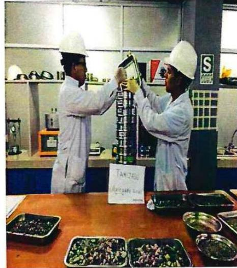
✓ PROCESO DE TAMISADO DEL AGREGADO GRUESO CON LA NORMA TECNICA NTP 339.128. (ASTM D 4318).
