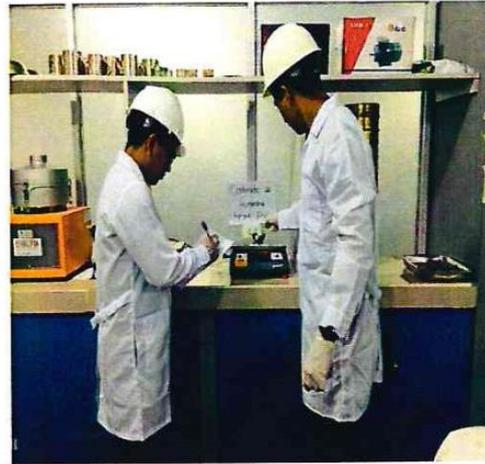
✓ PROCESO DE LLENADO DEL MATERIASL PARA CONTENIDO DE HUMEDAD DEL AGREGADO FINO CON LA NORMA TECNICA NTP 339.127(ASTM D 2216)
