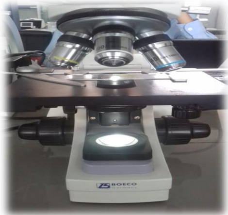
Microscopio empleado para la observación de la microalga Scenedesmus sp. , el objeto se estableció en 4x.
