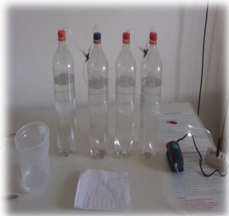
Forma final del biorreactor sin los inóculos, se observa el motor suministrador de oxígeno y los conectores correspondientes en cada contenedor (23 de septiembre del 2019).
