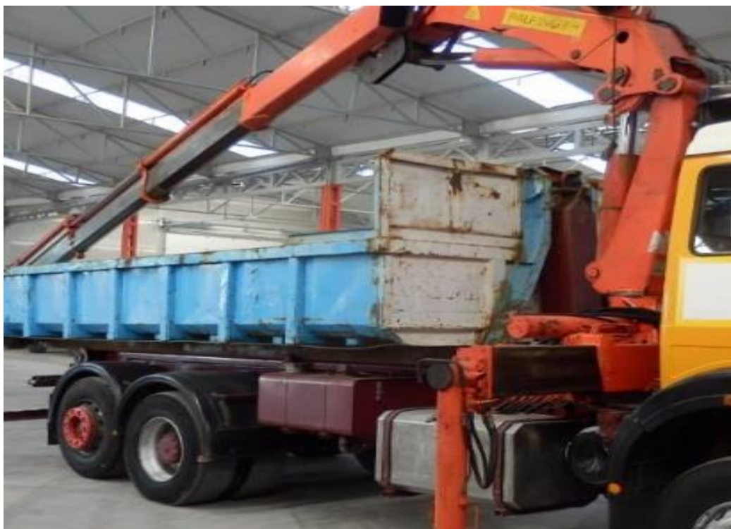
Figura 13: Camión grúa Hiab
