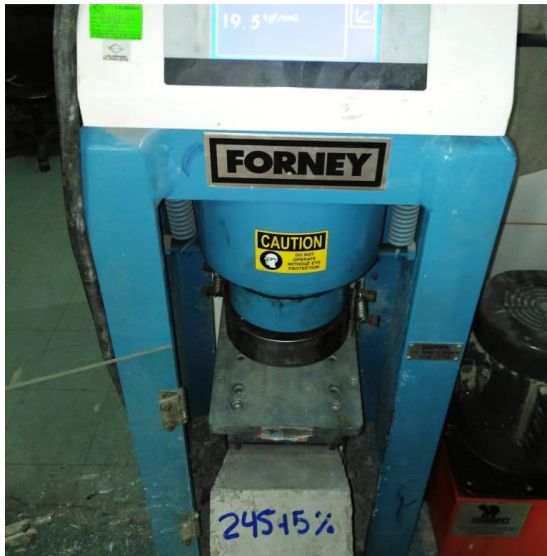
Resistencia a flexión de f'c=245 \text{ kg/cm}^2 con escoria de acero y microsíllice 5%
