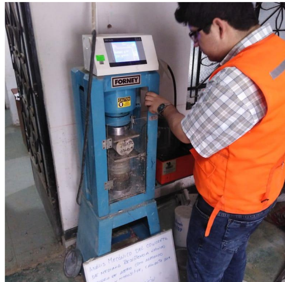
Resistencia a tracción de f'c=210 \text{ kg/cm}^2 con escoria de acero y microsíllice 5%
