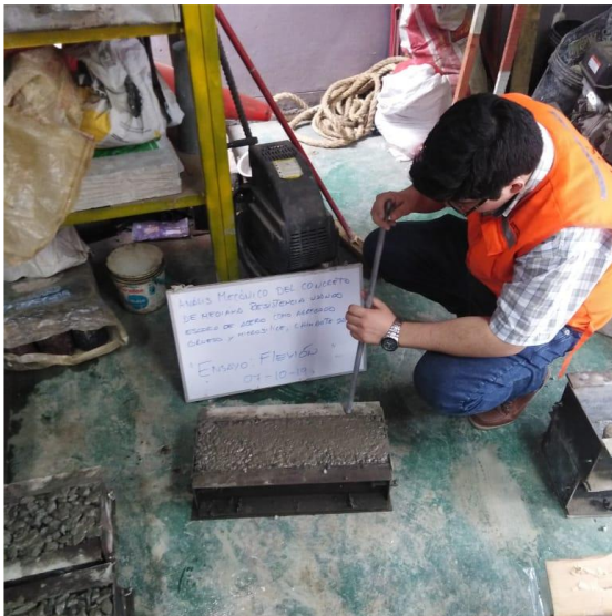
compactación para ensayo a flexión en viga con escoria de acero y microsíllice
