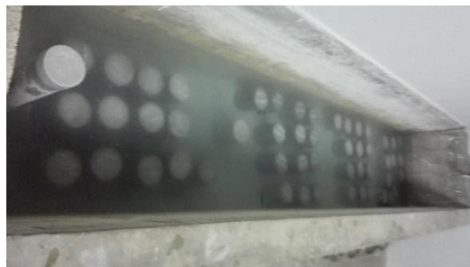
Figura 47: Colocado de las probetas en la piscina de curado
