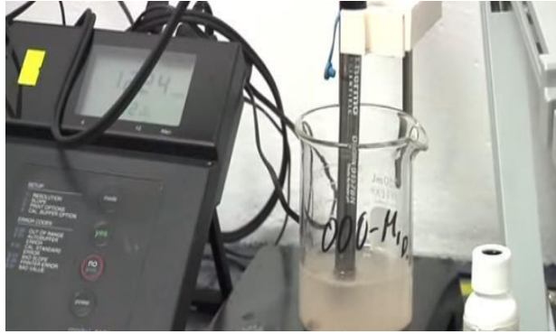
Figura 52: Medición de ph en el concreto endurecido
