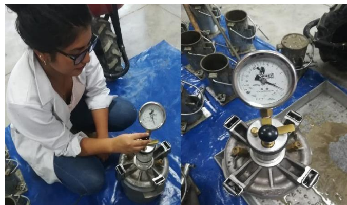
Figura 45: Contenido de aire de CP+ 1.0% y CP+ 1.5%
