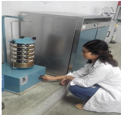
Figura 19: Los tamices se colocan en el tamizador industrial
