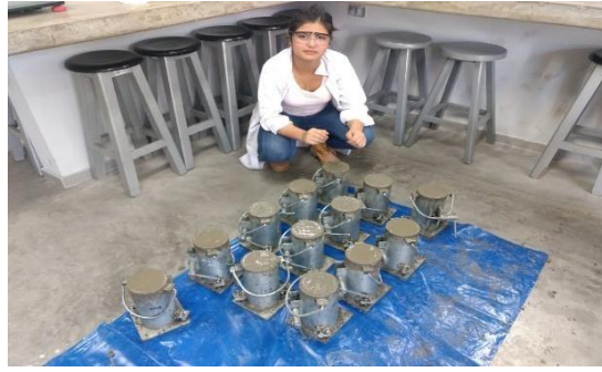
Figura 46: Moldes vaciados de un grupo de concreto
