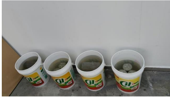
Figura 48: Concreto sometido al agua de mar después de los siete días de curado
