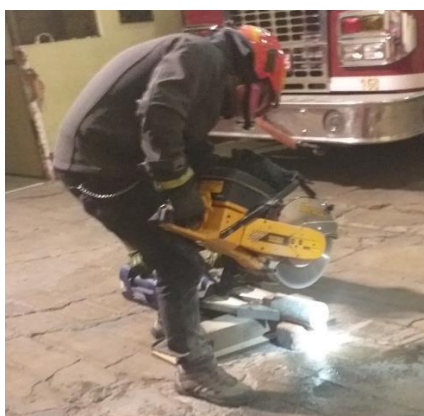
Figura 53: Corte de la probeta en forma de discos
