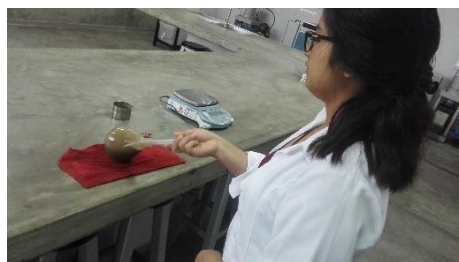
Figura 25: Agitamos el frasco para proceder a eliminar las burbujas
