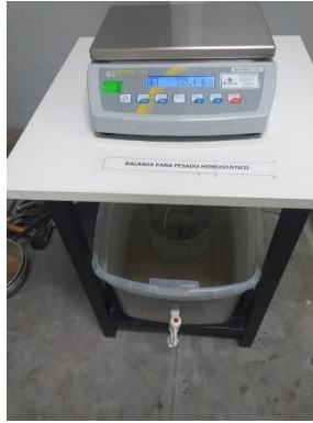
Figura 56: Peso Sumergido de la Muestra
