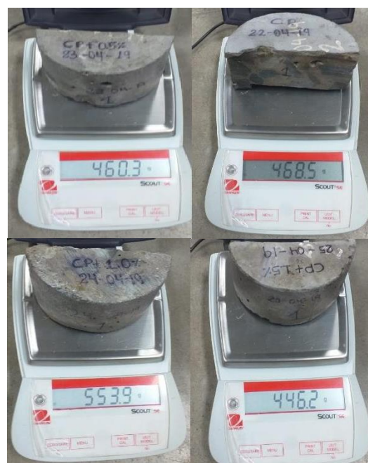
Figura 55: Peso Saturados Superficialmente Seco
