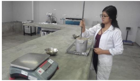
Figura 29: Compactamos la muestra con ayuda de la varilla de 3/8''
