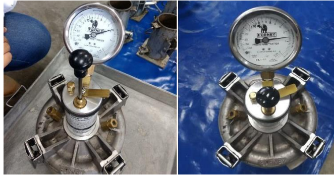
Figura 44: Contenido de aire de CP y CP+ 0.5%
