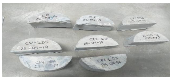
Figura 54: Probetas en forma de Luna expuestas a 14 días al agua salada
