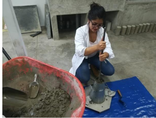
Figura 43_: Procedimiento para hallar el slump
