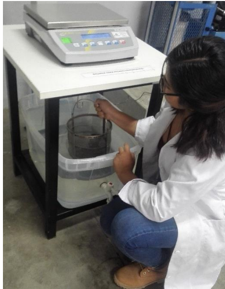
Figura 37: colocado de la muestra en la balanza hidrostática
