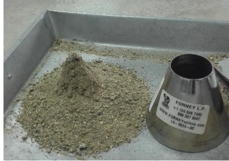
Figura 24: Arena Superficialmente seca después del apisonado
