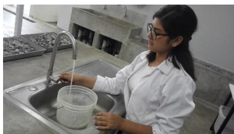
Figura 23: Cubrimos la muestra con agua y dejamos reposar 24 h
