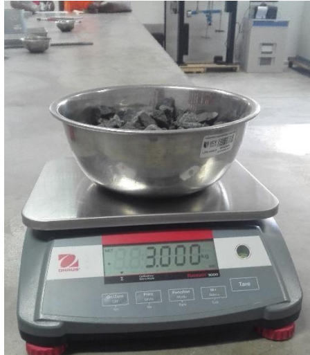
Figura 36: Peso de la muestra Saturada Superficialmente Seca
