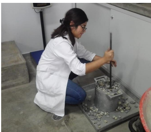
Figura 39: Varillando el material en la tercera capa
