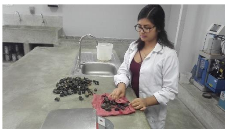
Figura 35: Secando la muestra con un paño absorbente
