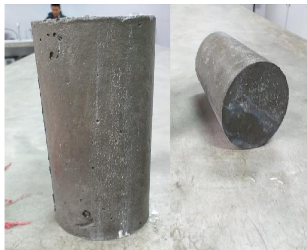
Figura 50: Probeta sometida a 14 días a agua salada
