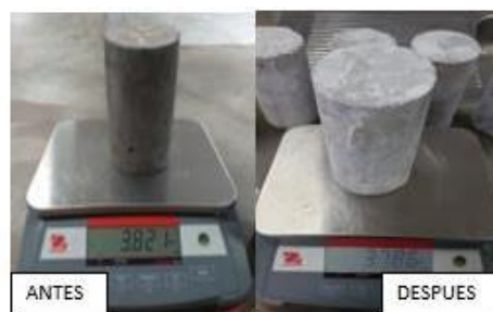
Figura 51: Podemos Observar probetas antes de ser sumergida y después
