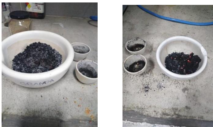
*Figura N°5 y 6 Pulverización del carbón*
