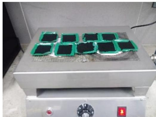
*Figura N° 26: Secado de la película de carbón activado
