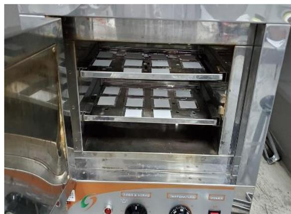
*Figura N° 14: Secado de las películas de dióxido de titanio*
