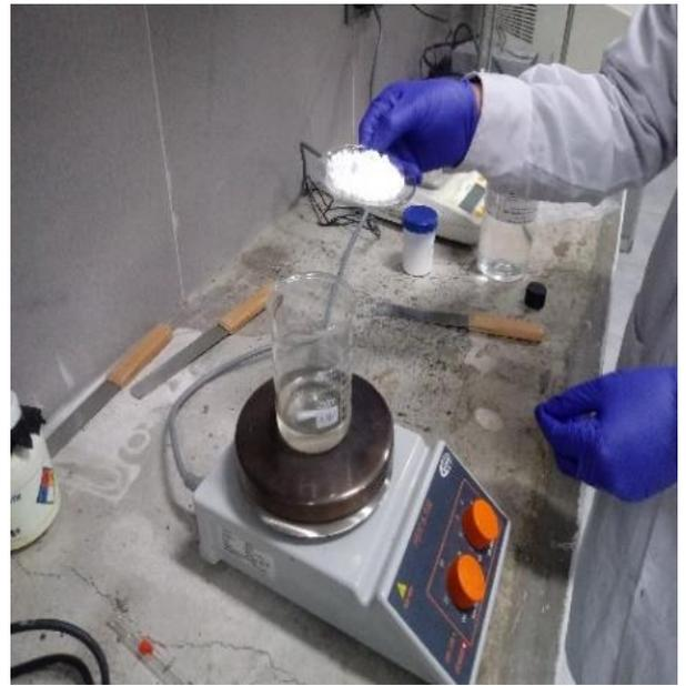
*Figura N° 12: Homogenización con agitador magnético*
