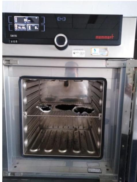
*Figura N°8. Carbón filtrado en la mufla*
