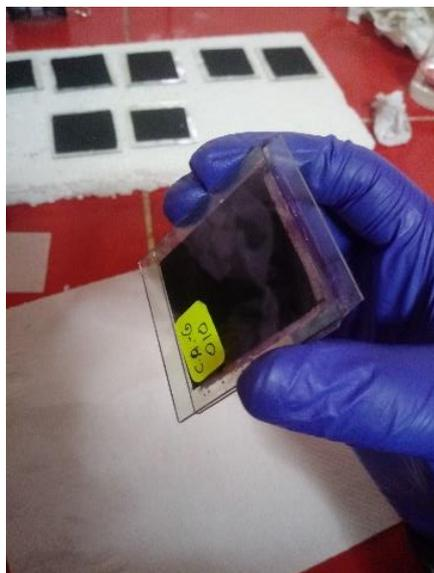
*Figura N° 28: Unión de las dos laminas*
