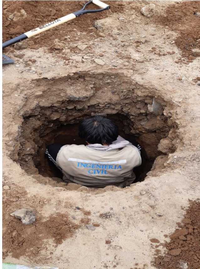
Figura 37. Toma de muestra de la calicata C-1
