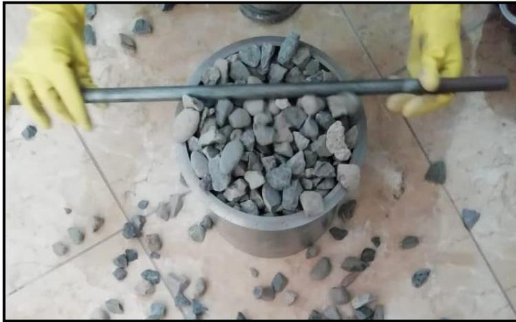
*Figura 5. Muestra de agregado grueso para ensayo de peso unitario*
