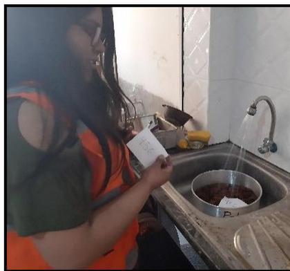
*Figura 29. Ladrillo recocho triturado sometida a saturación por 24 horas*
