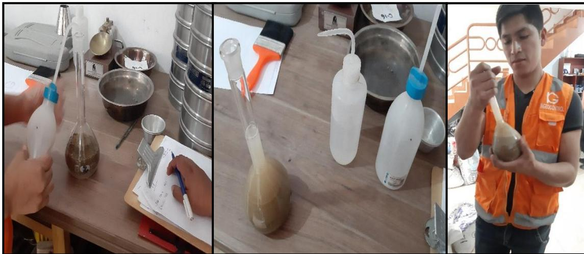
Figura 32. Picnómetro más Agregado fino y agua
