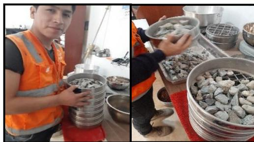
Figura 37. Ensayo de granulometría del agregado grueso (piedra chancada)
