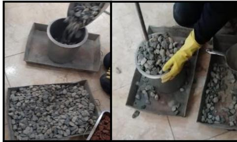
Figura 21. Ensayo de peso unitario compactado de la piedra chancada
