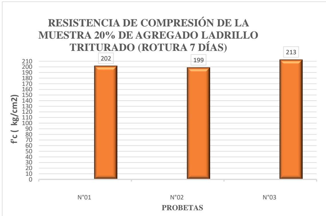
Figura 48. Resultados de f' c de la mezcla con 20% de reemplazo (7 días)
