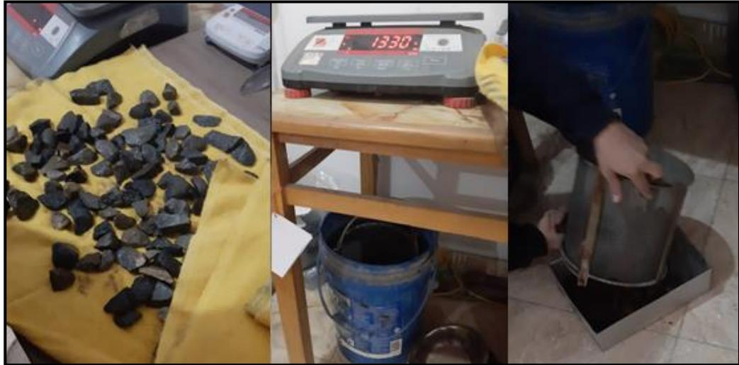
*Figura 6. Peso específico del agregado grueso (piedra chancada) en laboratorio*
