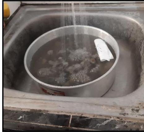
*Figura 26. Piedra chancada sometida a saturación por 24 horas*
