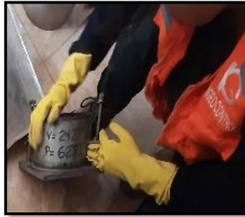
Figura 19. Recipiente cilíndrico de menor altura para ensayo de peso unitario
