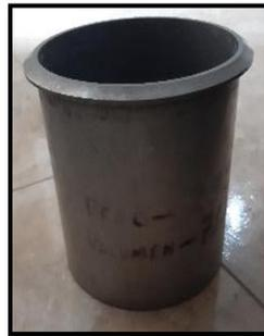
*Figura 18. Recipiente cilíndrico para ensayo de peso unitario*
