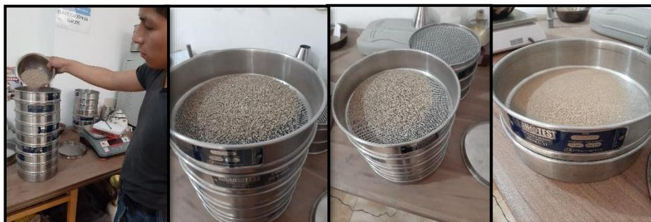
*Figura 33. Ensayo de granulometría de agregado fino*
