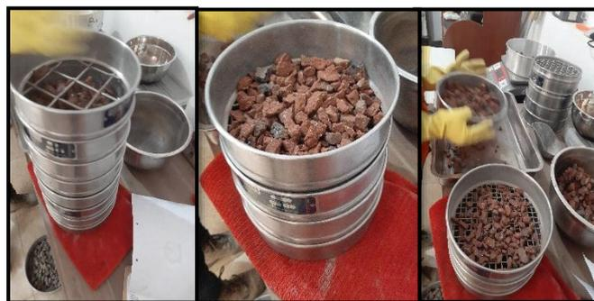
Figura 35. Ensayo de granulometría de ladrillo recocho triturado
