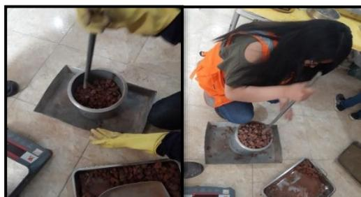
Figura 23. Ensayo de peso unitario compactado del ladrillo recocho triturado
