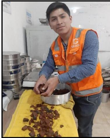
*Figura 30. Secado superficial del ladrillo recocho triturado*
