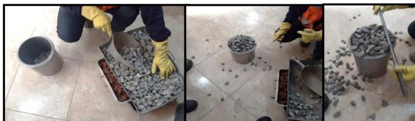
Figura 20. Ensayo de peso unitario suelto de la piedra chancada
