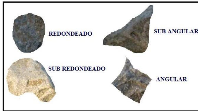
Figura 2. Formas de los agregados
