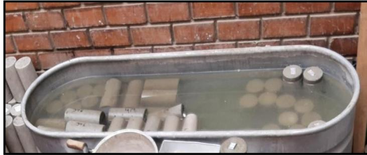
Figura 43. Curado de probetas de concreto de 4" x 8"
