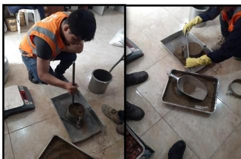
Figura 25. Ensayo de peso unitario compactado de la arena gruesa
