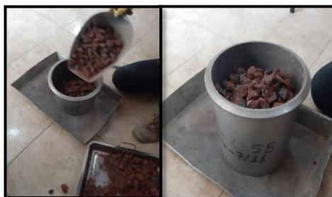
Figura 22. Ensayo de peso unitario suelto del ladrillo recocho triturado
