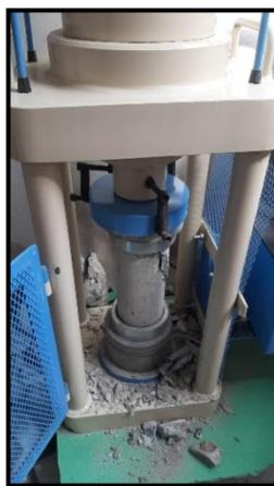
Figura 44. Ensayo de resistencia a la compresión
