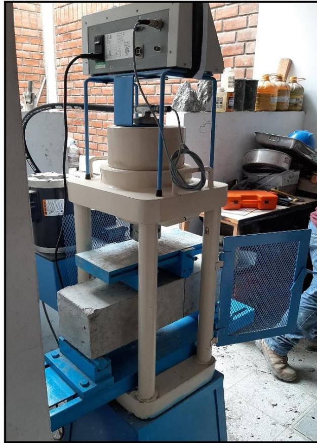
*Figura 60. Ensayo de flexión a los tercios de la luz*
