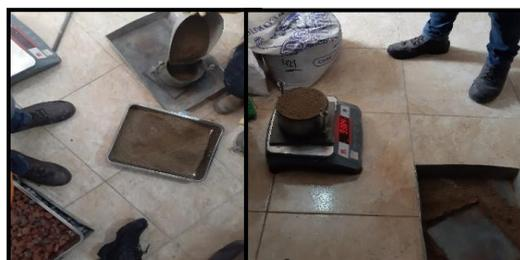
Figura 24 Ensayo de peso unitario suelto de la arena gruesa
