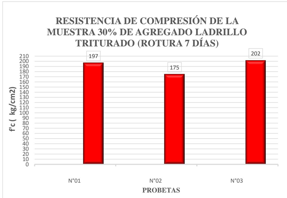
Figura 49. Resultados de f ' c de la mezcla con 30% de reemplazo (7 días)
