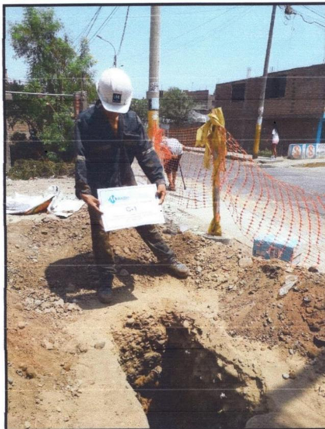
Foto N° 1: Se muestra la exploración de la C-1, la cual presenta, un 16.66% de relleno no controlado, un 13.33% de arena limosa, un 13.33% de arena arcillosa y 56.68% de grava limosa con arena.
