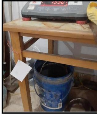
*Figura 28. Peso de la piedra chancada en el agua de la muestra saturada*
