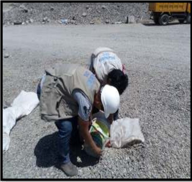
RECOLECCIÓN DEL AGREGADO GRUESO DE LA CANTERA DE HUANCHACO.
