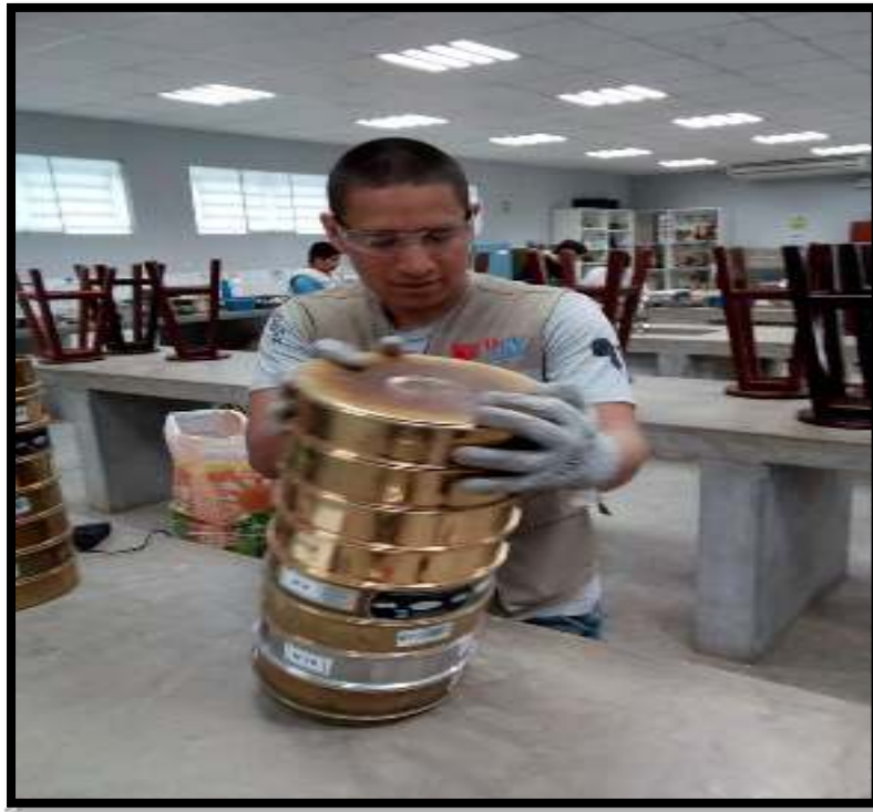
HACEMOS EL TAMIZADOS DE LOS AGREGADOS
