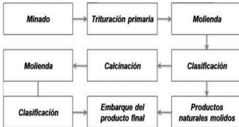
Figura 1.3 Proceso de extracción de la diatomita
