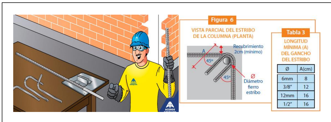
Figura: Armado y colocación de refuerzo
