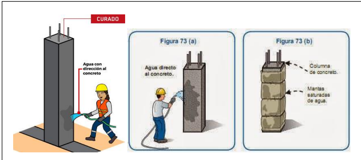
Figura 8: Desencofrado y Curado
