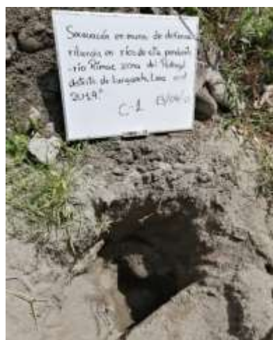
Figura 13: Extracción de muestra de la calicata C-1 Fuente: Elaboración Propia
