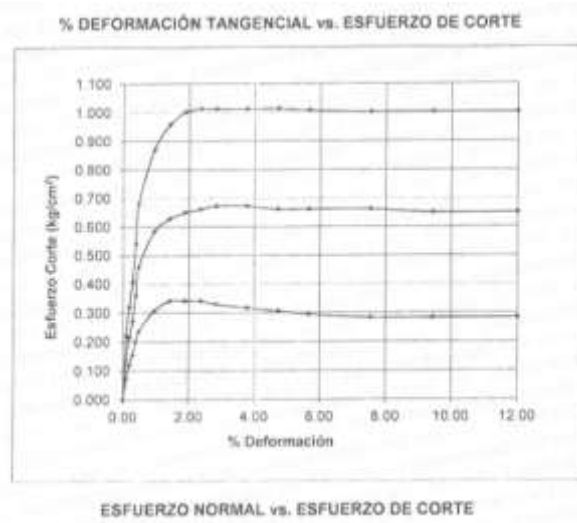
Figura 22: % Deformación tangencial vs Esfuerzo de corte de la muestra calicata C-2 Fuente: Laboratorio N°2 Mecánica de suelos – Universidad Nacional de Ingeniería (Anexo 04)
