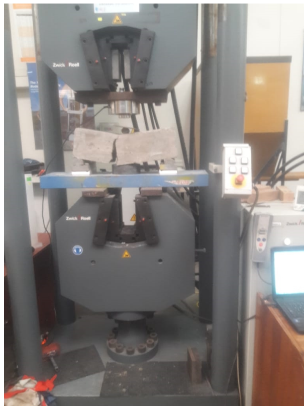
Figura 1.67 Rotura de viga
