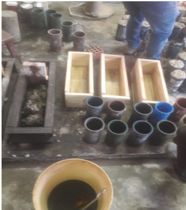
Figura 1.55 Aplicación del desmoldante en vigas
