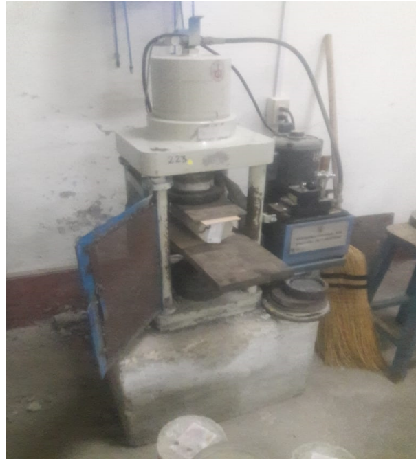
Figura 1.53 Ensayo de tracción en probetas
