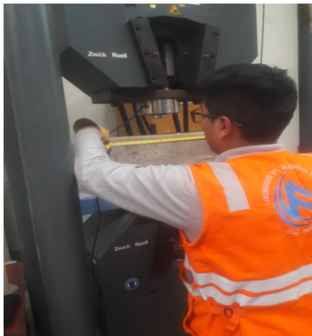
Figura 1.65 Medición de la viga a ensayar por el técnico
