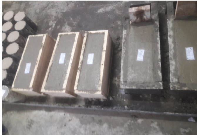
Figura 1.58 Vigas enrasadas y lisas
