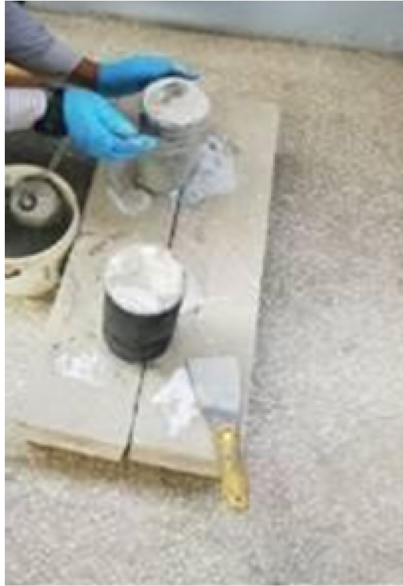
Figura 1.50 Reforzamiento de probetas cilíndricas con SikaWrap
