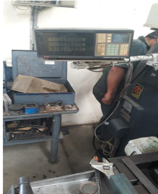
Fotografía 02: Tablero de control de medidas.
