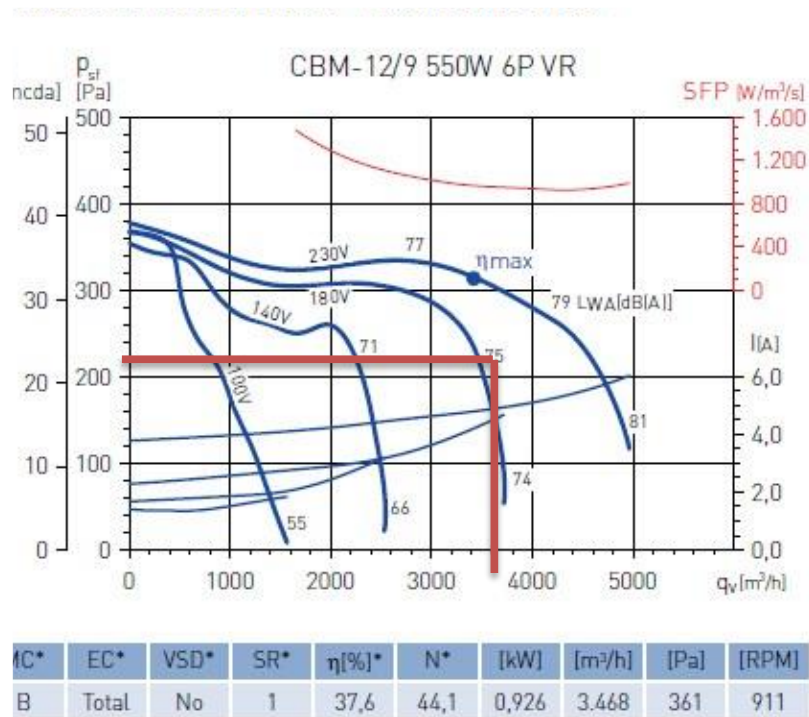
Figura 29. Selección de ventiladores centrífugos.
