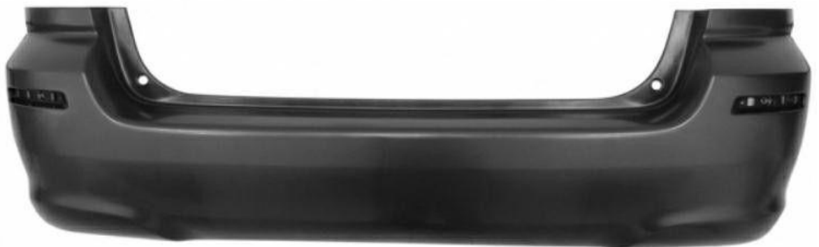
Figura 13. Para choque posterior auto corolla.
