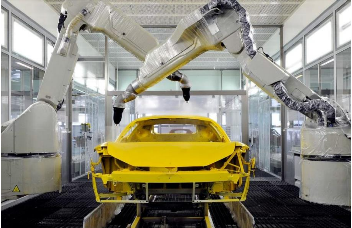
Figura 1. El nuevo proceso de pintado del Ferrari.
