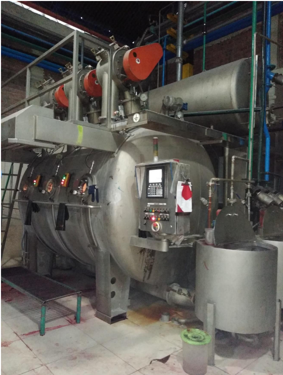
Fuente Propia: Máquina de teñido en Tintorería Fuente: Corporación Textil San Miguel S.A Autor: Miguel Carlos Araujo Angulo
