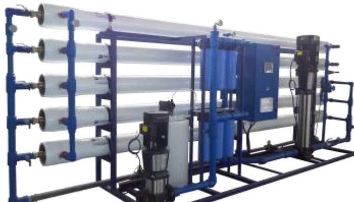
Figura 3. Ósmosis inversa y su sistema de filtración
