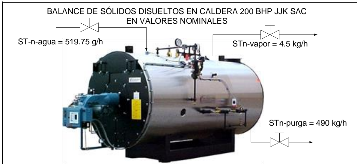
Figura 12.. Balance de sólidos disueltos en caldera 200 BHP. Elaboración propia
