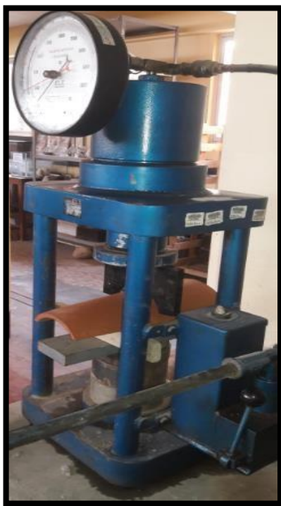
Figura 21: E. de flexión Teja comercial.
