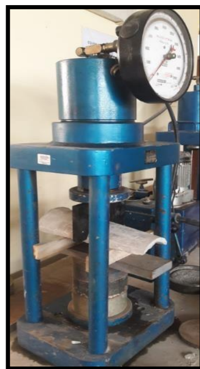
Figura 22: E. de flexión Teja microcimento
