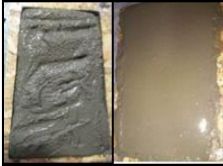
Figura 18: Moldeado de la teja y vibrado
