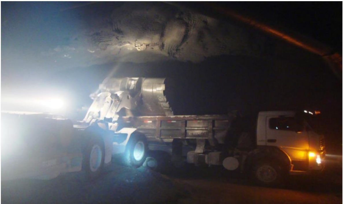
Figura 23: Carguío de volquete a través de un scooptrams. Fuente: Tomada de las operaciones mineras- unidad minera CMH.
