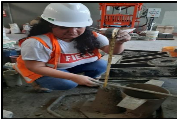
Figura 9. Midiendo la trabajabilidad del concreto utilizando el slump
