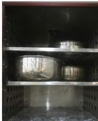
Figura 56 .Retiro de la muestra para el procedimiento peso específico
