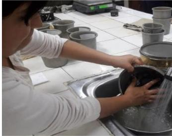
Figura 53. Lavado de partículas para peso específico
