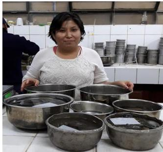
Figura 54 .Material sumergido en agua para el peso específico
