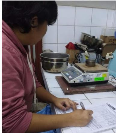
*Figura 46 .Peso del material retenido con ayuda de la balanza*
