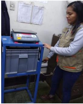
Figura 55 .Ensayo de flotación para su proceso de peso específico
