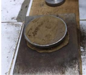
*Figura 61.* Porción de muestra en la caja de corte
