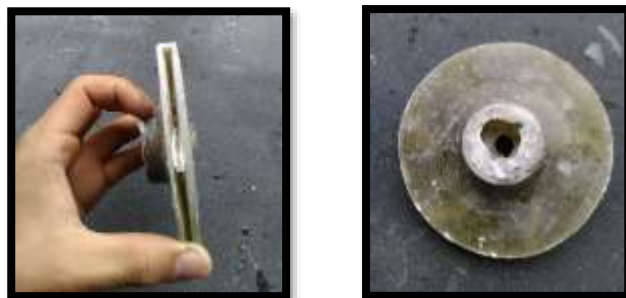
Figura N°3.2: Izq. Impulsor fabricado de fibra polimérica (vista frontal) Der. Vista lateral. Fuente. Elaboración propia.
