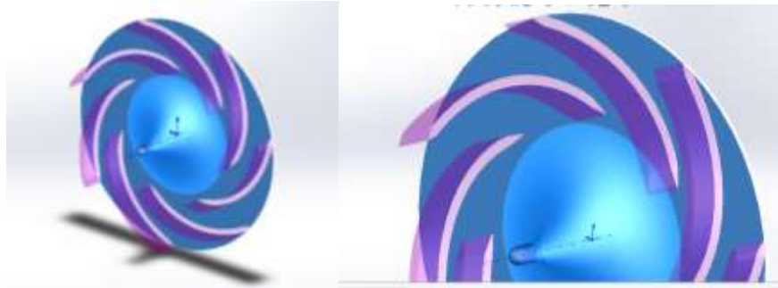
Figura N°3.3: Izq. Impulsor centrífugo con álabes. Der. Vista detallada de álabes.
