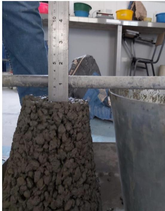
Ensayo de asentamiento del concreto permeable
