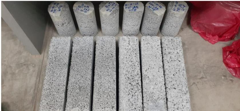
Especímenes de concreto permeable para ser ensayados a compresión y flexión
