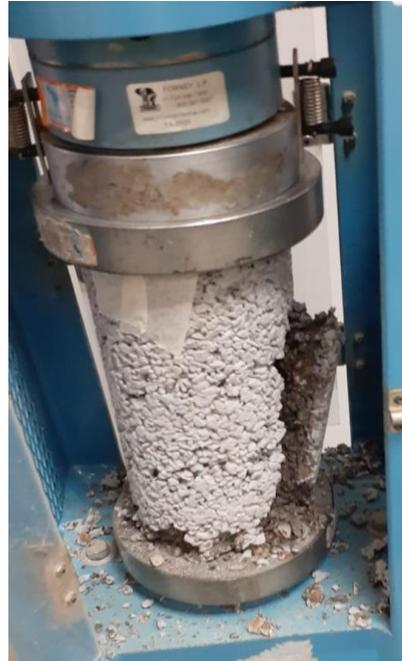
Ensayo a la compresión del concreto permeable con gradación de 1/2" y 3/8"
