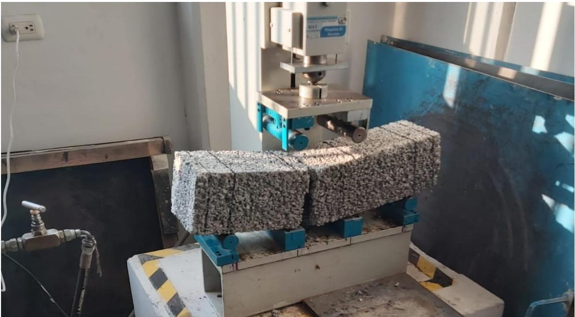
Ensayo a flexión del concreto permeable con gradación de 1/2" y 3/8"
