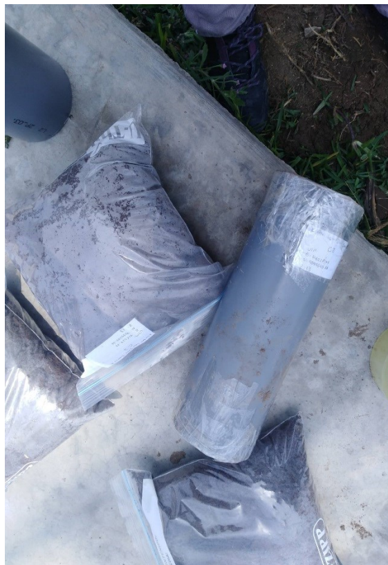
Figura 16: Extracción de la muestra.
