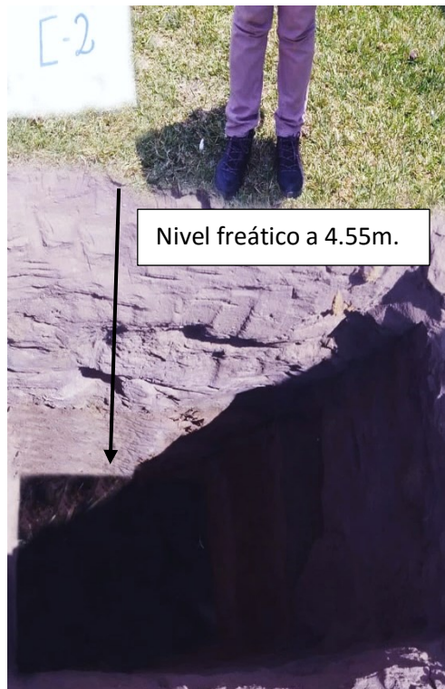
Figura 5: Nivel Freático de la C-2.
