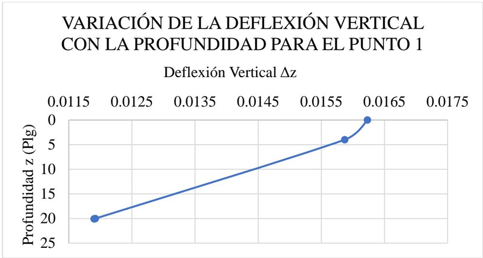
Figura 18: Variación de la deformación vertical con la profundidad en el punto 1.
