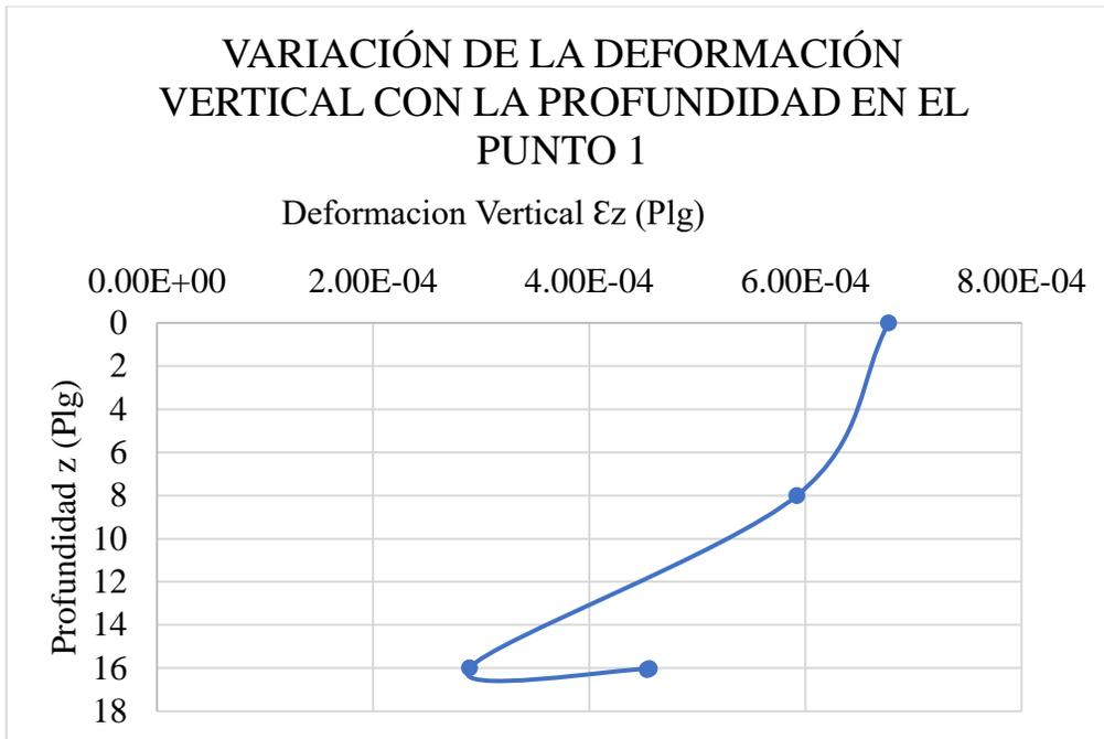
Figura 38: Variación de la deformación vertical con la profundidad en el punto 1, de la propuesta del tramo 2 con eje Simple de Rueda doble.
