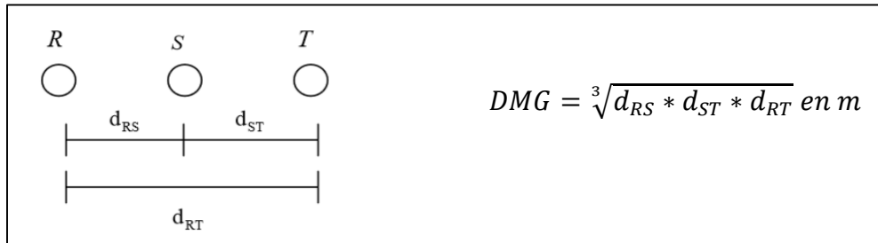
Figura 20. Disposición de los conductores y formula del DMG.
