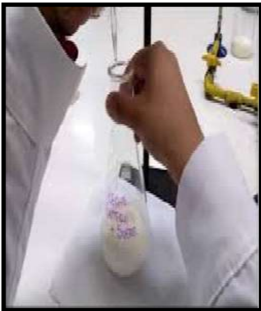
Ilustración 7: Medición de Acidez Titulable en la Leche de Cabra
