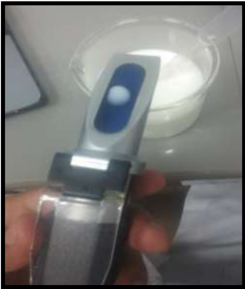
Ilustración 5: Medición de °Brix en la Leche de Cabra
