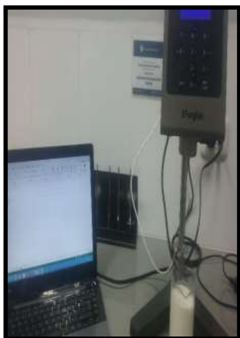
Ilustración 3: Inserción del Usillo N°4 en el Viscosímetro
