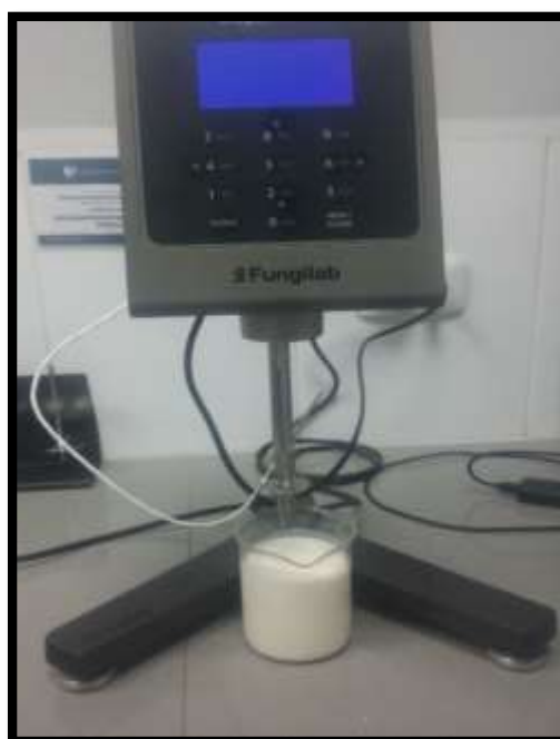
Ilustración 4: Inserción del Controlador del Temperatura
