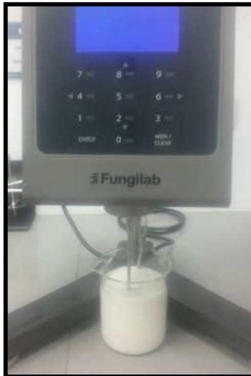
Ilustración 1: Medición de Viscosidades Aparentes
