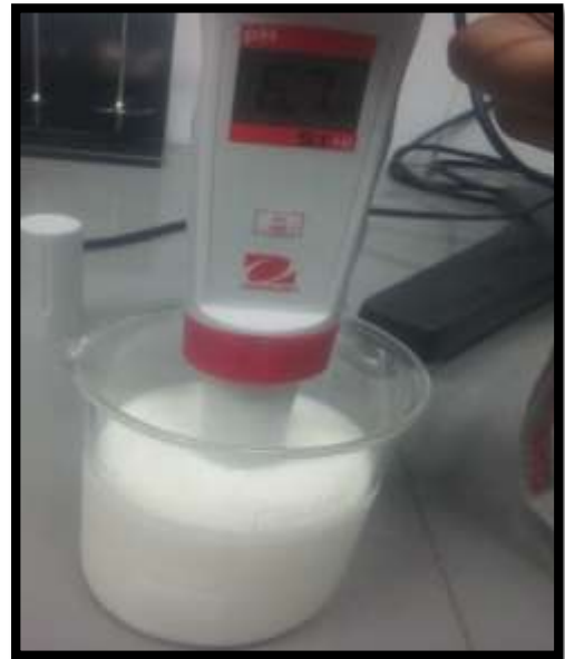
Ilustración 6: Medición de PH de la Leche de Cabra
