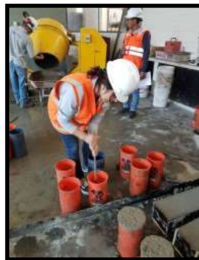
Figura 3.13 Compactación del material
