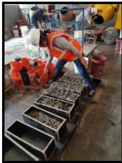
Figura 3.19 Vaciado del Material
