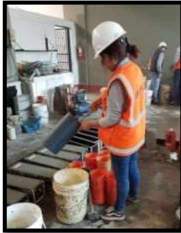
Figura 3.4 Colocación de desmoldante a los moldes de probetas
