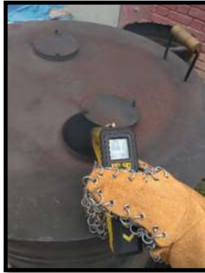
Figura 3.29 Aplicación del Pirómetro en el quemado de las probetas
