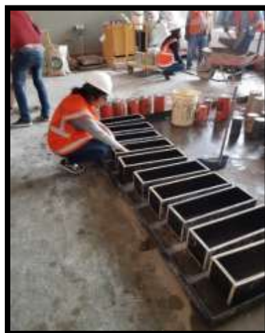
Figura 3.17 Colocación del desmoldante
