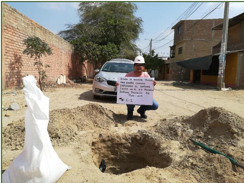
Figura N° 3.7. Excavación a 1.50 m para extracción de muestra
