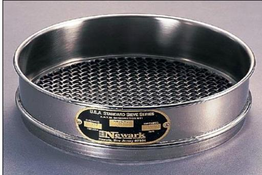
Figura 3. Tamiz N° 4 con malla de 4.75mm
