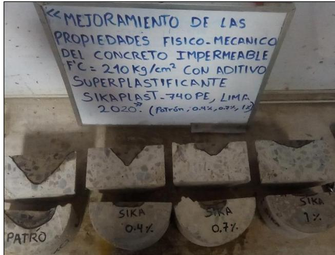
Figura 25. Ensayo de penetración de agua bajo presión constante.
