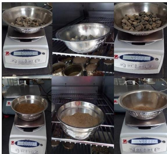
Figura 20. Pasos para el contenido de humedad de los agregados
