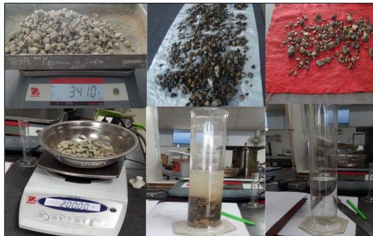
Figura 17. Pasos para el peso específico del A.G.
