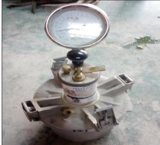
Figura 11. Instrumento de ensayo del contenido de aire.
