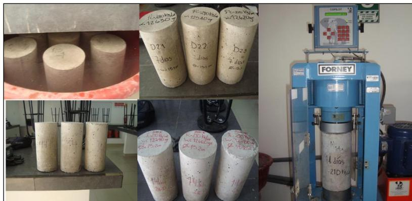
Figura 26. Ensayo de Resistencia a la compresión.
