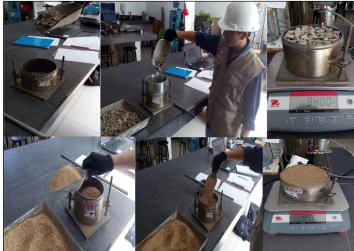
Figura 21. Pasos para P.U.S de los agregados
