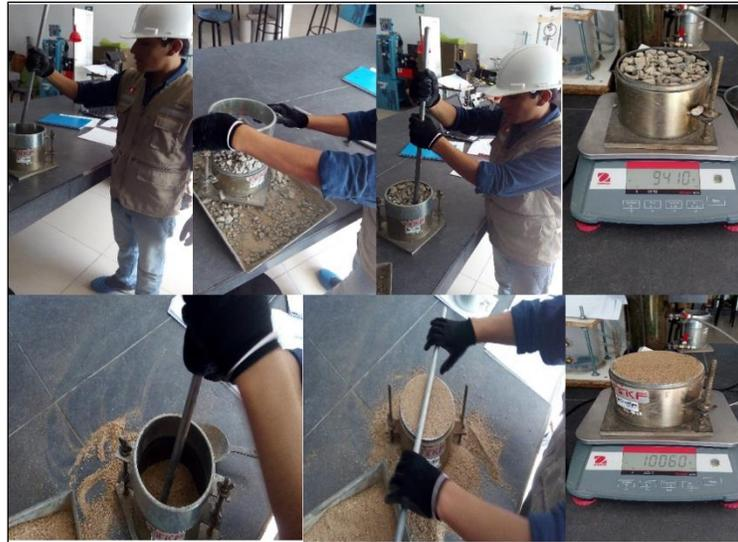
Figura 22. Pasos del PUS y PUC de los agregados
