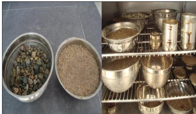
Figura 19. Paso para el contenido de absorción
