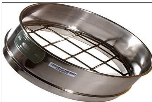
Figura 4. Tamiz N°3/8" con malla de 9.52mm
