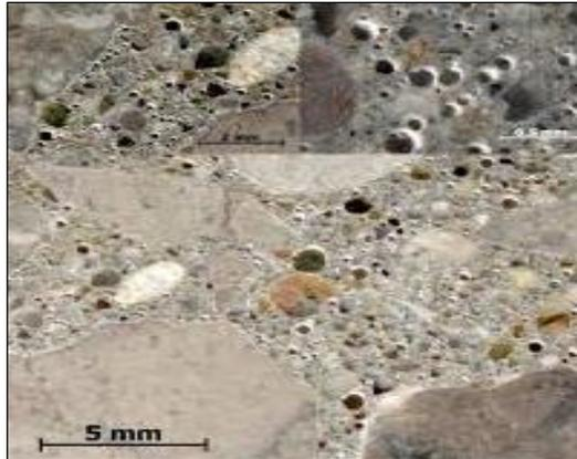
Figura 10. Sistema de aire ocluido en el concreto.
