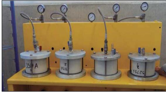
Figura 14. Método de permeabilidad del concreto.
