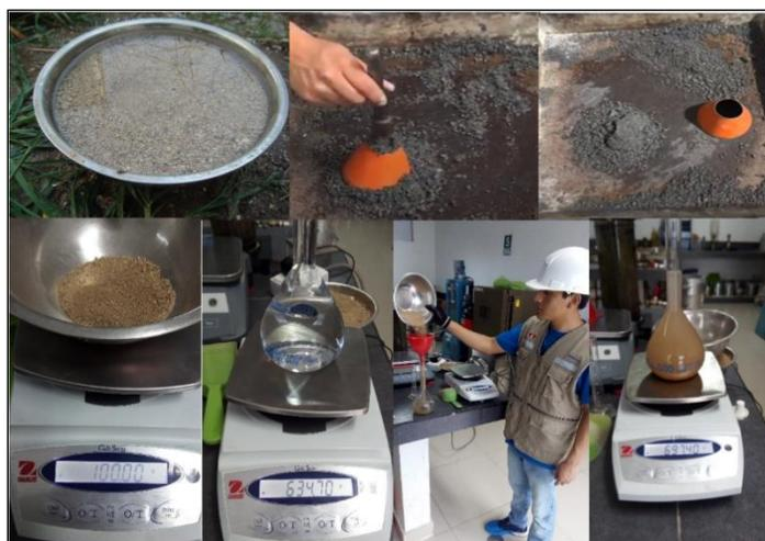
Figura 18. Pasos para el peso específico del A.F
