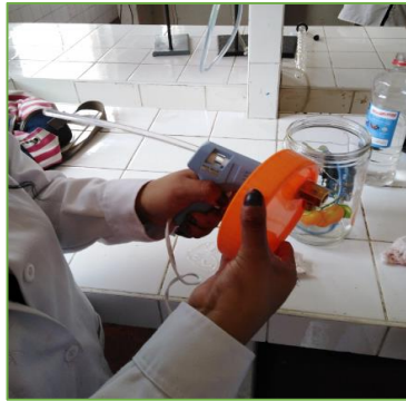
Ensamblaje de la las válvulas y la manguera al recipiente receptor del hidrógeno
