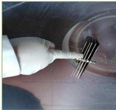
Armado de los electrodos, con material acero inoxidable
