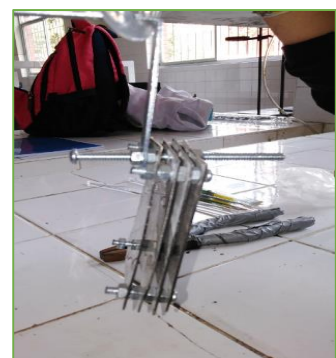
Armado de los electrodos, con material acero inoxidable
