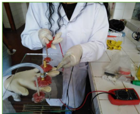
Prueba de continuidad de los electrodos.
