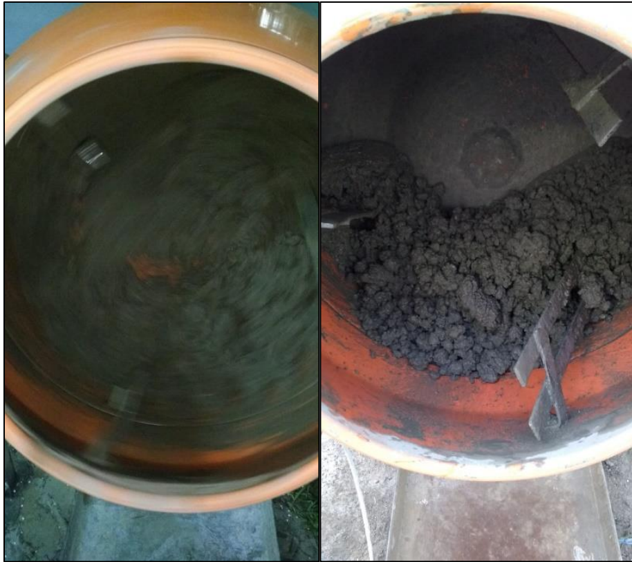
Figura 21: Mezclado de concreto base
