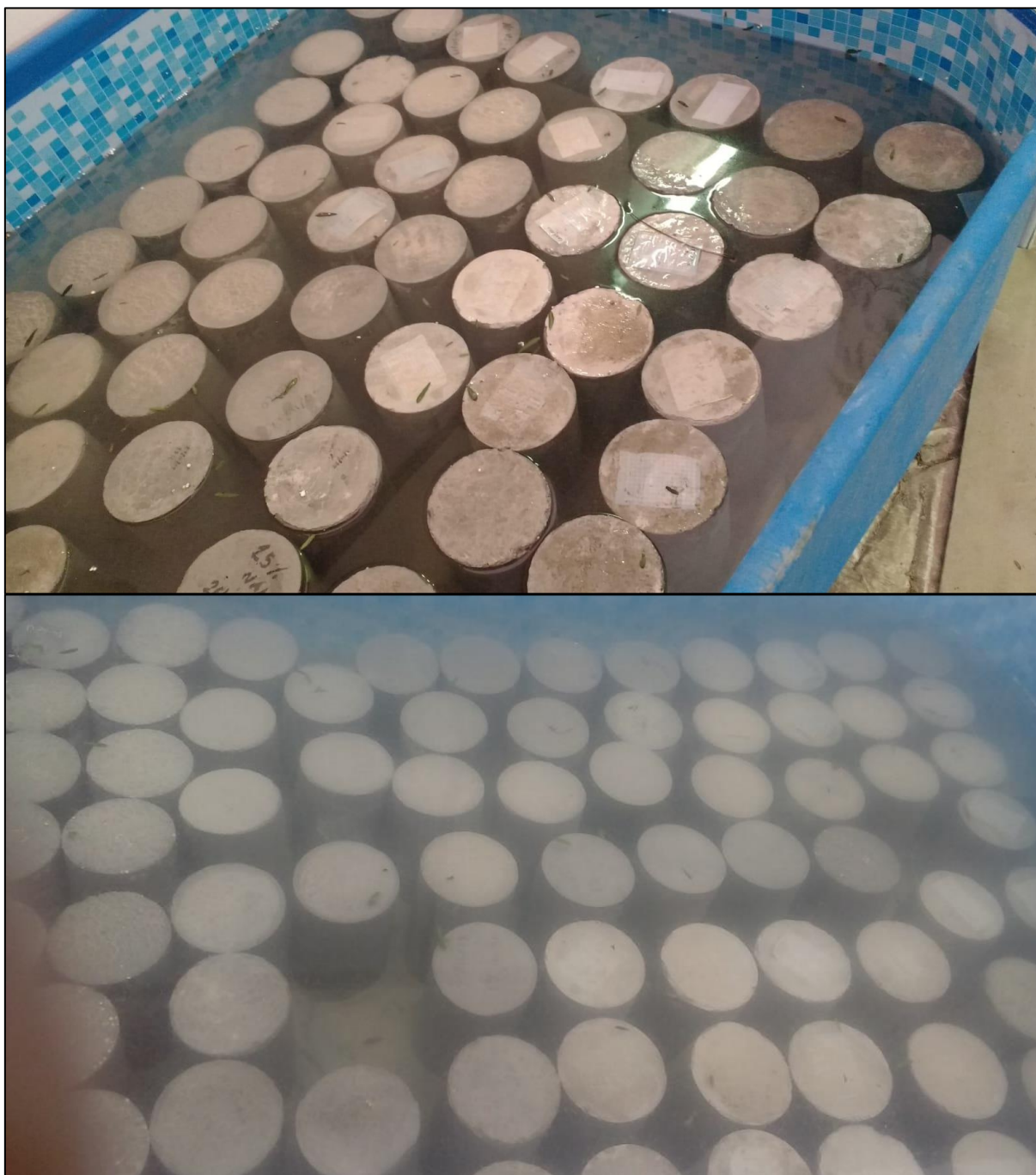
Figura 42: Curado de probetas de concreto
