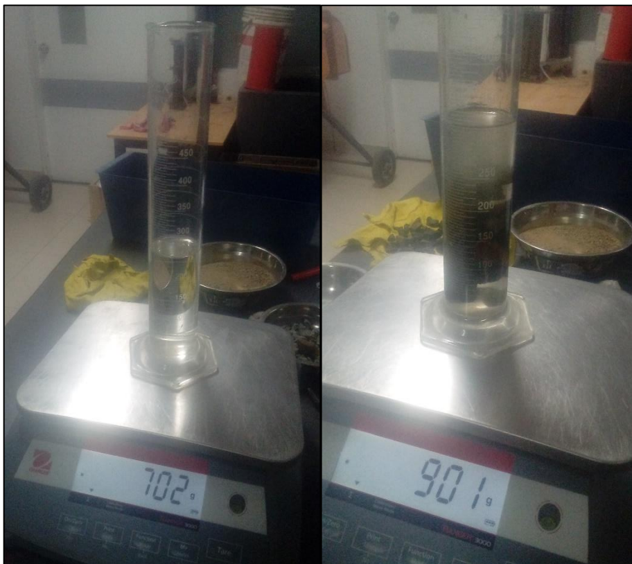
Figura 9: Ensayo laboratorio Peso específico agregado grueso
