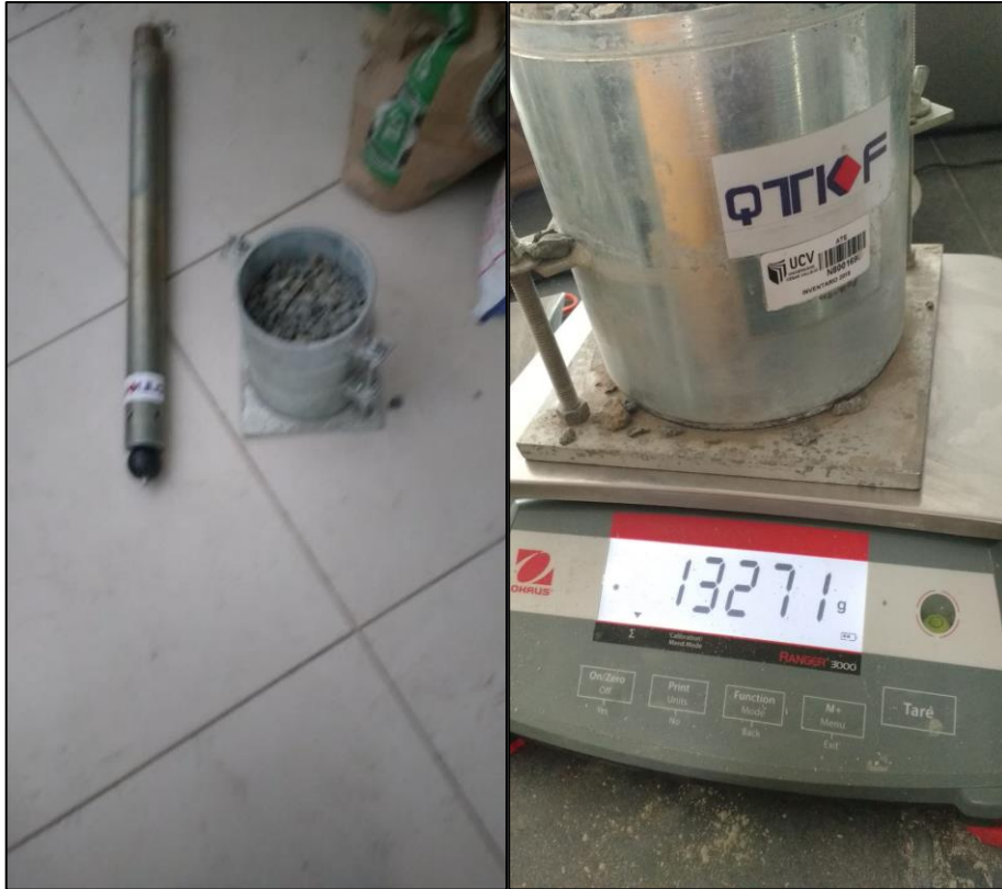
Figura 8: Ensayo laboratorio - Peso unitario suelto y compactado de agregados
