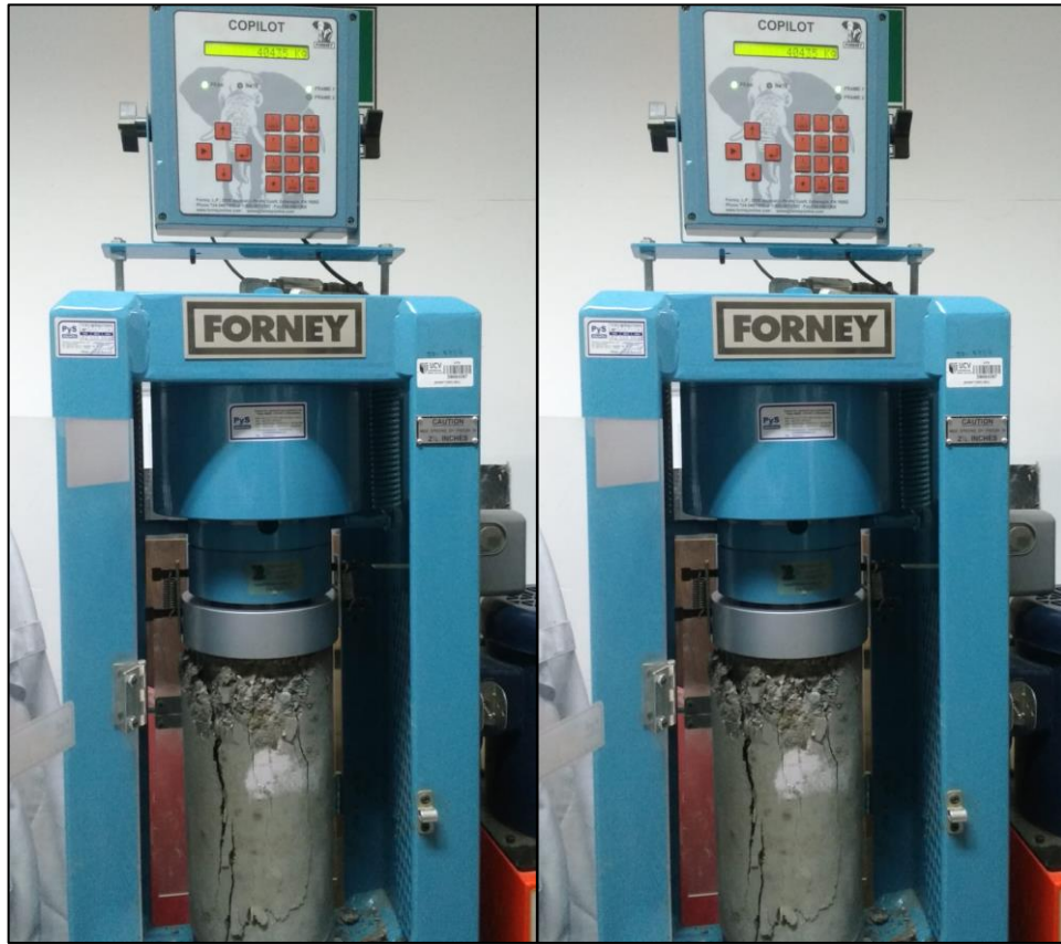
Figura 64: Muestra de resultados - Ensayo de compresión (1 día - 2.0% Nano-sílíce)
