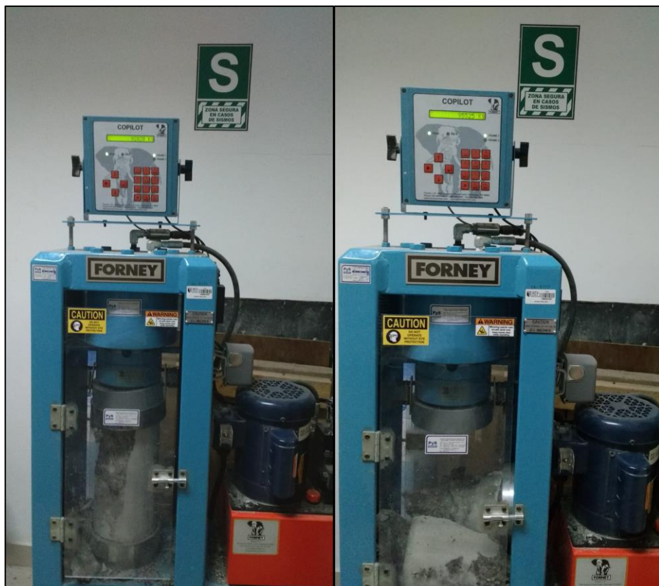
Figura 69: Muestra de resultados - Ensayo de compresión (28 días - 2.0% Nano-sílíce)
