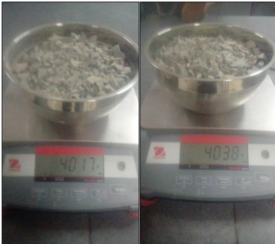
Figura 13: Ensayo laboratorio - Contenido de Humedad agregado Grueso
