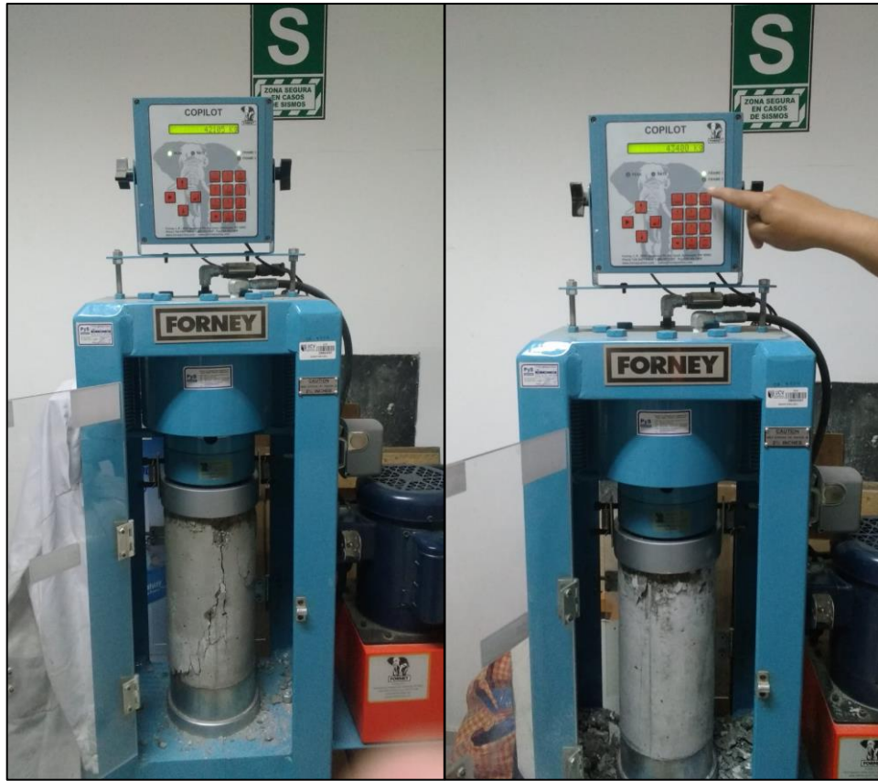
Figura 46: Muestra de resultados - Ensayo de compresión (1 día- 0.5% Nano-sílíce)
