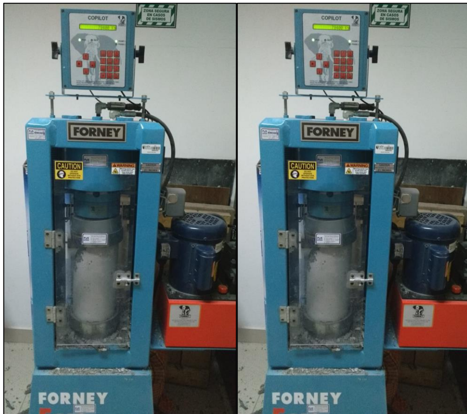
Figura 51: Muestra de resultados - Ensayo de compresión (28 días- 0.5% Nano-sílice)
