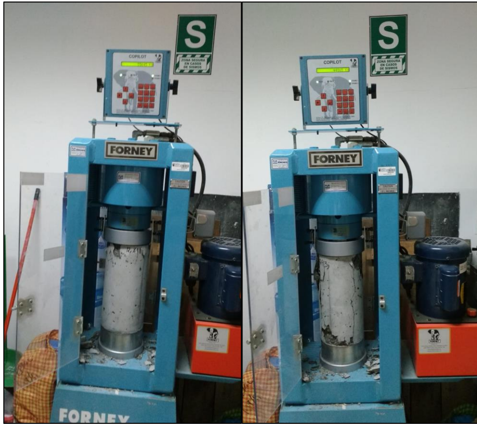
Figura 54: Muestra de resultados - Ensayo de compresión (7 días- 1.0% Nano-sílice)
