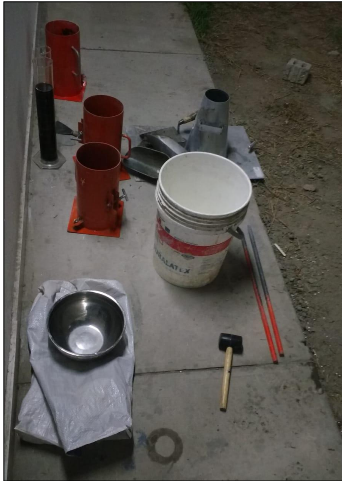
Figura 28: Equipo para ensayo asentamiento y elaboración de probetas
