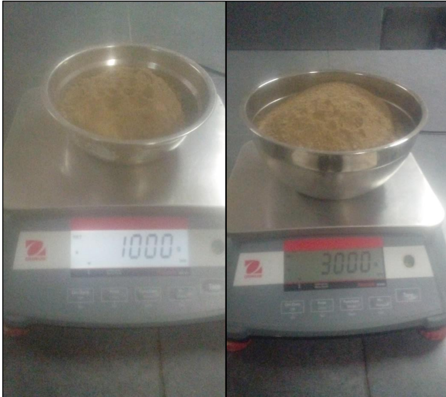
Figura 12: Ensayo laboratorio - Contenido de Humedad agregado fino
