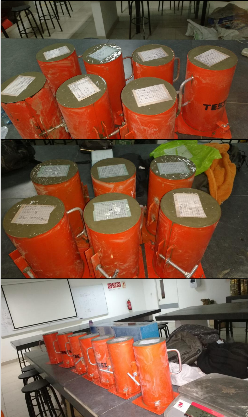
Figura 40: Muestra de tandas de elaboración de probetas de concreto
