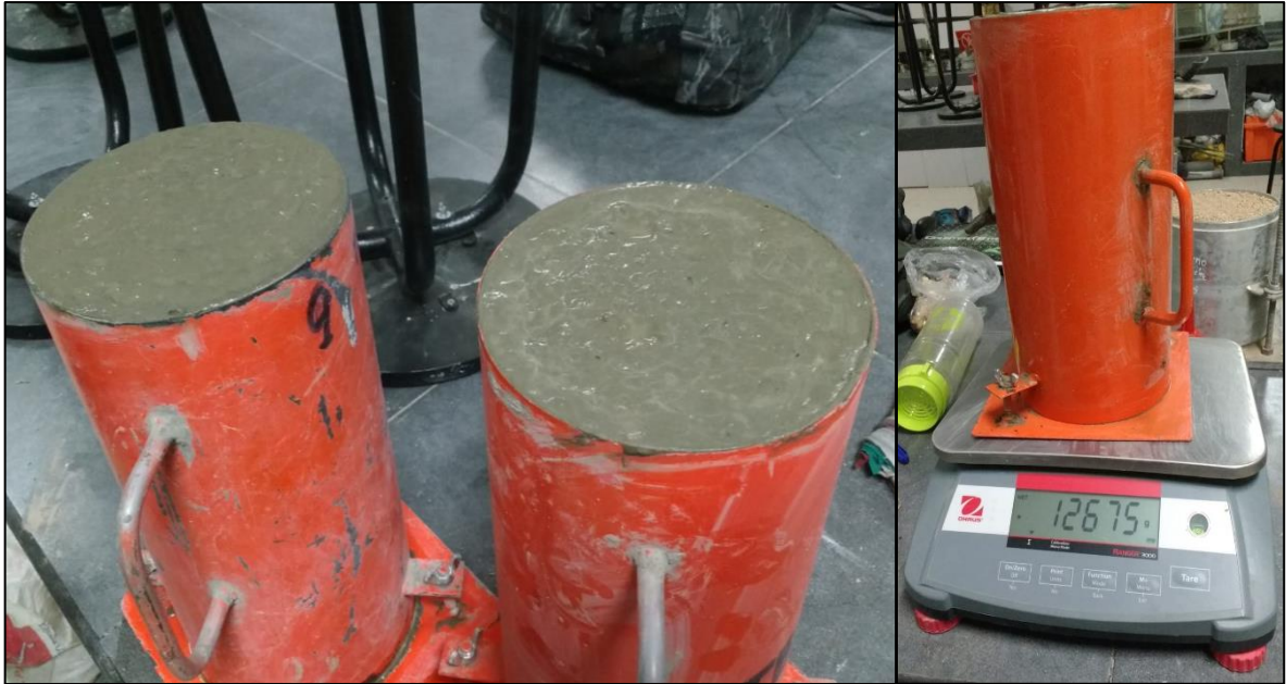
Figura 30: Ensayo de Peso unitario del concreto mediante moldes normalizados.
