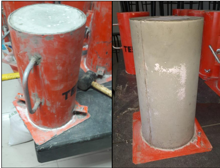
Figura 41: Desmolde de probetas de concreto
