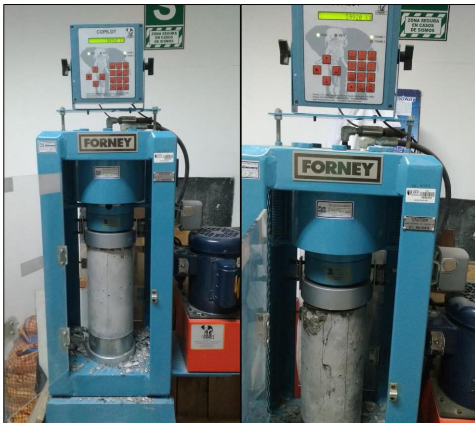
Figura 59: Muestra de resultados - Ensayo de compresión (7 días - 1.5% Nano-sílice)
