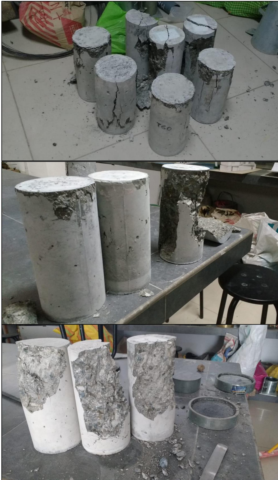
Figura 74: Muestra de probetas de concretos ensayados.
