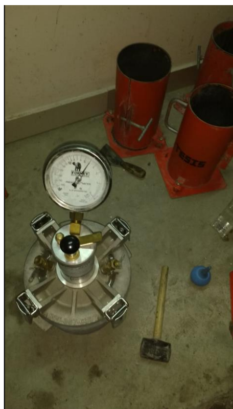
Figura 36: Ensayo de contenido de aire del concreto mediante la olla de Washington – Nano-sílice 2.0%
