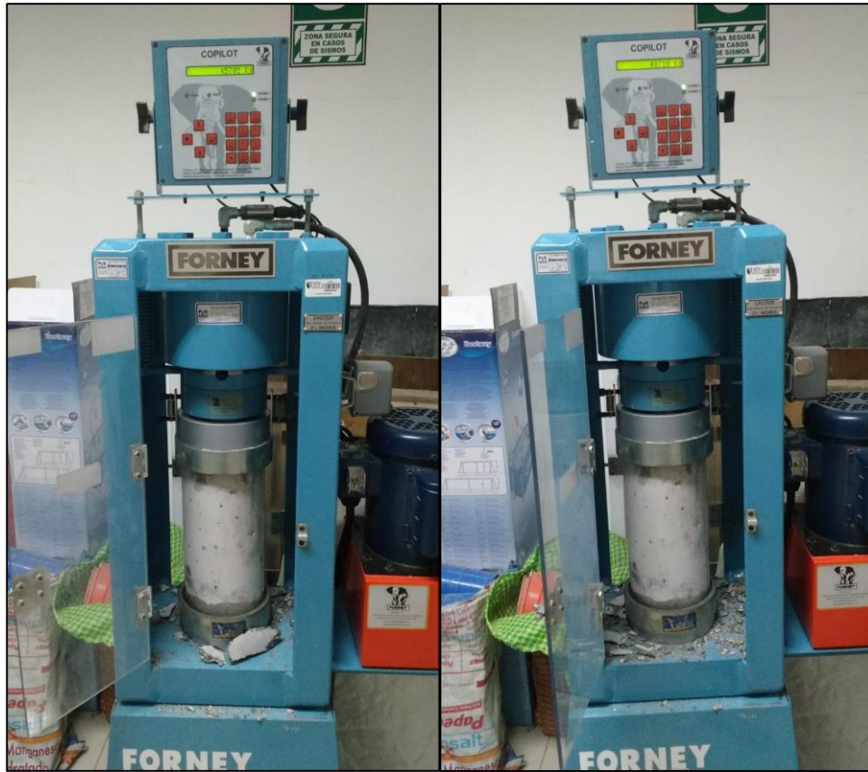
Figura 58: Muestra de resultados - Ensayo de compresión (3 días - 1.5% Nano-sílice)
