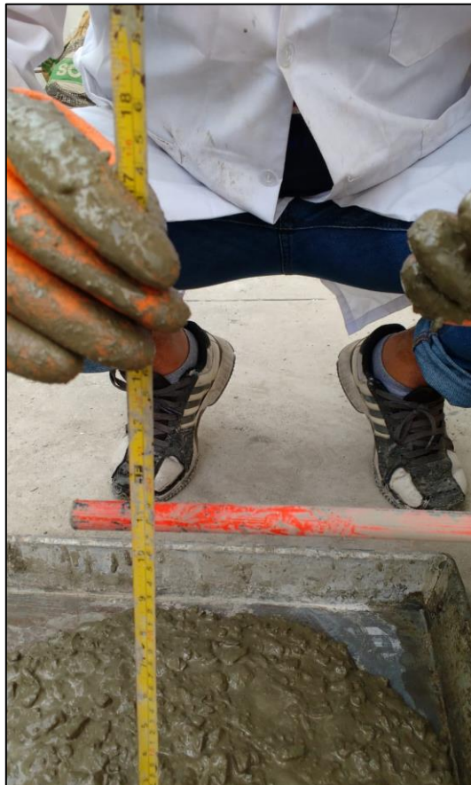
Figura 27: Ensayo asentamiento - 2.0% Nano-silíce
