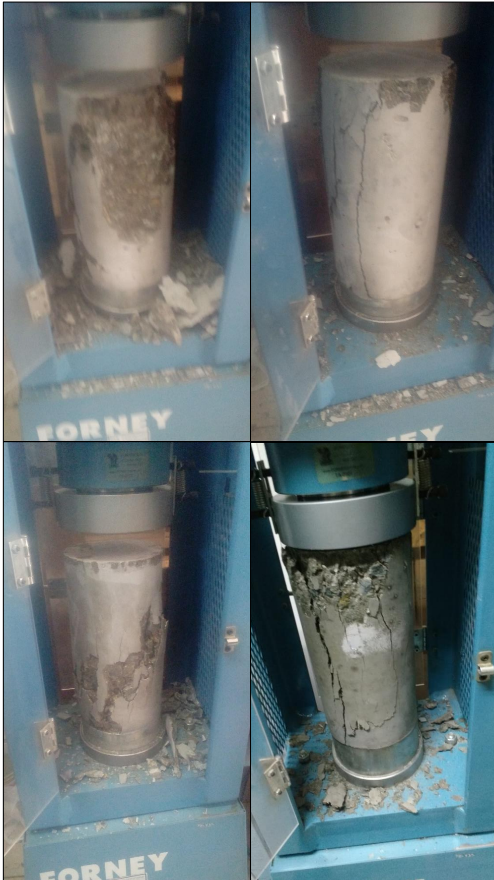
Figura 72: Tipo de roturas de probetas ensayadas.
