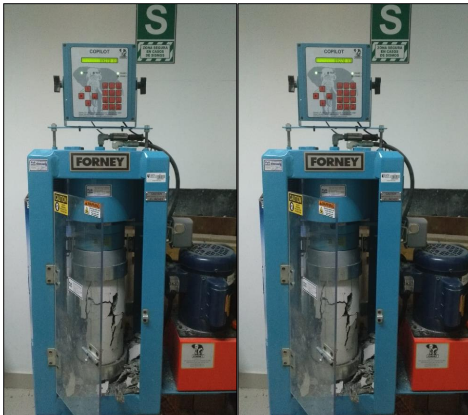
Figura 63: Muestra de resultados - Ensayo de compresión (28 días - 1.5% Nano-sílice)
