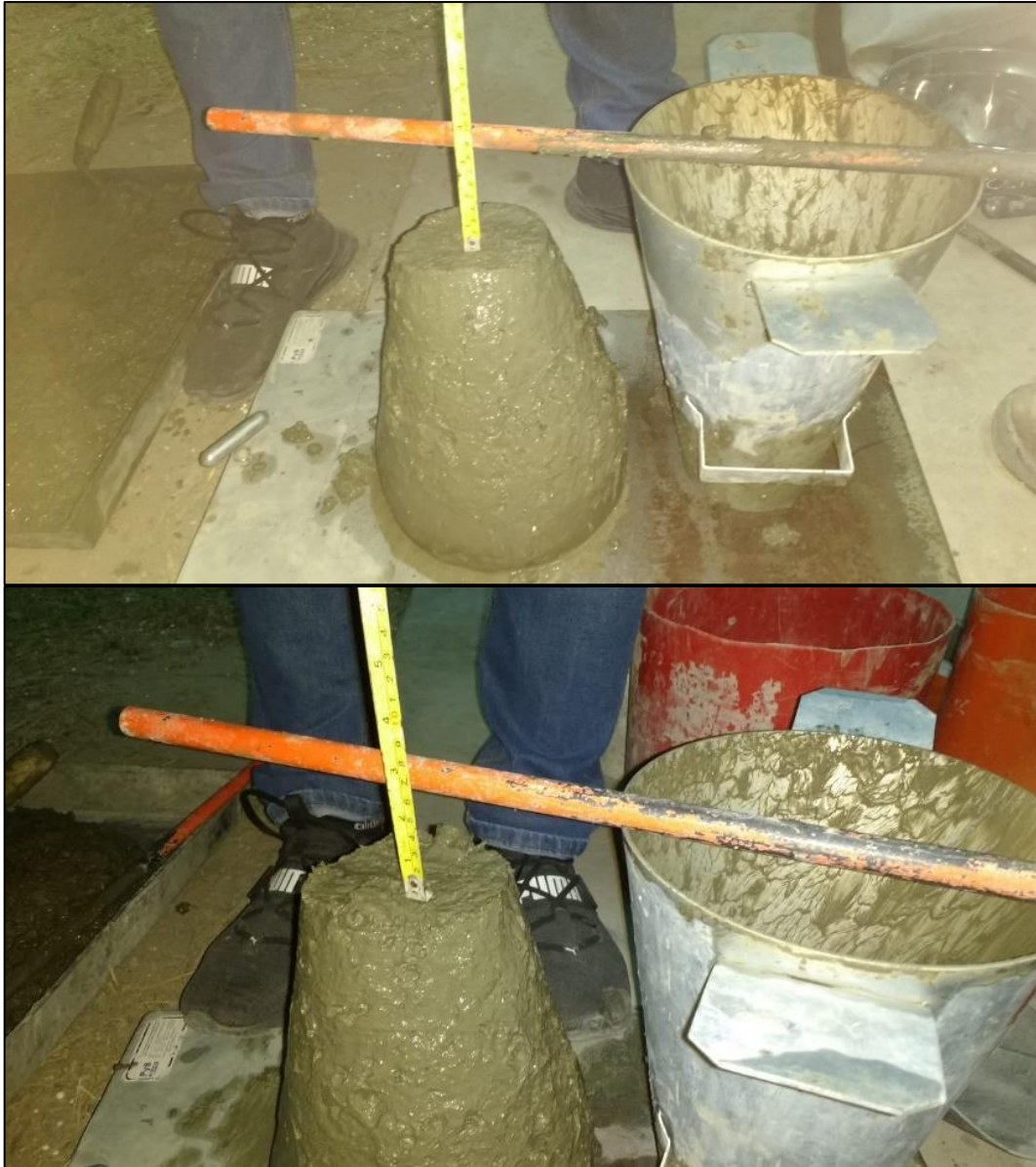
Figura 23: Ensayo Asentamiento - Concreto base
