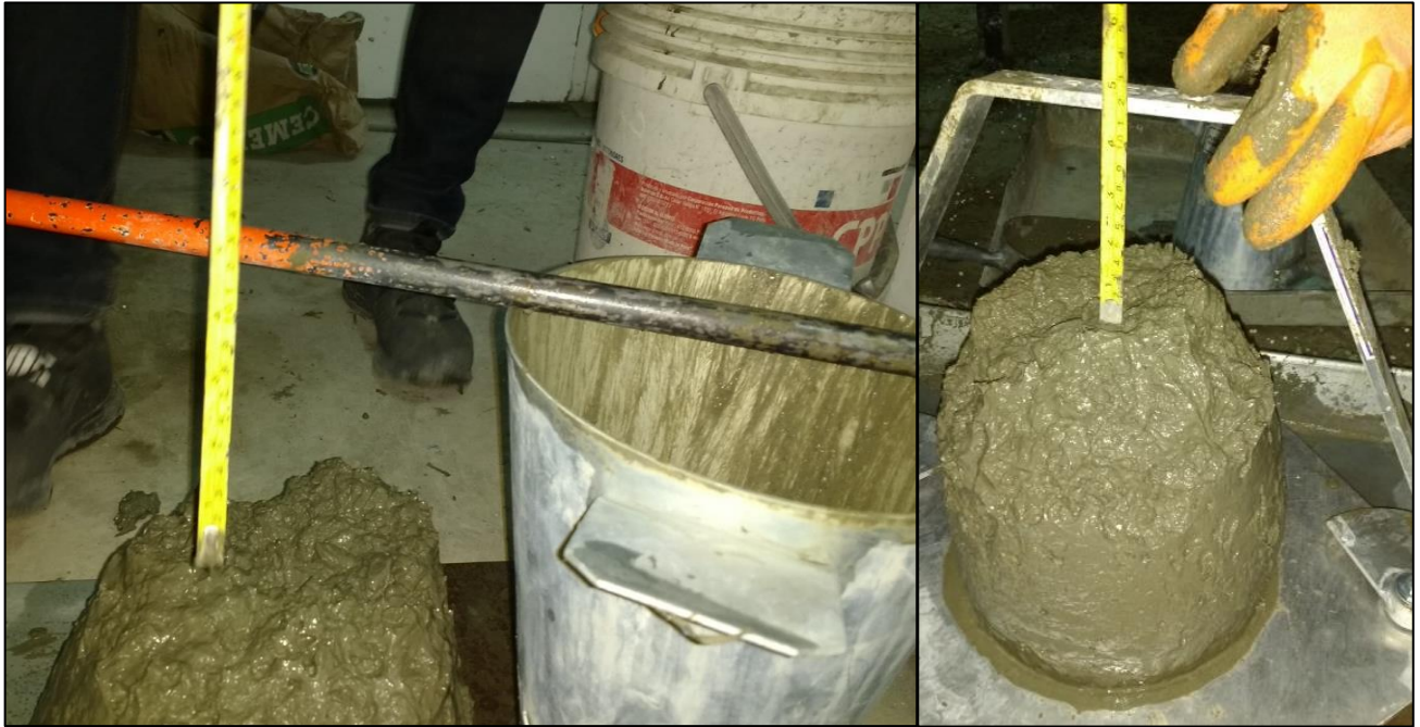
Figura 24: Ensayo asentamiento - 0.5% Nano-silice
