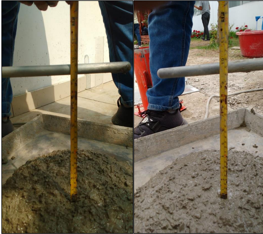
Figura 26: Ensayo asentamiento - 1.5% Nano-silíce
