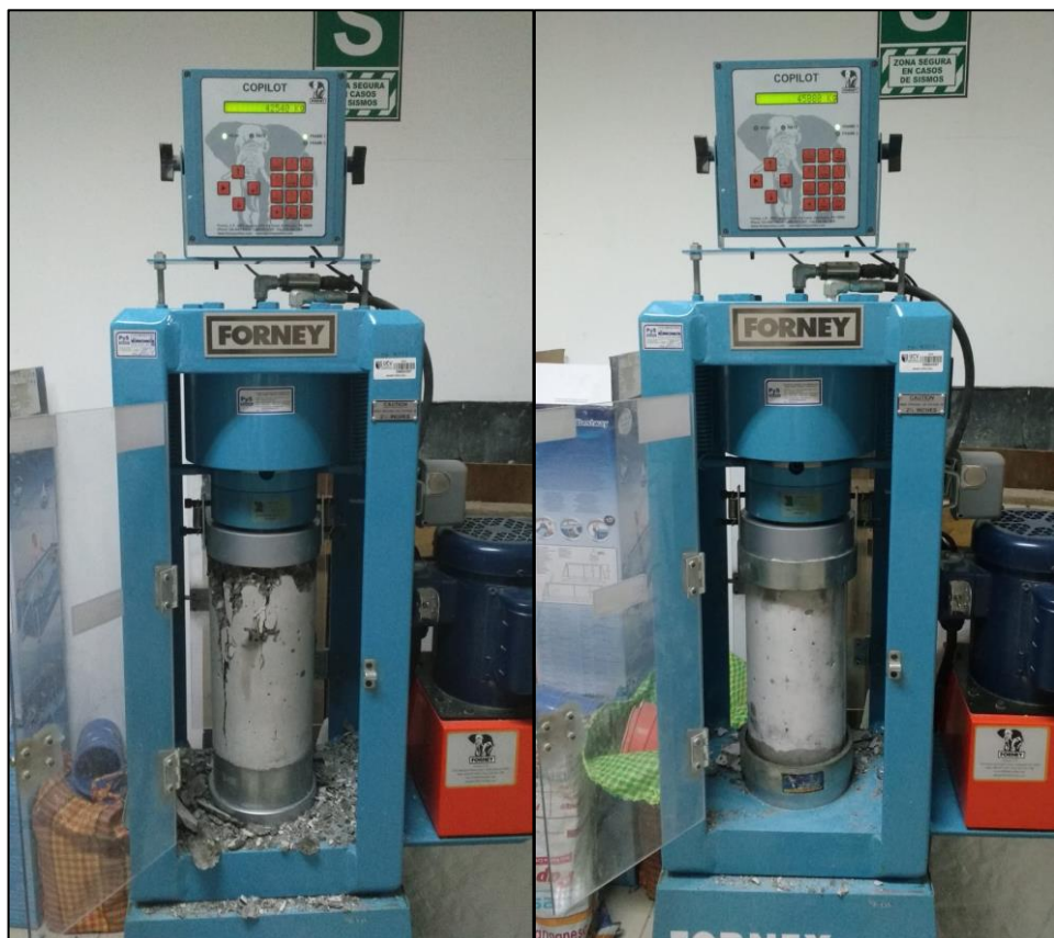
Figura 47: Muestra de resultados - Ensayo de compresión (3 días- 0.5% Nano-sílíce)
