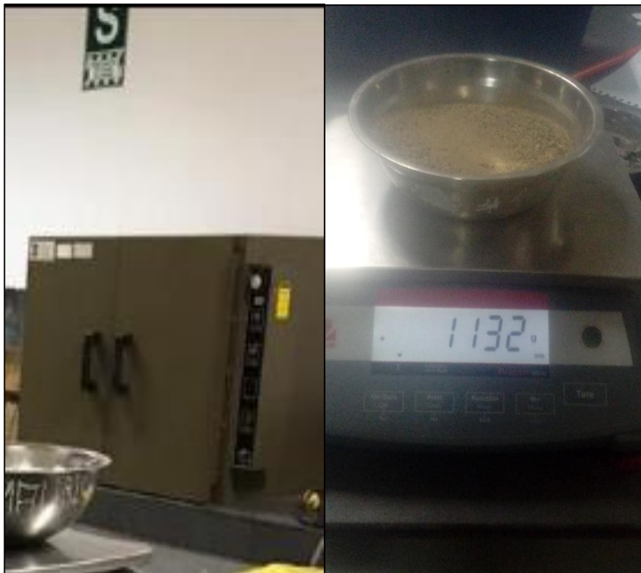
Figura 11: Horno para secado de agregados
