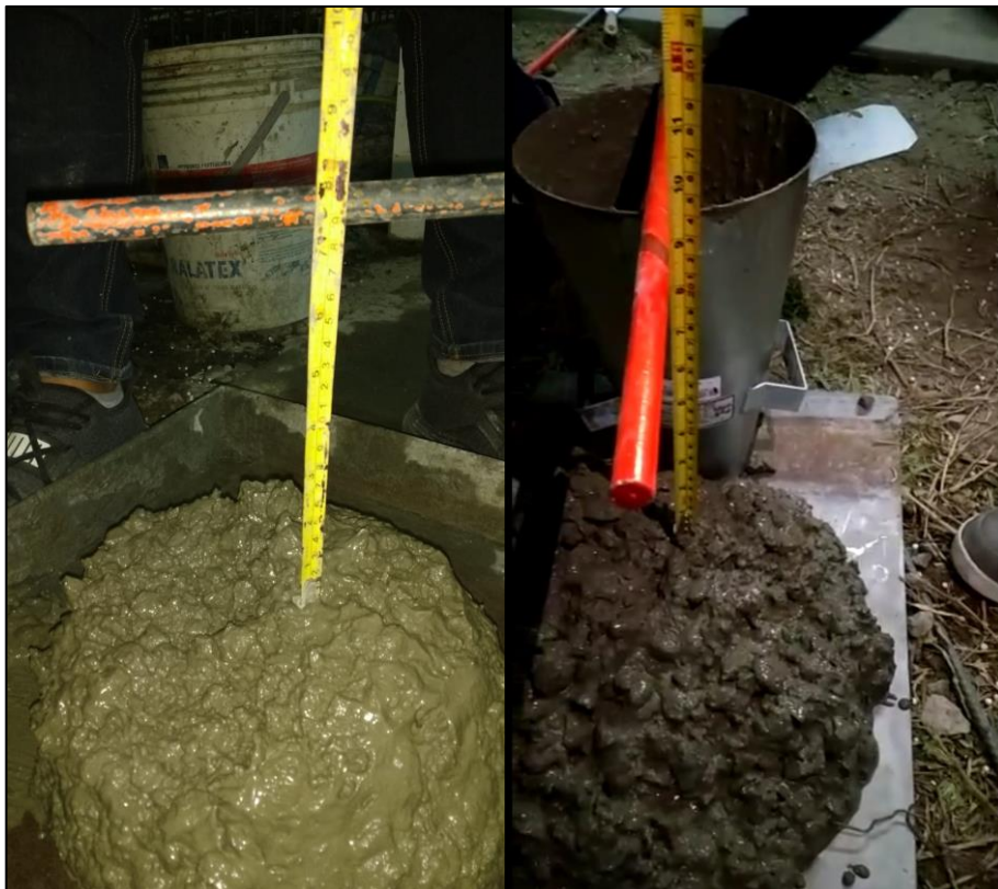
Figura 25: Ensayo asentamiento - 1.0% Nano-silice
