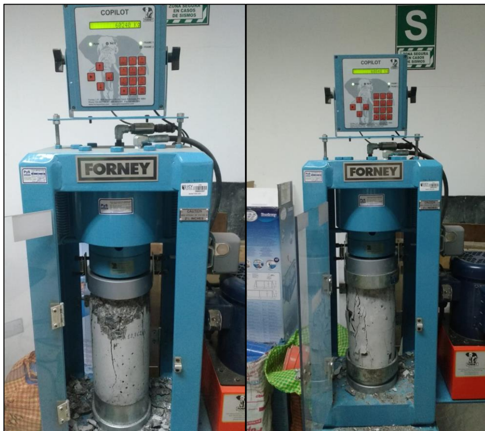
Figura 65: Muestra de resultados - Ensayo de compresión (3 días - 2.0% Nano-sílíce)
