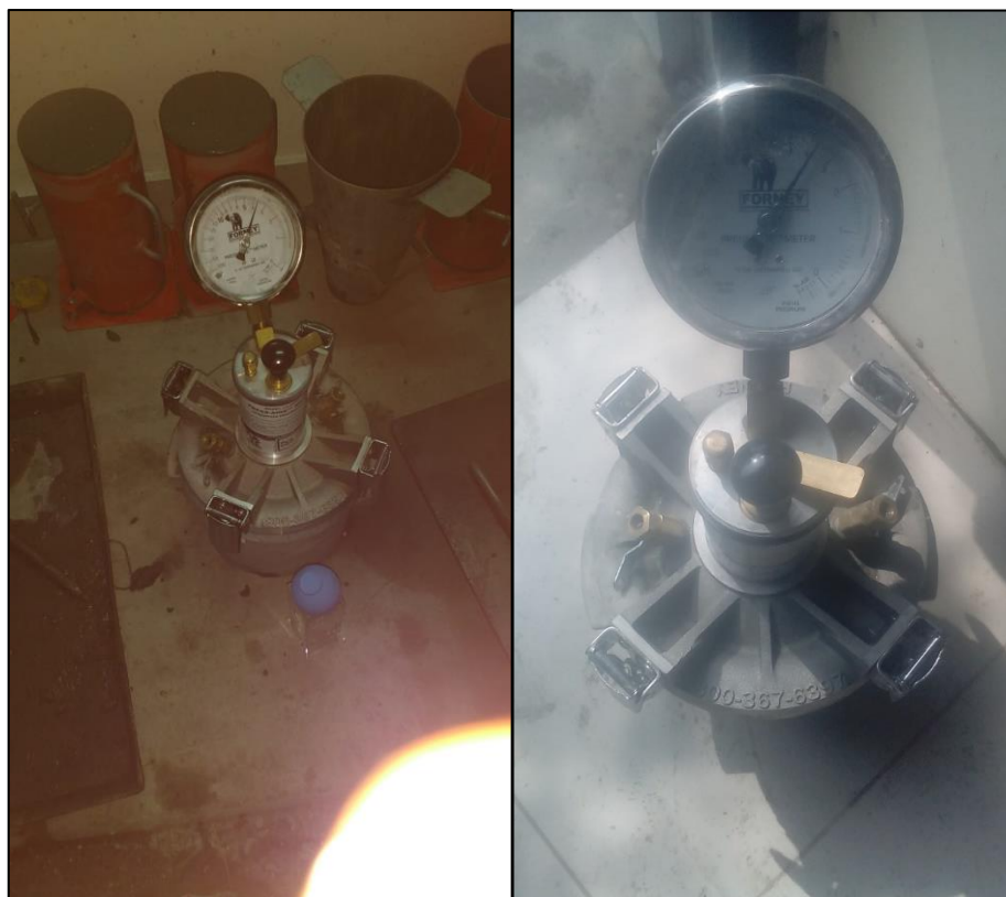
Figura 35: Ensayo de contenido de aire del concreto mediante la olla de Washington – Nano-sílice 1.5%
