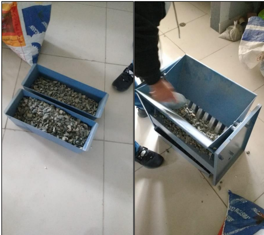
Figura 6: Cuarteo de Agregados y separación de muestras
