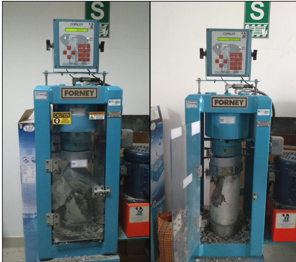
Figura 68: Muestra de resultados - Ensayo de compresión (14 días - 2.0% Nano-sílíce)
