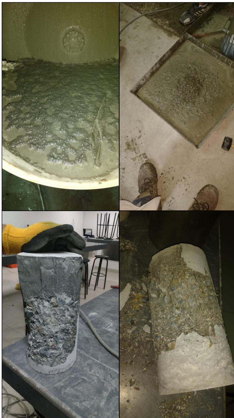
Figura 75: Falla por segregación durante primeros ensayos
