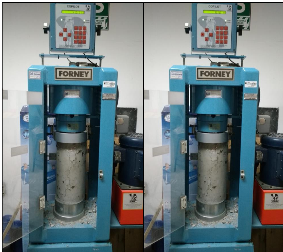
Figura 57: Muestra de resultados - Ensayo de compresión (1 día- 1.5% Nano-sílice)
