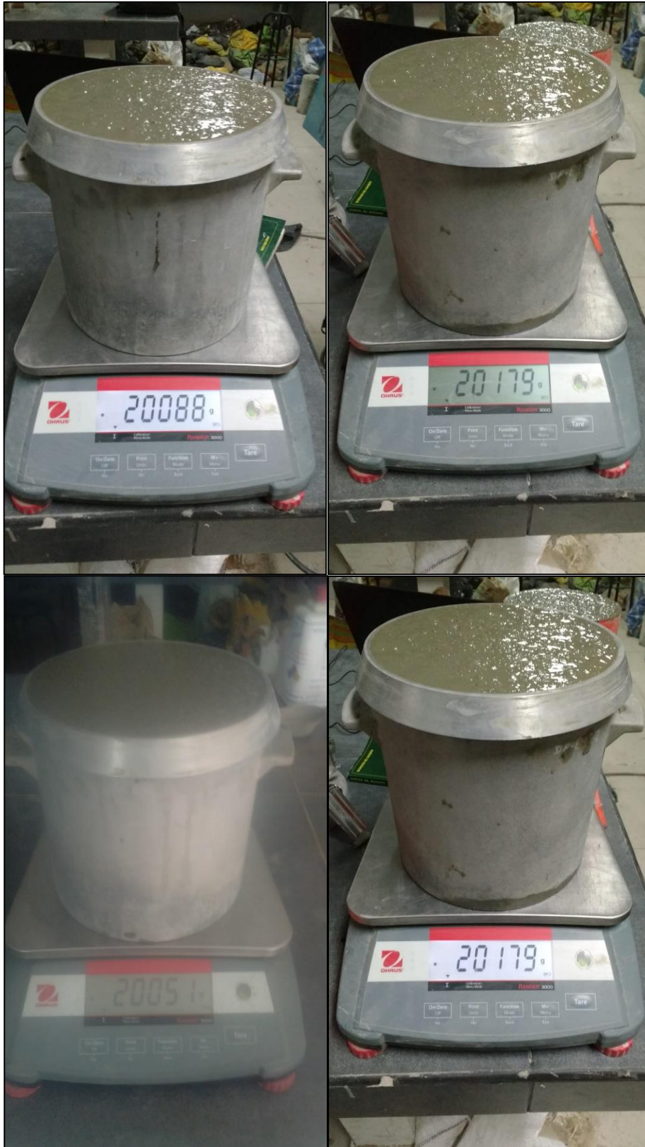
Figura 32: Ensayo de Peso unitario del concreto mediante Olla de Washington
