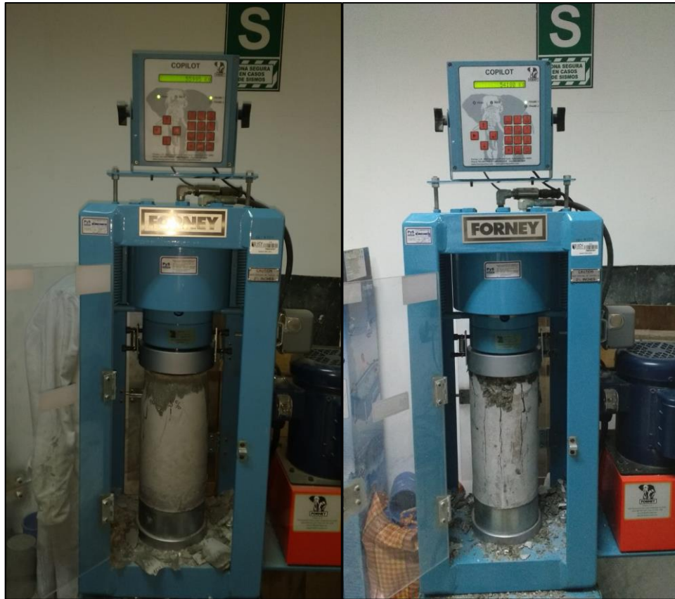
Figura 50: Muestra de resultados - Ensayo de compresión (14 días- 0.5% Nano-sílice)
