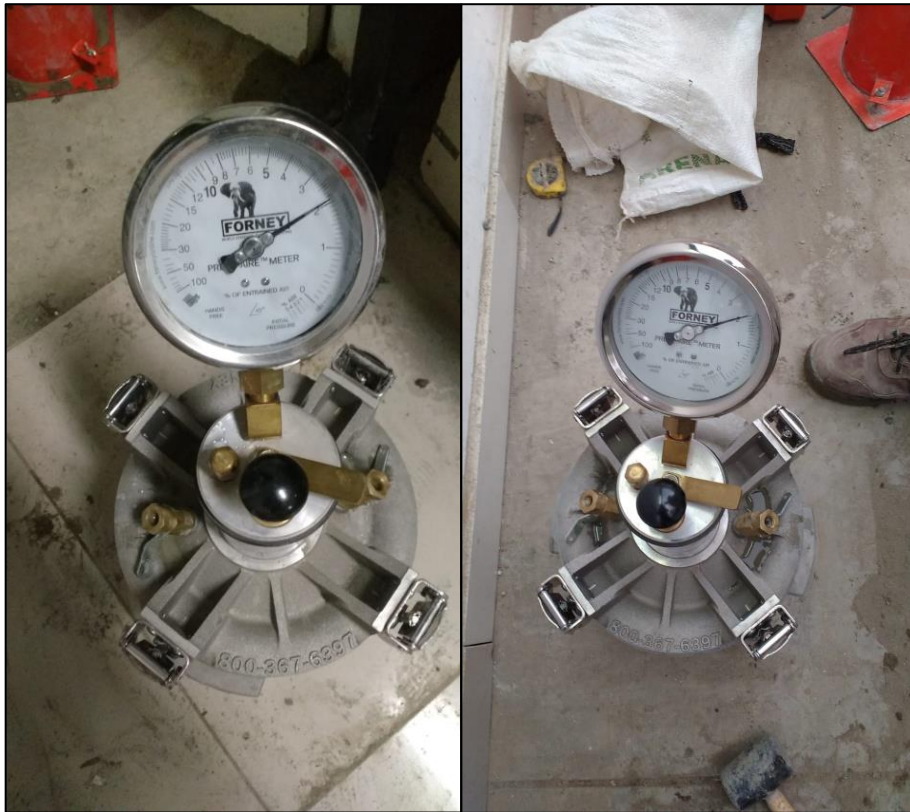
Figura 33: Ensayo de contenido de aire del concreto mediante la olla de Washington – Nano-silíce 0.5%
