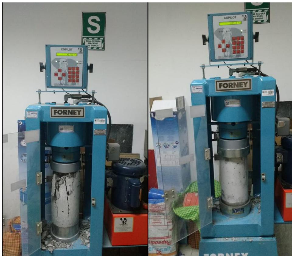
Figura 49: Muestra de resultados - Ensayo de compresión (7 días- 0.5% Nano-sílice)
