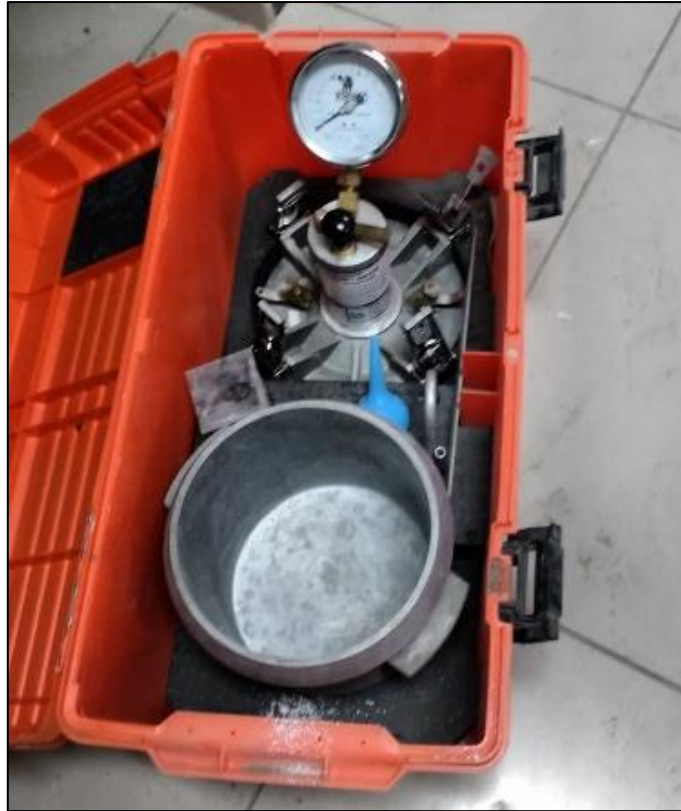
Figura 37: Olla de Washington para ensayo de Peso Unitario y Contenido de aire
