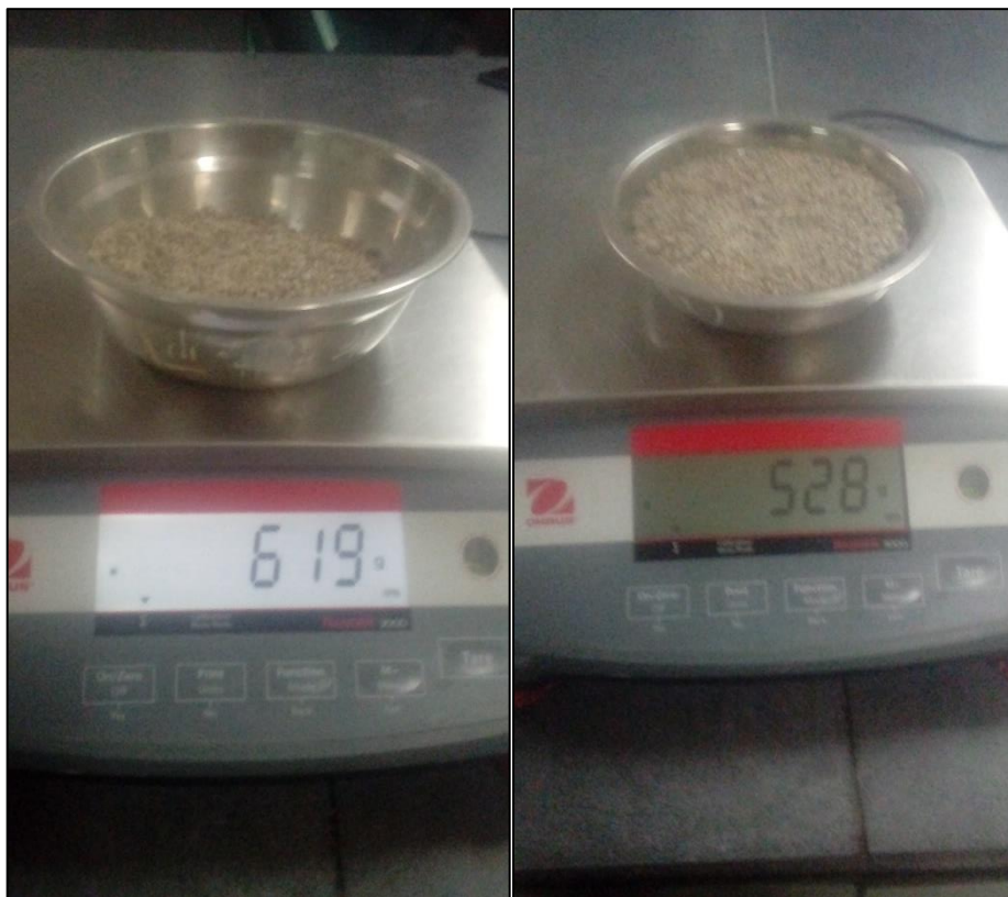
Figura 15: Ensayo laboratorio de absorción - Agregado fino
