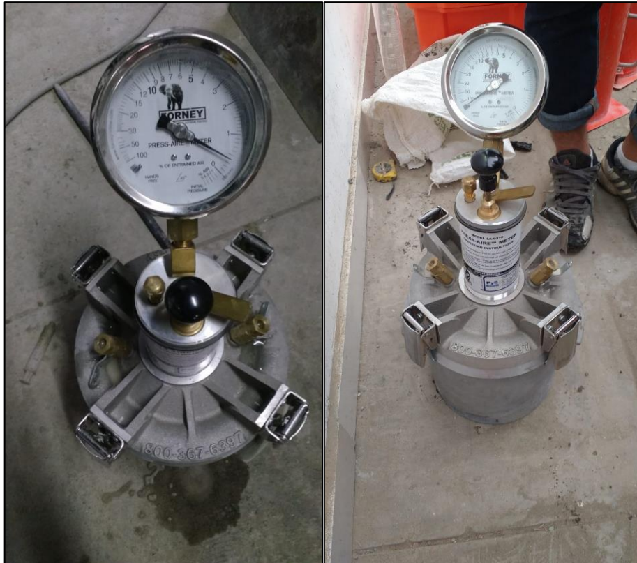
Figura 38: Olla de Washington para Contenido de aire
