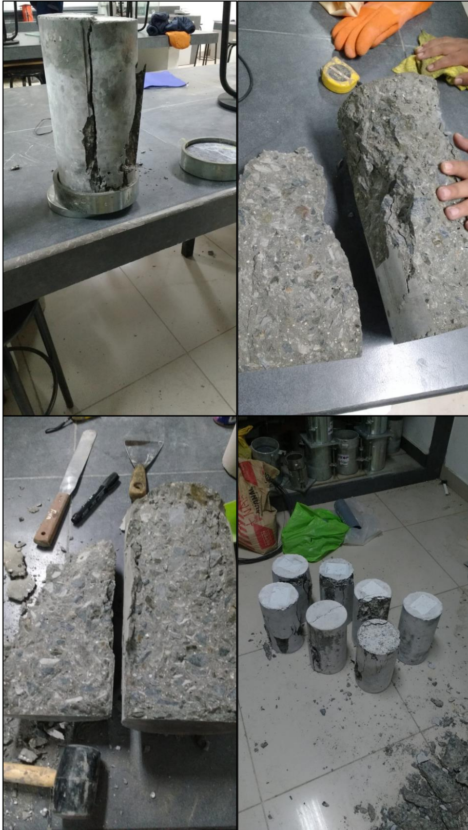
Figura 73: Muestra de los agregados distribuidos internamente en el concreto.
