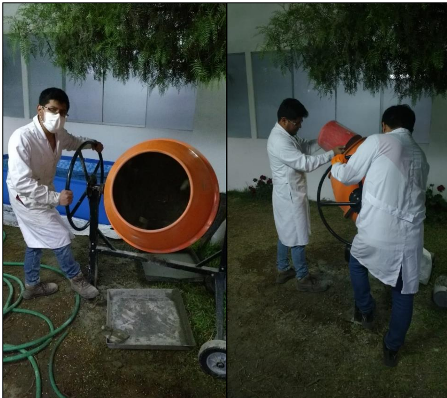
Figura 20: Procedimiento de elaboración de mezclas de concreto
