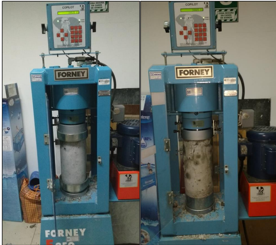
Figura 52: Muestra de resultados - Ensayo de compresión (1 día- 1.0% Nano-sílice)
