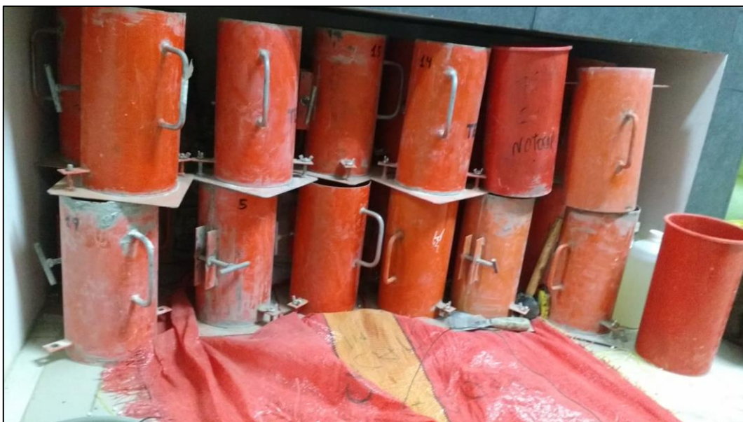
Figura 29: Molde normalizadas para probetas de concreto
