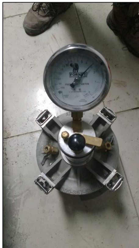
Figura 34: Ensayo de contenido de aire del concreto mediante la olla de Washington – Nano-silíce 1.0%
