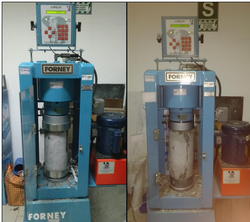
Figura 67: Muestra de resultados - Ensayo de compresión (7 días - 2.0% Nano-sílíce)
