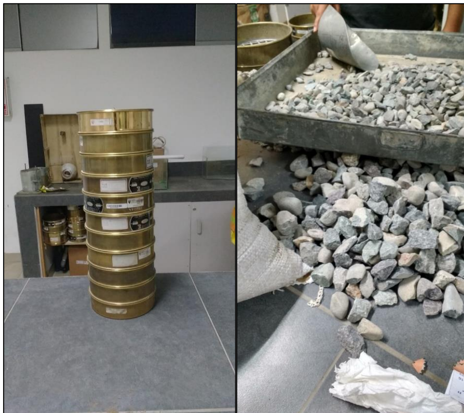
Figura 7: Ensayo de Tamizado - Agregados
