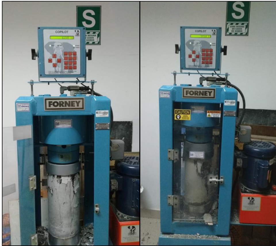
Figura 60: Muestra de resultados - Ensayo de compresión (7 días - 1.5% Nano-sílíce)
