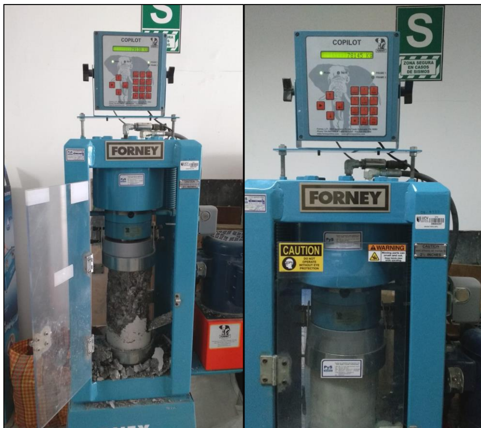
Figura 61: Muestra de resultados - Ensayo de compresión (14 días - 1.5% Nano-sílíce)
