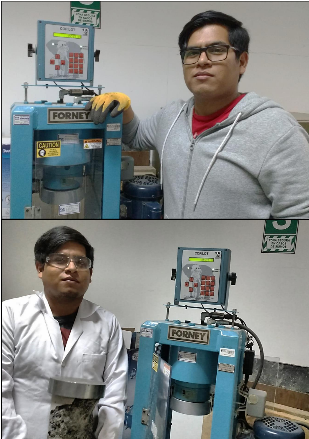
Figura 70: Ensayo de compresión y toma de datos
