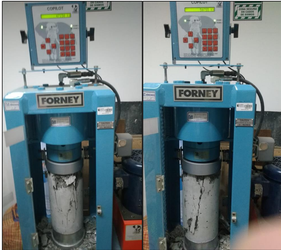
Figura 48 Muestra de resultados - Ensayo de compresión (7 días- 0.5% Nano-sílice)
