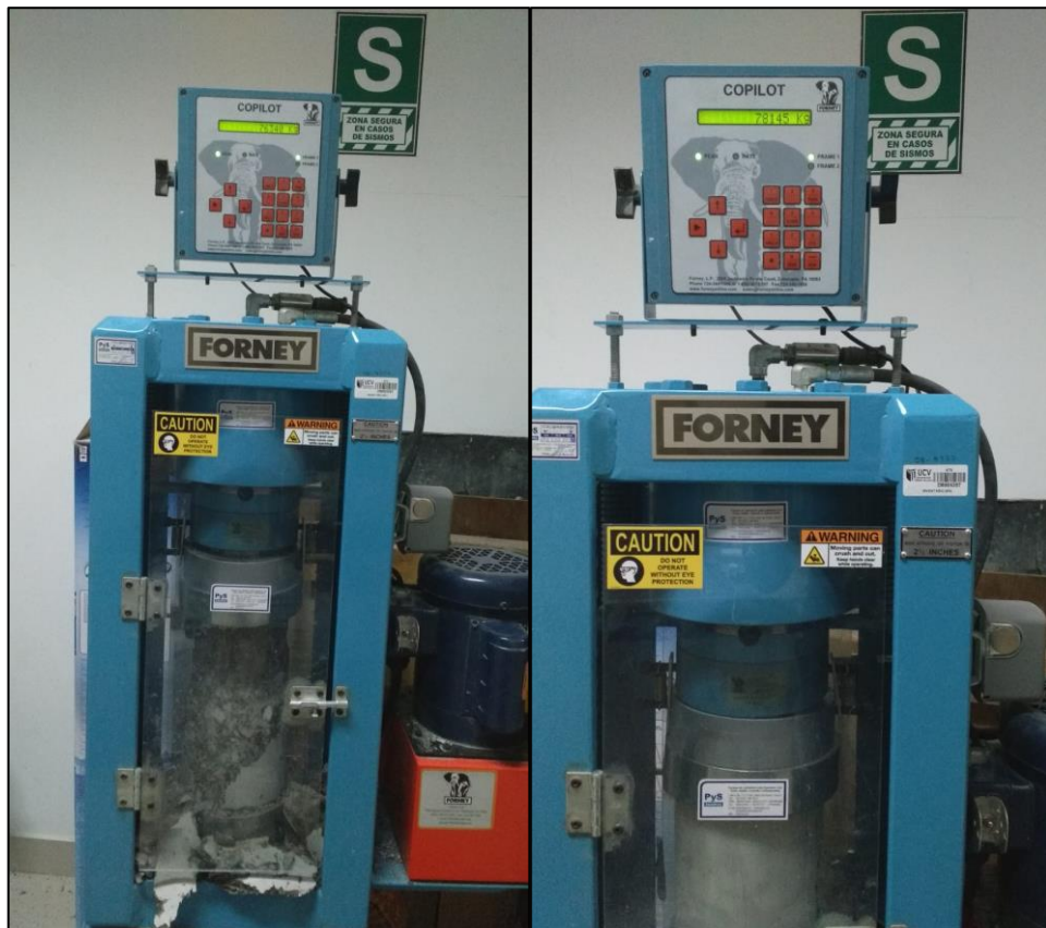
Figura 55: Muestra de resultados - Ensayo de compresión (14 días- 1.0% Nano-sílice)
