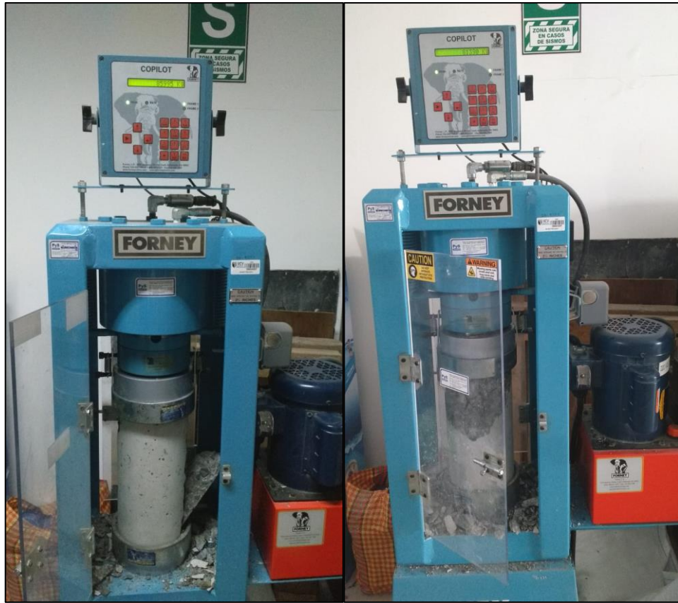
Figura 56: Muestra de resultados - Ensayo de compresión 28 días - 1.0% Nano-sílice)
