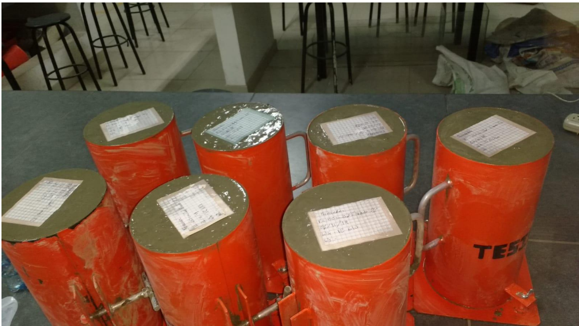
Figura 31: Muestras para ensayo de Peso unitario del concreto mediante moldes normalizados
