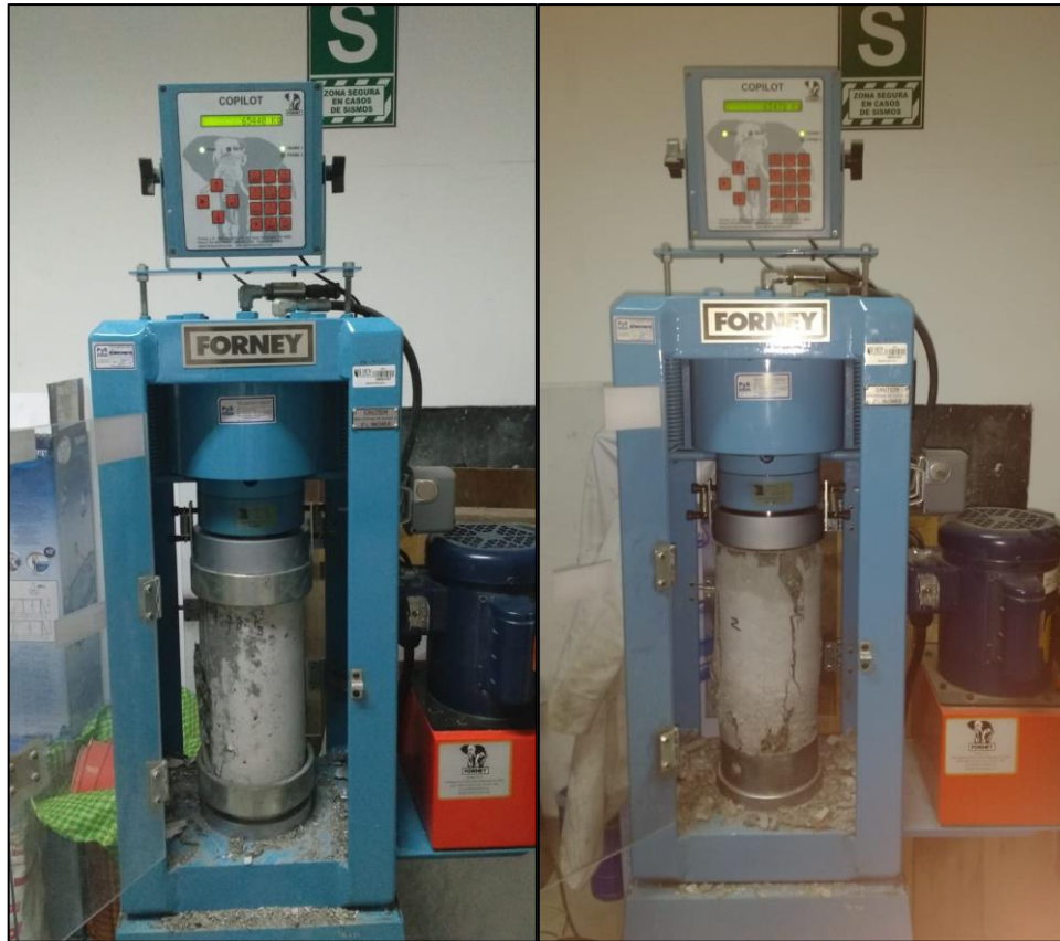
Figura 66: Muestra de resultados - Ensayo de compresión (7 días - 2.0% Nano-sílíce)
