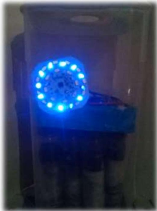
Test visual de diodos led's azules (sin resistencias)
