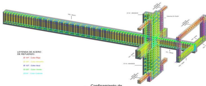
4 Confinamiento de Parapeto-Eje B-B
