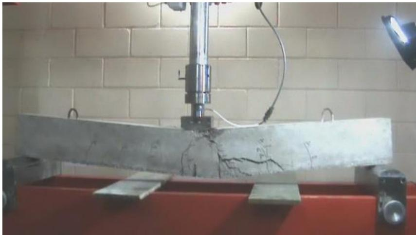
*Figura 10.* Configuración de ensayos a flexión.
