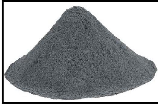
Figura 6. Microsílice despues de ser recogida del horno.
