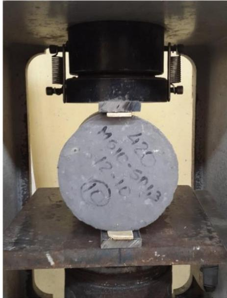
*Figura 14.* Rotura de la probeta a tracción.
