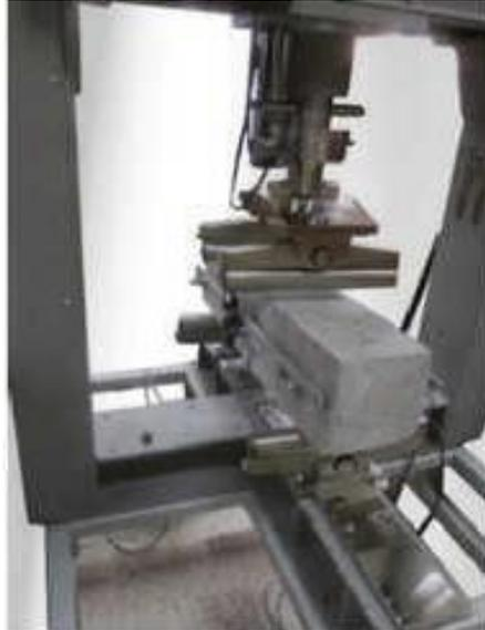
*Figura 15. Rotura de la probeta a flexión*
