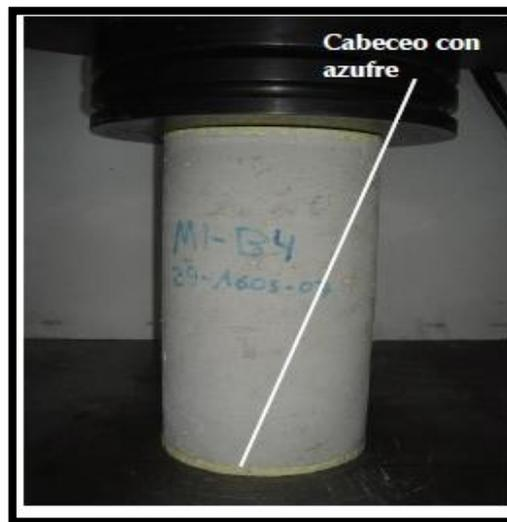
*Figura 8. Configuración de ensayos en compresión.*
