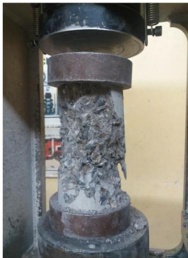
*Figura 13. Rotura de la probeta a compresión.*
