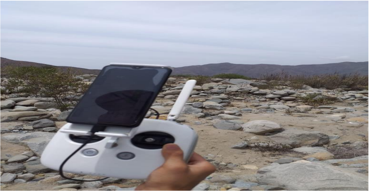
Fotografía 3: Se observa el control y celular con aplicativo para el levantamiento topográfico. Fuente: Elaboración propia.
