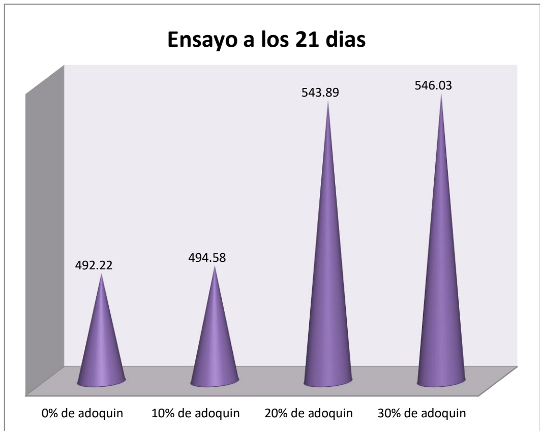
Figura 28: Resistencia a la compresión promedio a los 21 días de edad vs Porcentaje de estopa de coco reciclado
