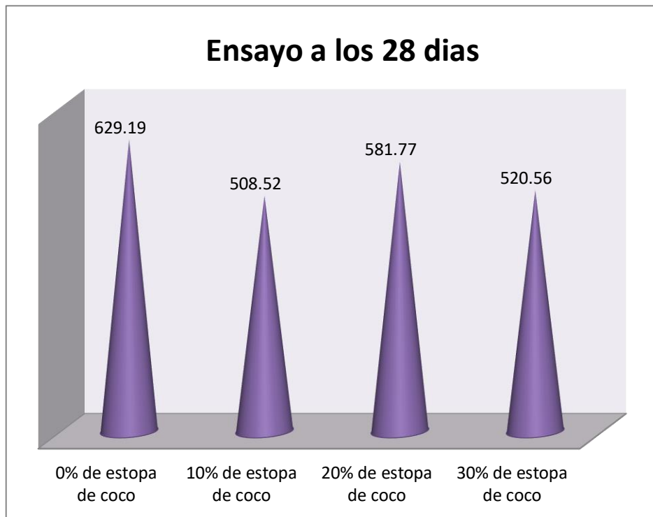
Figura 29: Resistencia a la compresión promedio a los 28 días de edad vs porcentaje de estopa de coco reciclado
