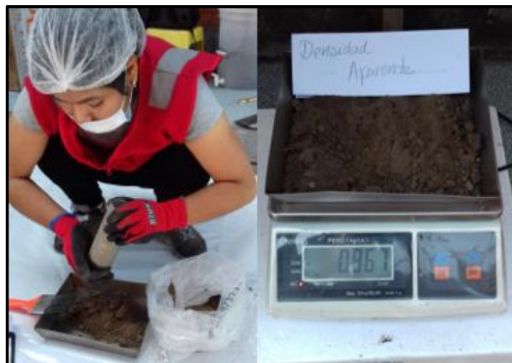
Figura 30. Extracción de muestra de suelo agrícola del cilindro biselado
