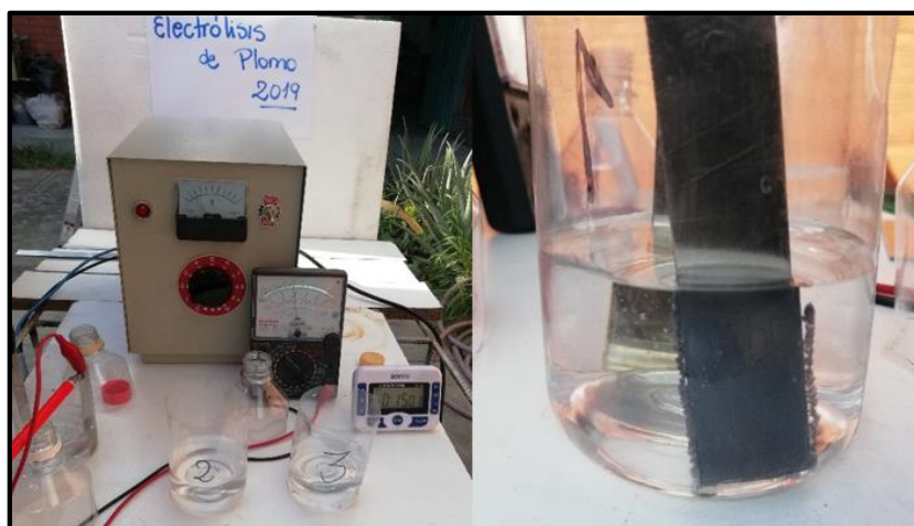
Figura 35. Remoción de Plomo por Electrólisis
