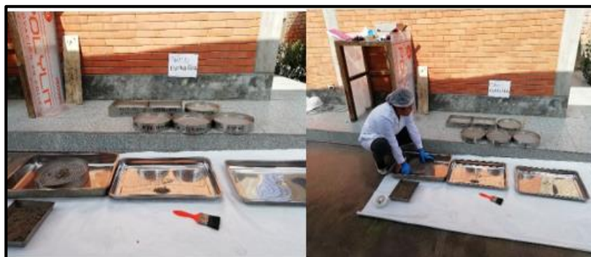
Figura 33. Procedimiento de tamizado con malla N° 100
