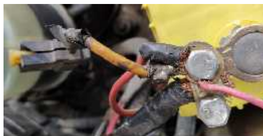
Figura 31 cables y porta fusibles en mal estado (ELABORACIÓN PROPIA)
