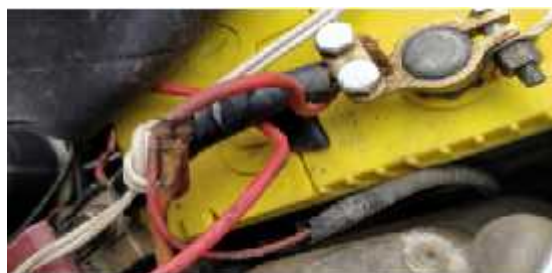
Figura 32 empalmes expuestos y mal conectados (ELABORACION PROPIA)
