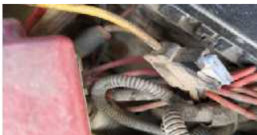
Figura 31 cables y porta fusibles en mal estado (ELABORACIÓN PROPIA)
