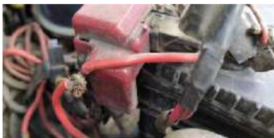
Figura 32 empalmes expuestos y mal conectados (ELABORACION PROPIA)
