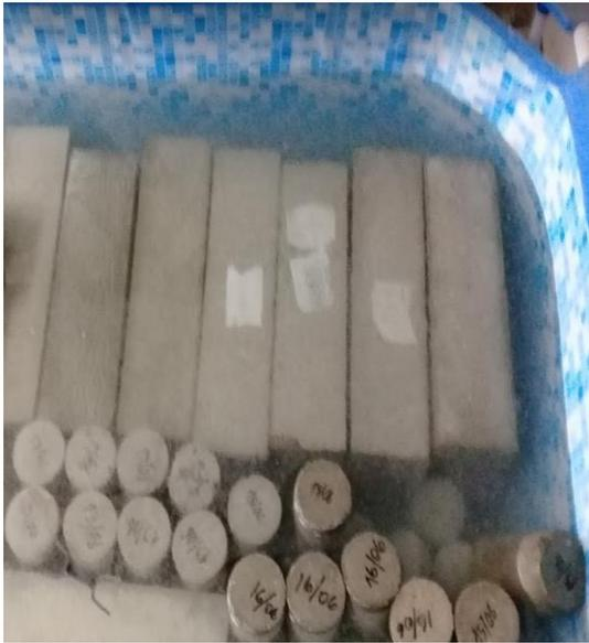
Foto 9. Ensayo a Compresión 7 días
