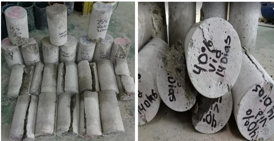
Foto 13. Rotura a tracción y flexión 28 días
